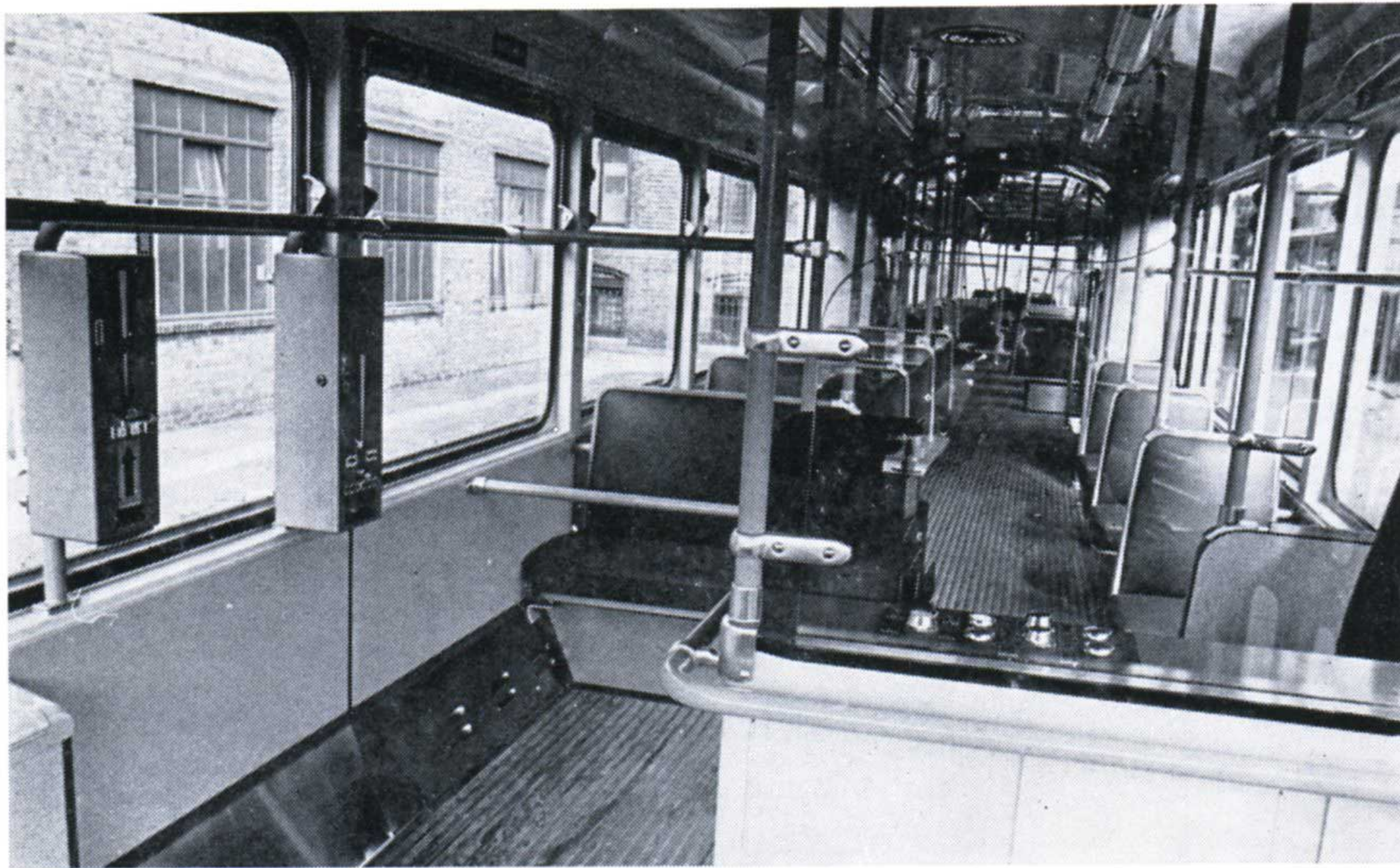
fig. 28 - oblitérateur de carte (à gauche) et distributeur de billets de transit (à droite) de la plate-forme arrière
