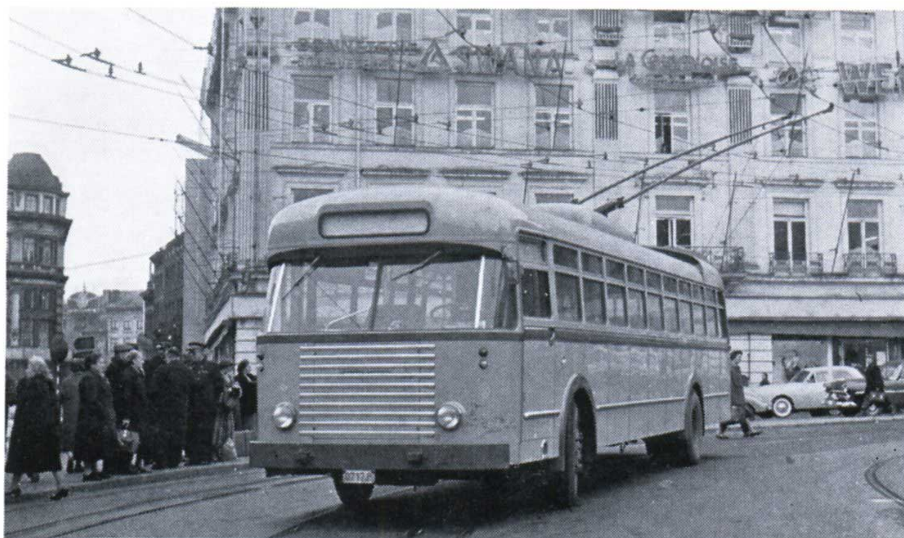
Autobus standard de la S.N.C.V. équipé en trolleybus, pour essai de conversion, en 1958-59. Vue prise à Liège, place St-Lambert sur la ligne 12 (cliché « Der Stadtverkehr »)
