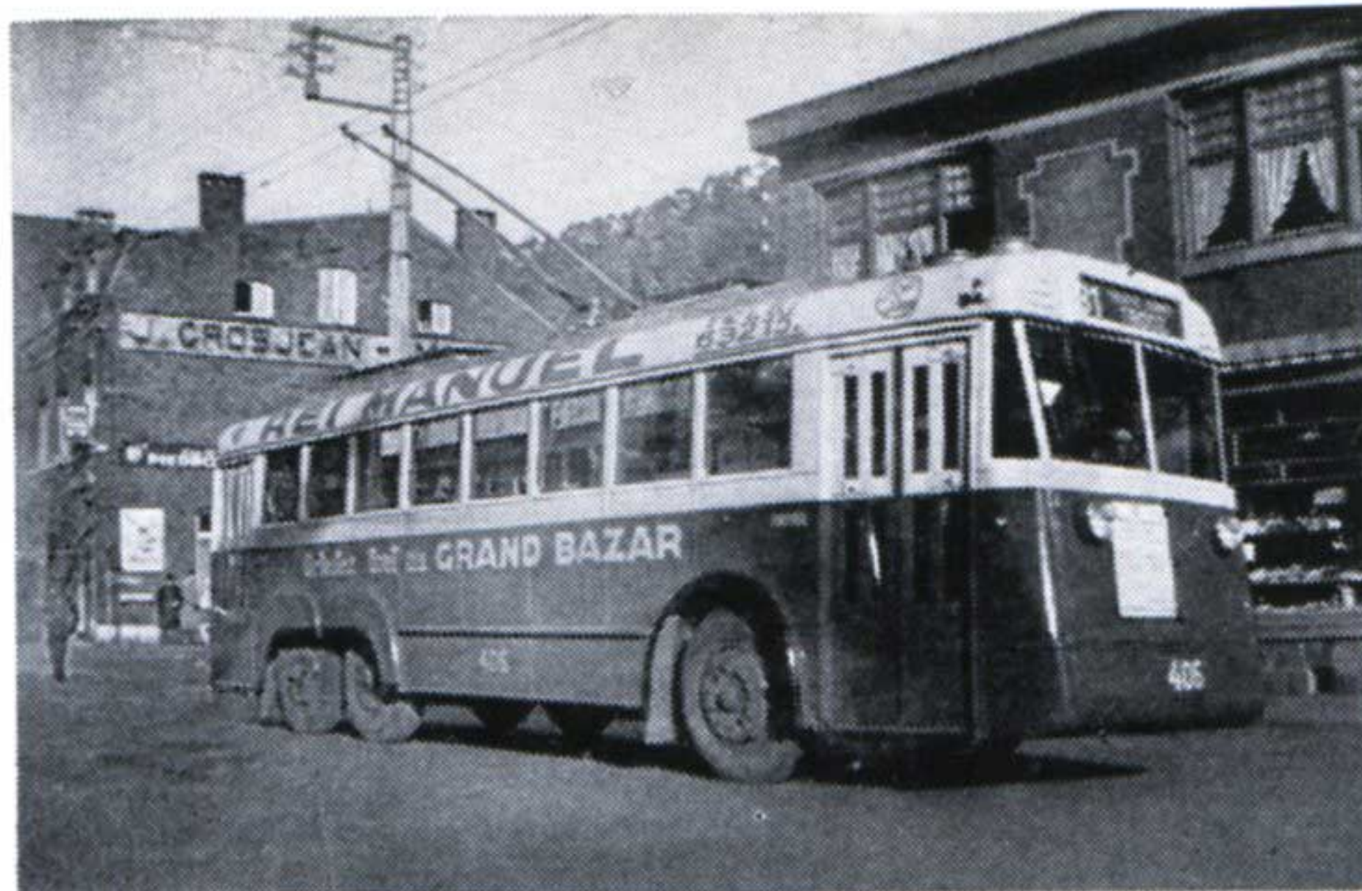
A gauche : trolleybus de Liège (TULE) n° 403 de la série 401-405, vue prise après refonte dans les ateliers de la Compagnie en 1944/45 — au centre : trolleybus 406 (trois essieux, construit chez Ransomes en 1931) après refonte en 1949 — à droite, trolleybus 499 (TULE) série 495-500 (Brossel - D'Heure - CEB) ; de cette série, les voitures 495-497 ont été utilisées en Allemagne pendant la Seconde Guerre Mondiale et démolies en 1945, dès leur retour (clichés « Der Stadtverkehr »)
