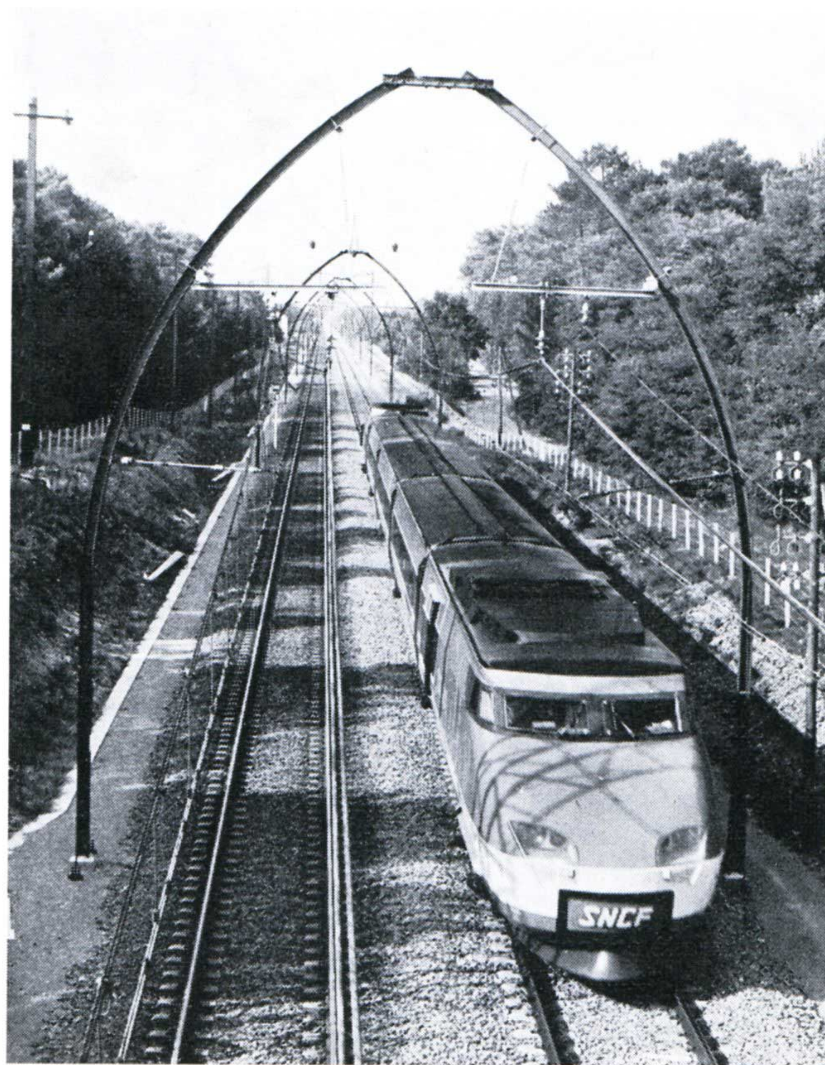
Le turbotrain TGV 001 en cours d'essai sur la ligne de Bordeaux à Hendaye (photo S.N.C.F.)
