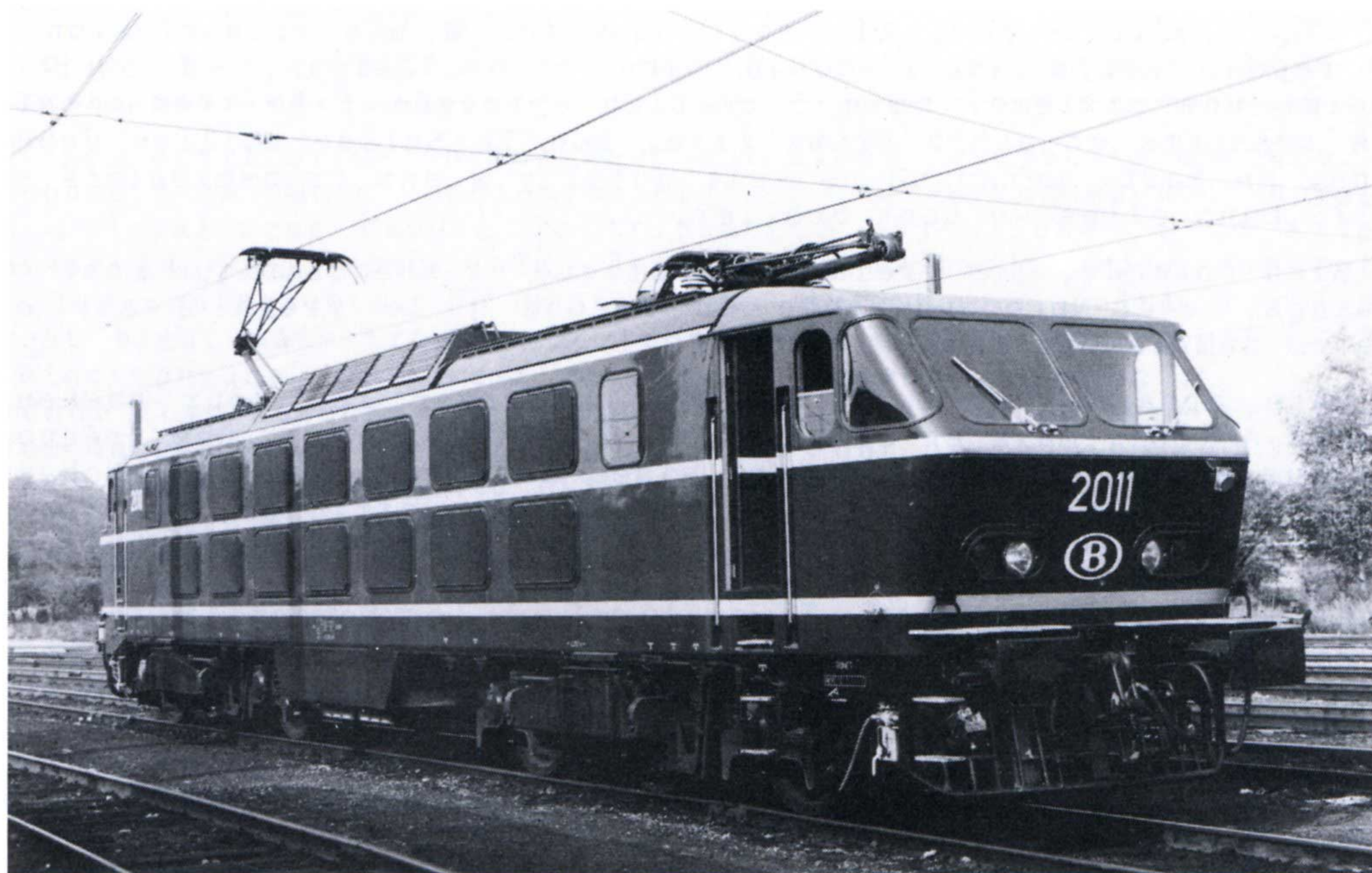
Dix ans après son apparition sur le réseau, la locomotive série 20 reste la plus puissante des machines électriques : six moteurs, chacun d'une puissance continue de 855 kW. D'une masse totale de 110 t, elle peut s'inscrire dans des courbes de 100 m de rayon. (Photo G. Bricman)
