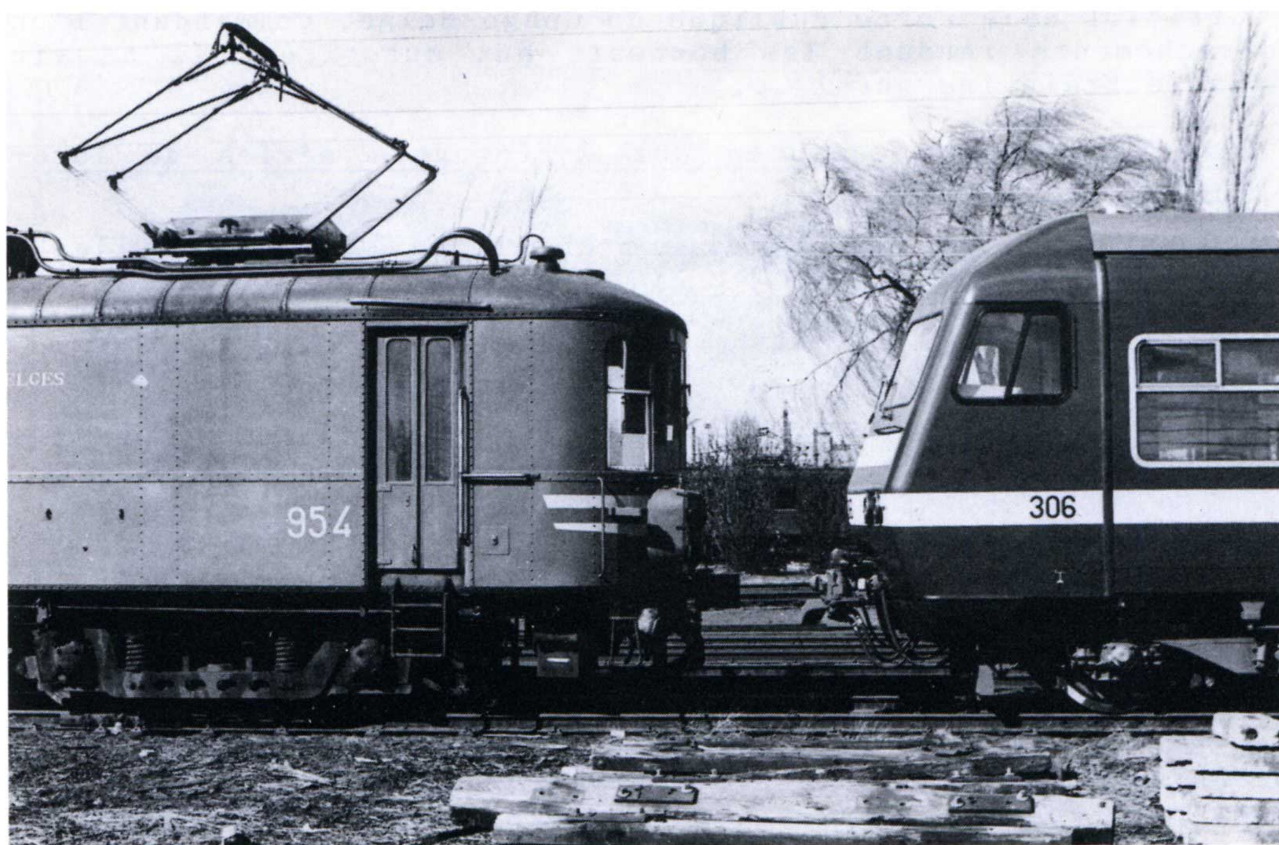
Style, gabarit, attelage, pantographe, bogie, équipement électrique, ... : tout distingue ces deux générations d'automotrices électriques, dorénavant incompatibles. (Photo G. Bricman)
