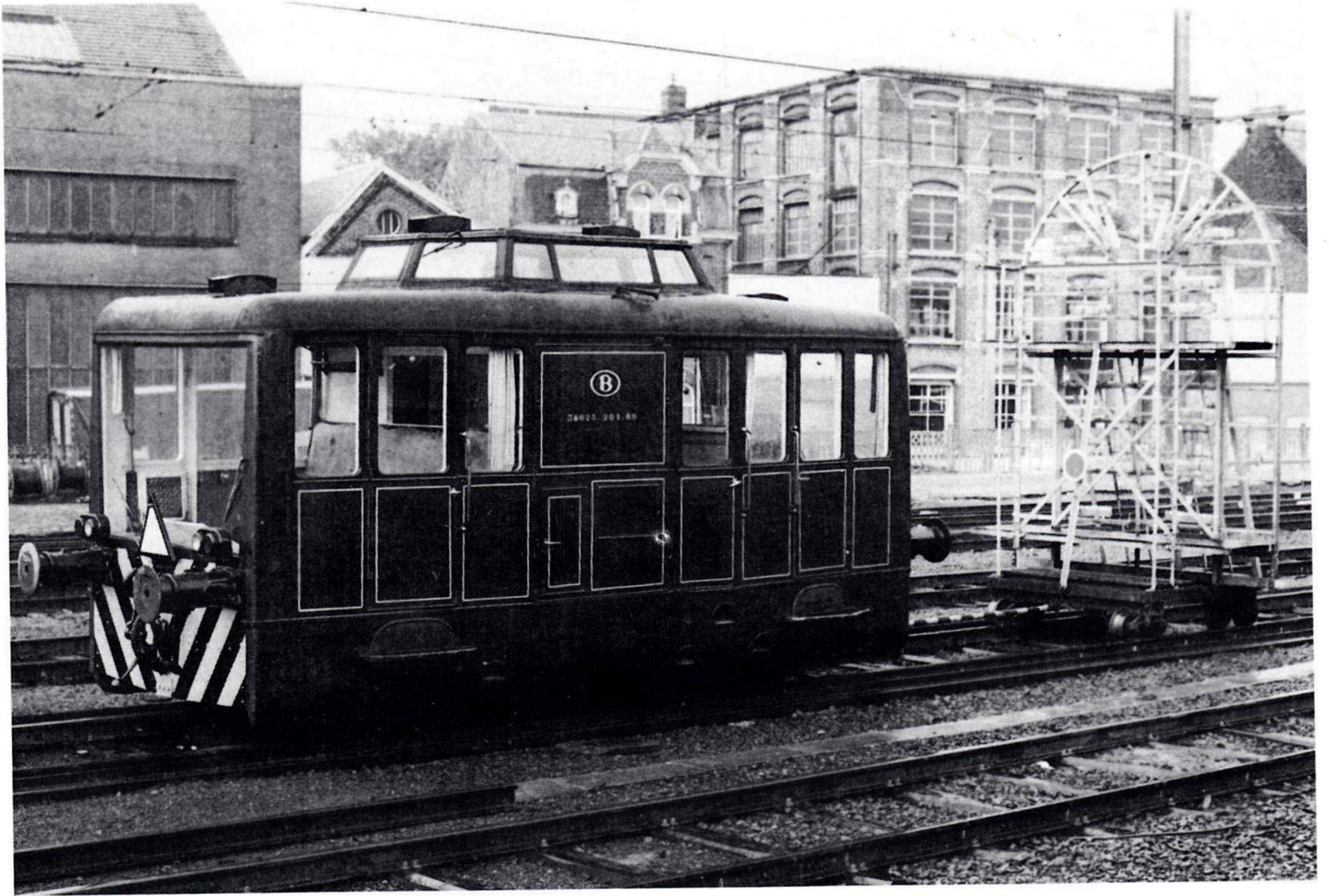
Ancienne "draisine d'inspection de la Direction" (type 1), reconvertie en tracteur ; l'engin remorqué est un gabarit de contrôle, monté sur lorries.
