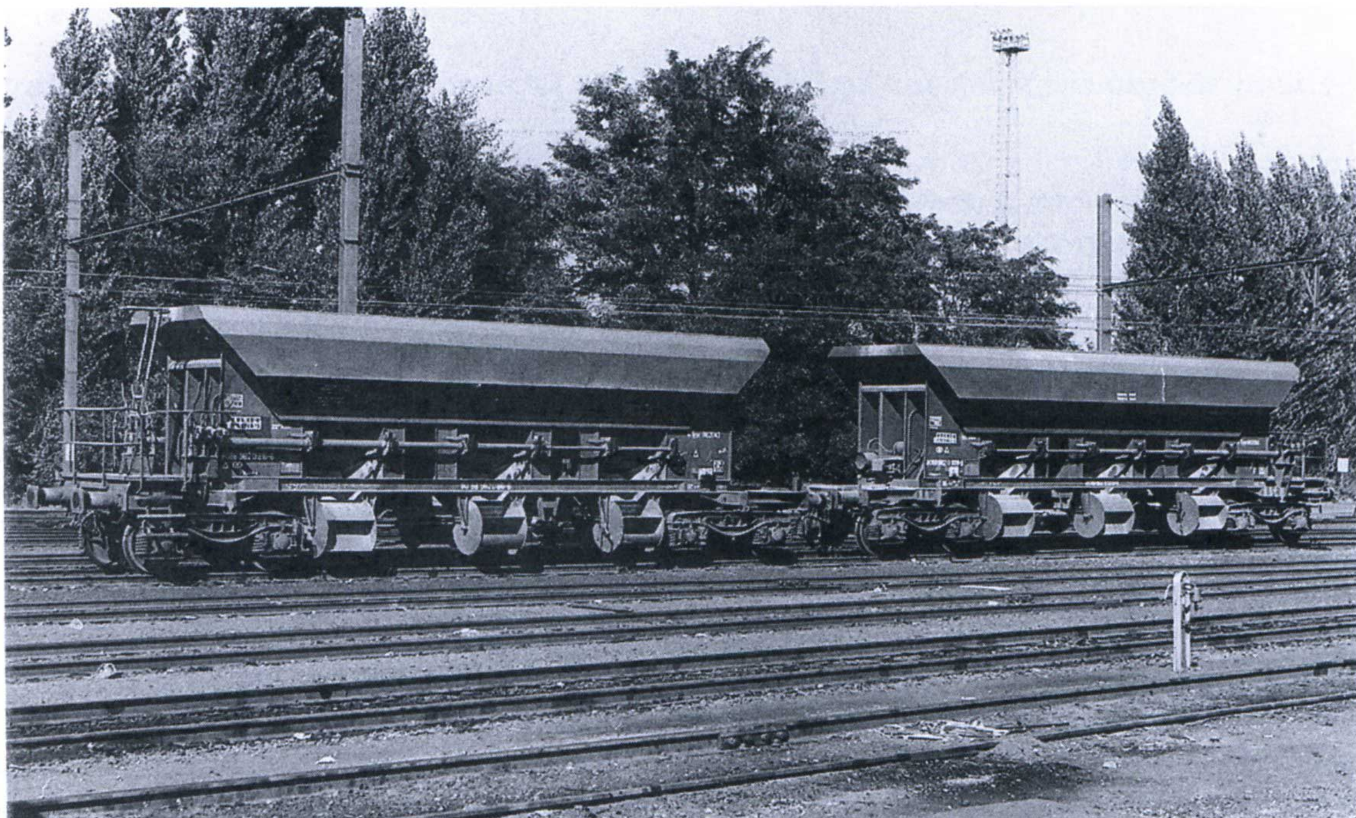
Wagons-trémies à bogies, pour le transport de ballast (Types 9820A3 et 9820A4).
