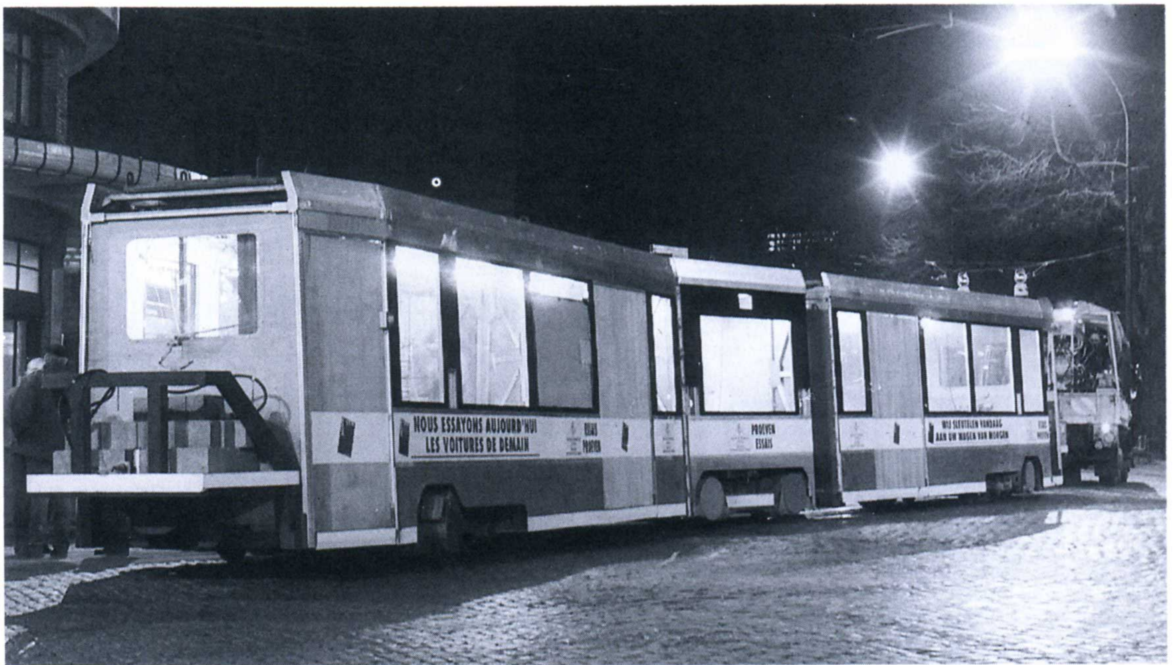
Entre le 16 février et le 15 mars 1993, un "chaudron" de "Tram 2000" a réalisé des essais nocturnes en différents endroits de Bruxelles ; ci-dessus, tentatives de remise sur voie, après déraillement volontaire à la place Eugène Flagey (à noter, dans la future cabine de conduite, la barrière destinée à protéger le conducteur en cas de collision frontale).
