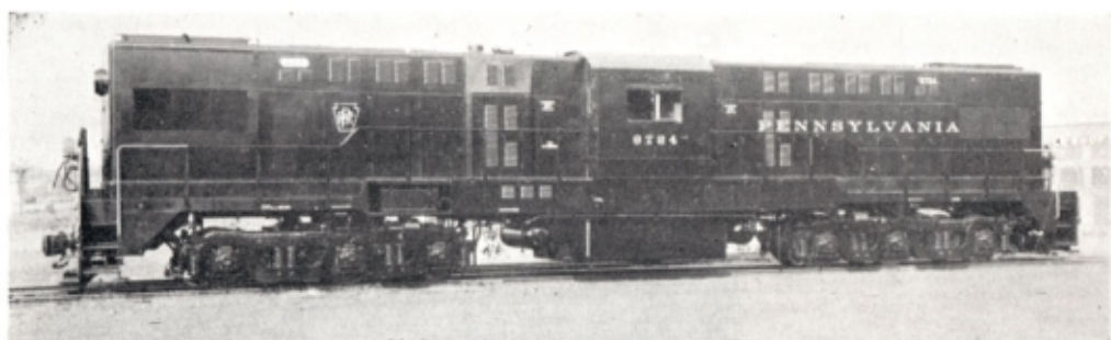
Transfer-switcher de 2400 CV, du PENNSYLVANIA type RT624 de BLH.
