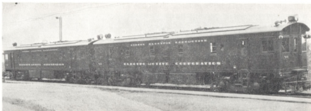
Les deux premières locomotives de ligne d'EMD à leur sortie des usines d'Erie de la GENERAL ELECTRIC. 2 moteurs de 900 CV. par unité. (Photo EMD-GM.)
