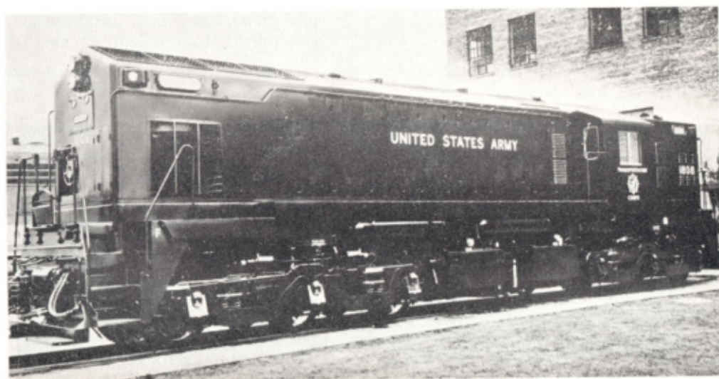
La nouvelle locomotive standard de l'Armée Américaine : Road-switcher type MRS-1 d'EMD.
