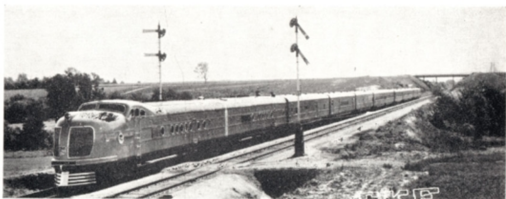
Un des premiers Streamliners de l'UNION PACIFIC, 2 unités EMD de 1200 CV. (1936). Les caisses articulées ont déjà disparu, mais la locomotive conserve encore une personnalité. (Photo SKF.)
