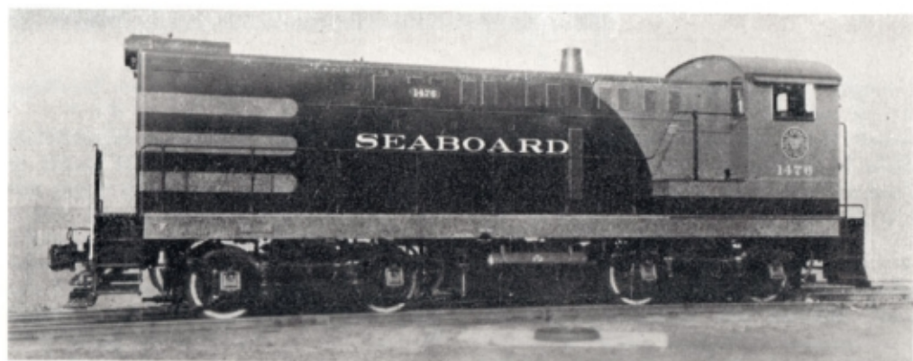
Une locomotive de manœuvre pure : switcher BLH de 1200 CV.
