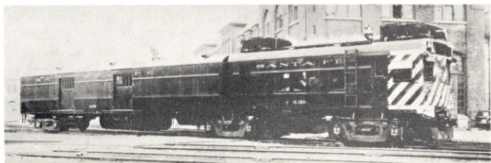
... et son aboutissement, le fourgon automoteur à pétrole lampant WINTON de 900 CV., fourni en 1932 au SANTA FE. (Photo EMD-GM.)
