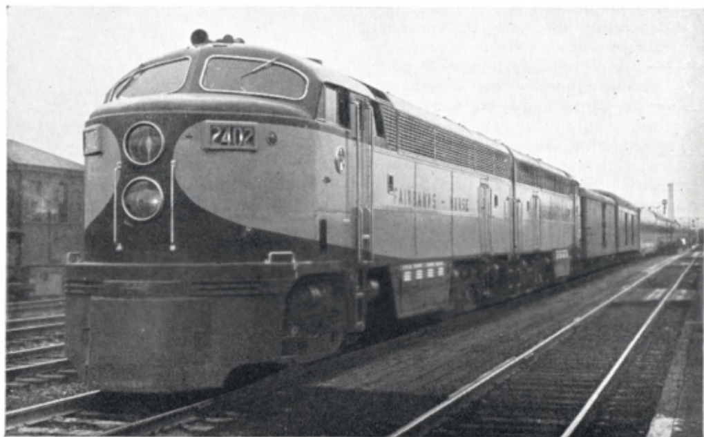
Locomotive diesel-électrique type C de 4800 CV. en essai entre Chicago et Milwaukee.
