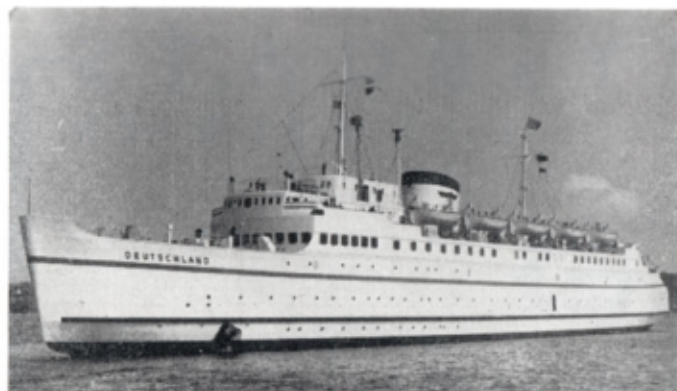
Le ferry-boat « Deutschland » ; on remarquera l'emplacement inusité de l'écubier.
