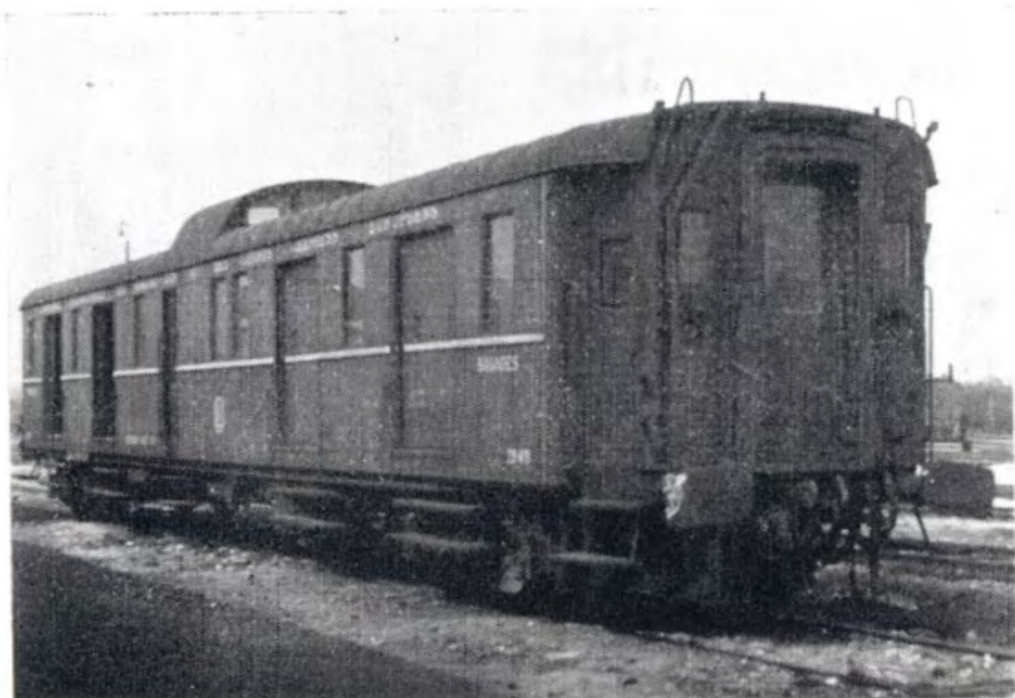
Fourgon métallique à 4 portes et vigie centrale.
