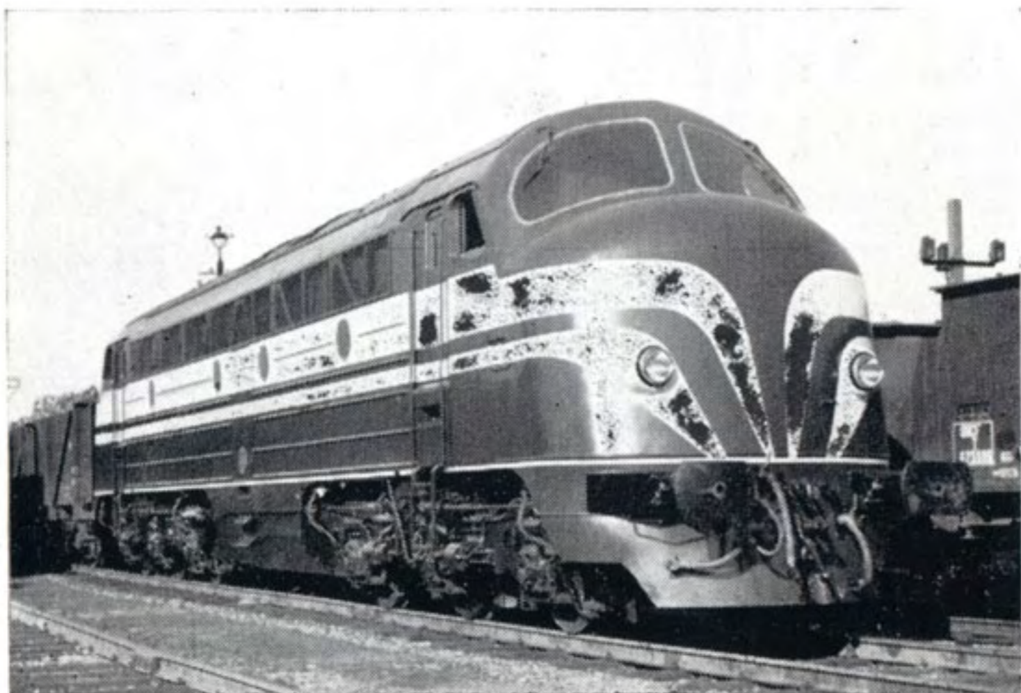
Locomotive CC diesel-électrique type 202 de la S. N. C. B.
