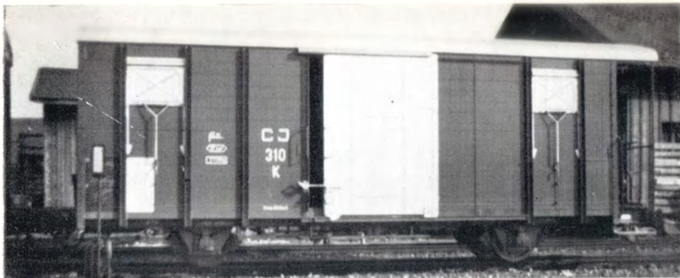
Wagon à marchandises à voie étroite des chemins de fer du Jura.
