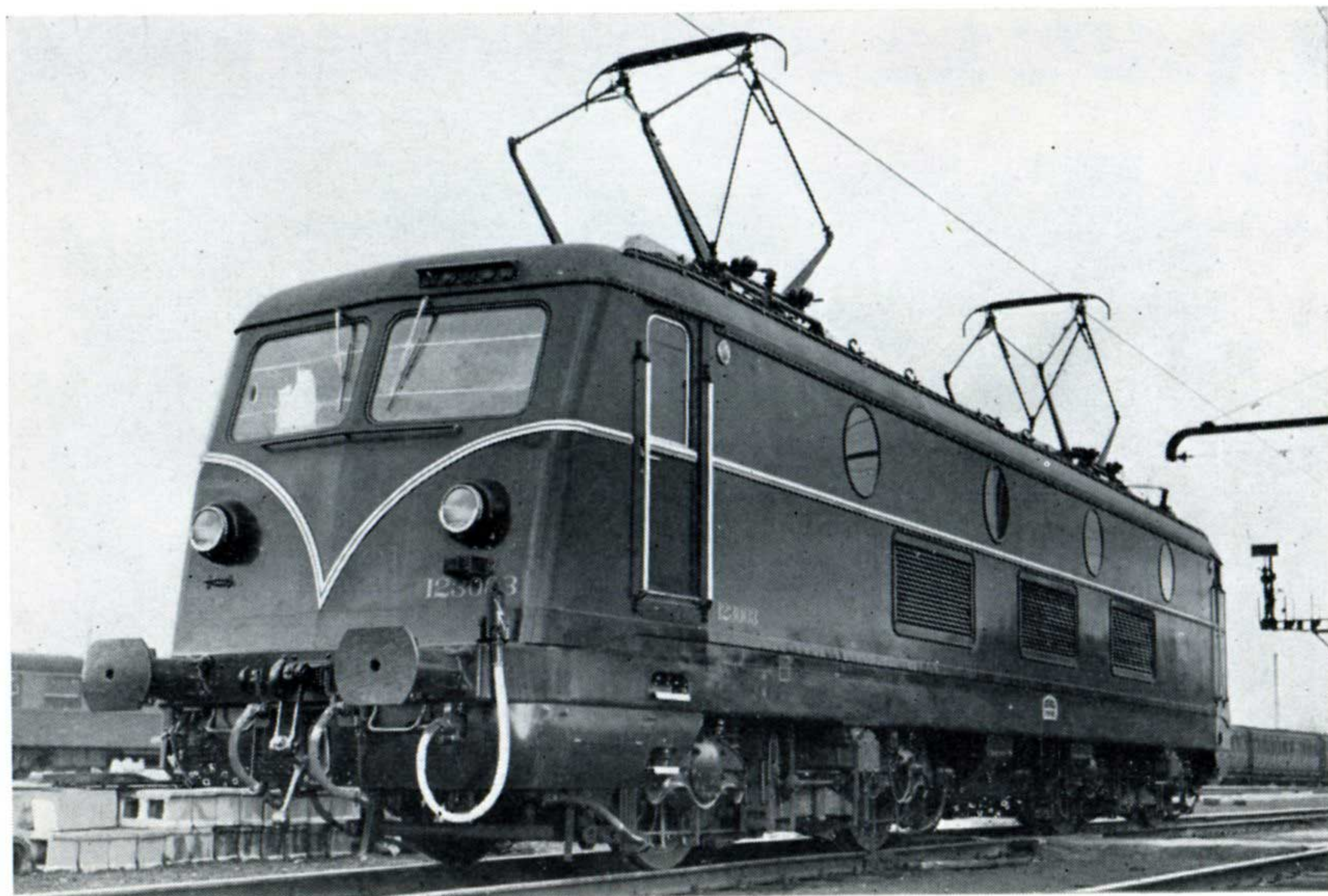
Fig. 16. — Locomotive électrique type 123 de 92 tonnes de poids total, équipée de roulements SKF d'exécution C. (Photo R. Pléinckx)
