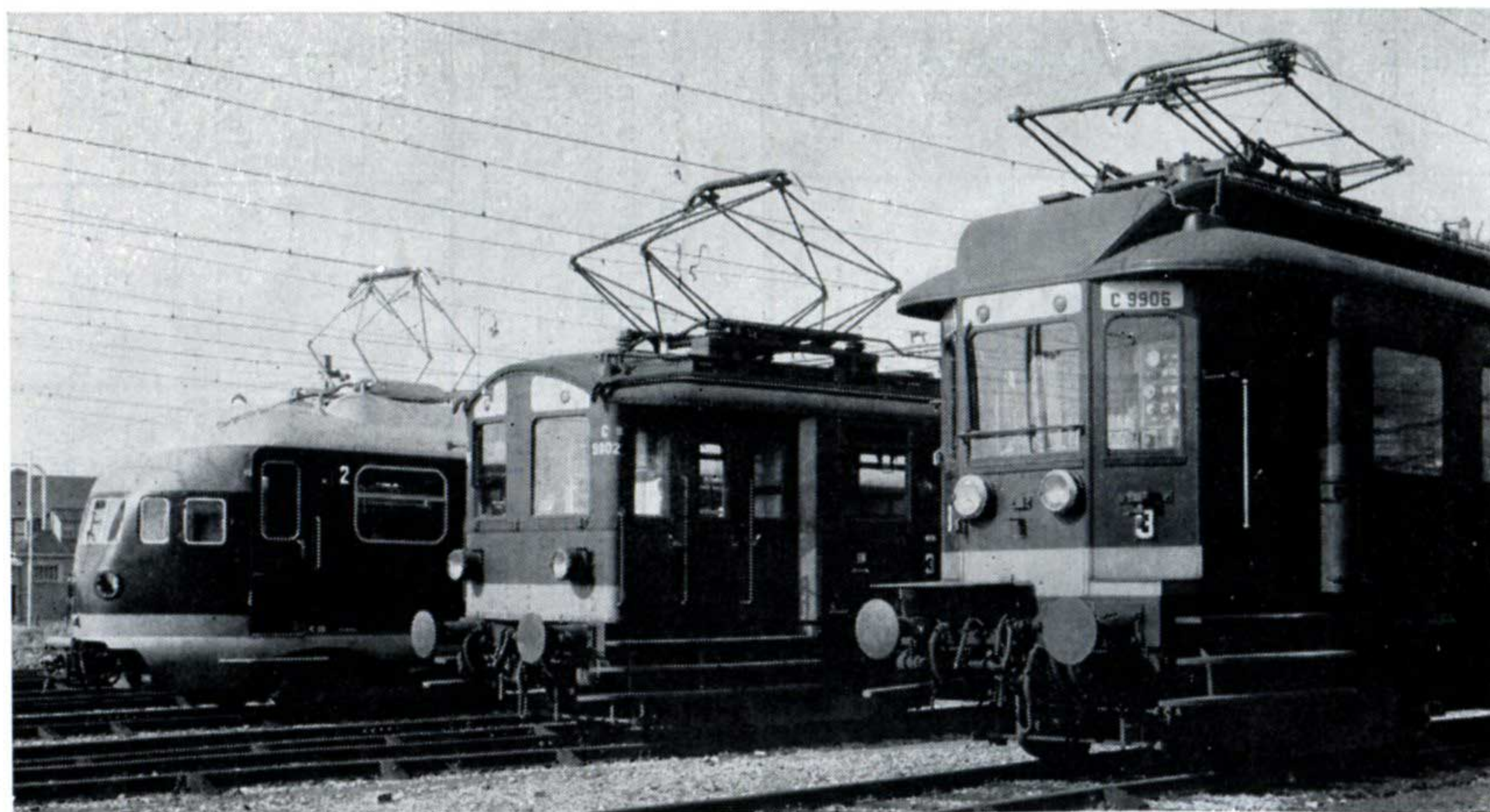
Evolution des rames électriques N. S. — de droite à gauche : rame de 1908, rame de 1924 et rame carénée de 1935. (Photo N. S.)
