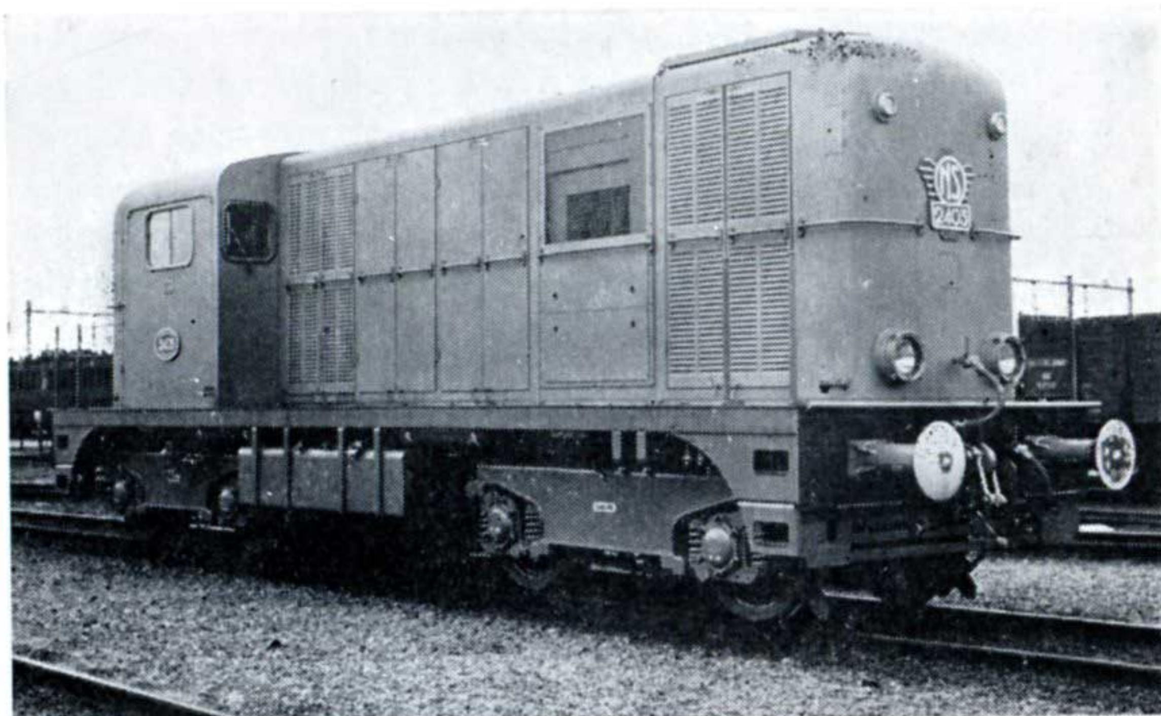
Locomotive de ligne Diesel-électrique de la série 2400 des N.S.
