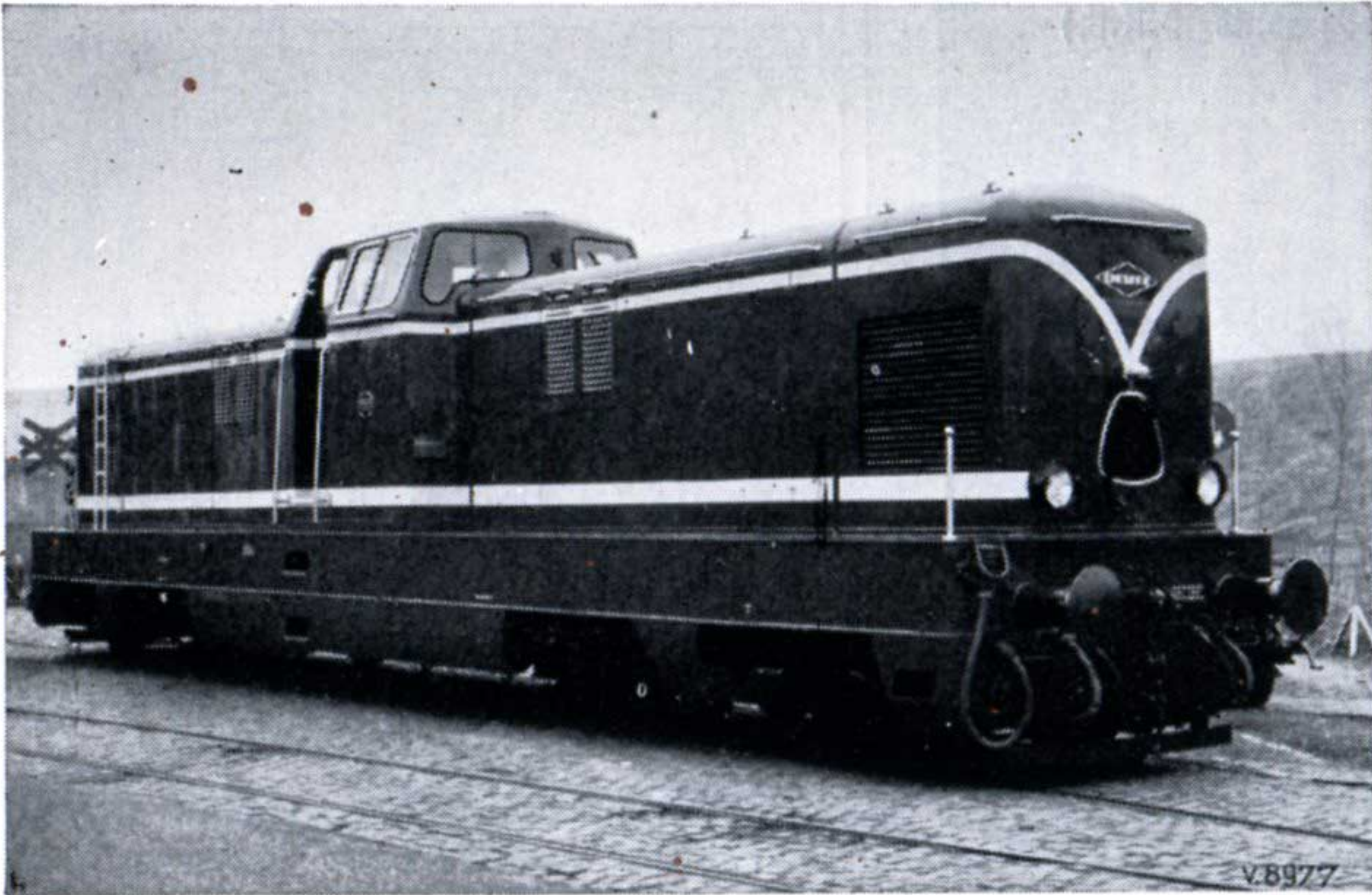
Locomotive Diesel Deutz, 2000 CV, équipée de 2 turbo-transmissions Voith et de 2 groupes de refroidissement Voith
