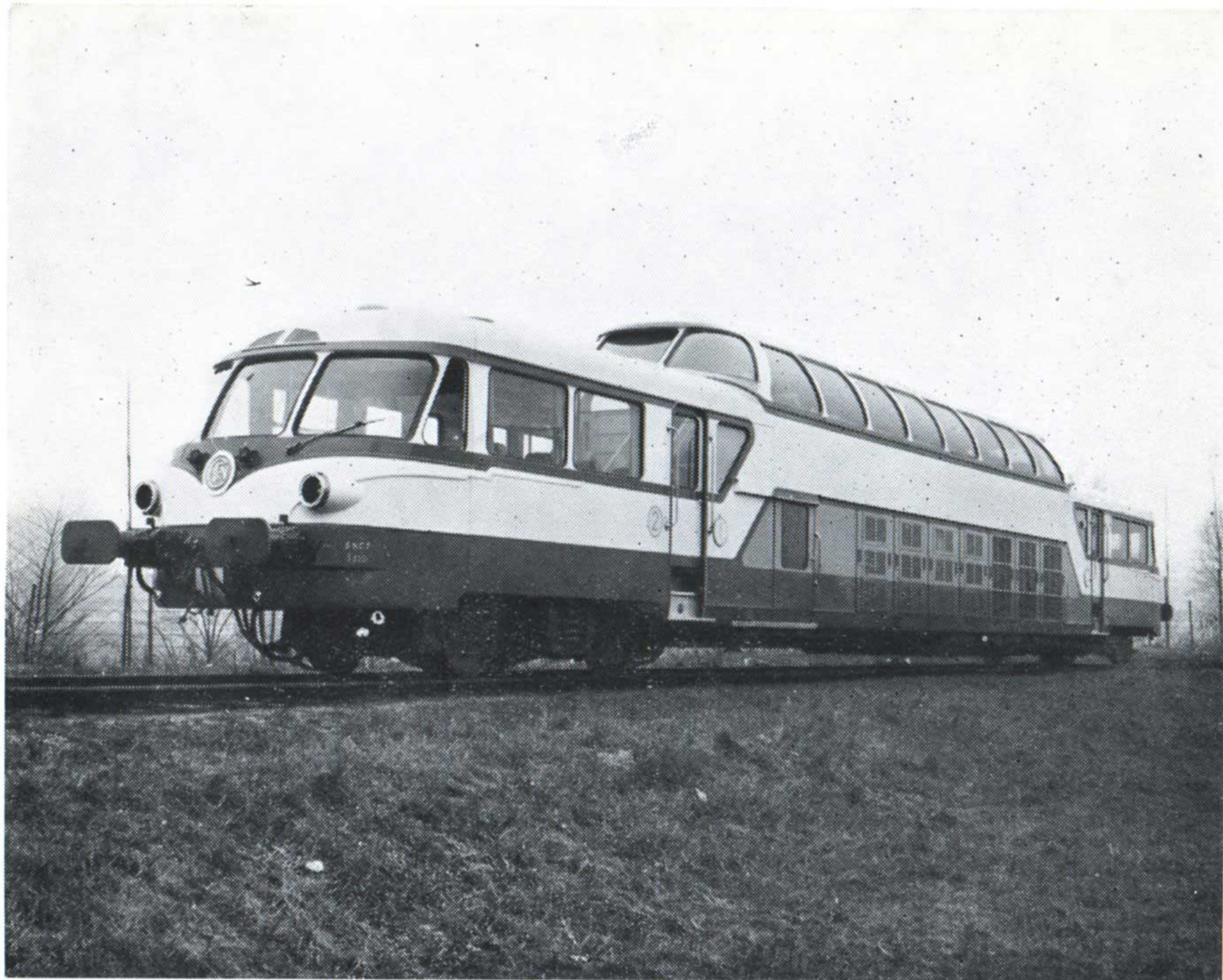
Vue d'ensemble du nouvel autorail panoramique série A 4201 à A 4210 de la S.N.C.F. Vitesse 130 km/h. (Cliché S.N.C.F.)
