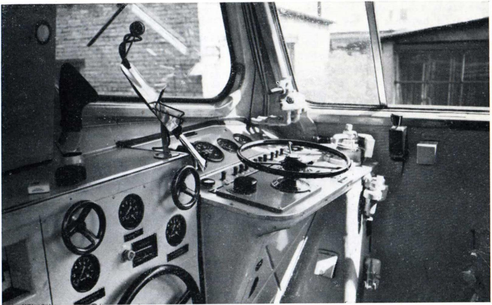
L'un des deux pupitres de commande disposés en quinconce dans le poste de conduite de la locomotive V 100. (Photo B. Dedoncker)
