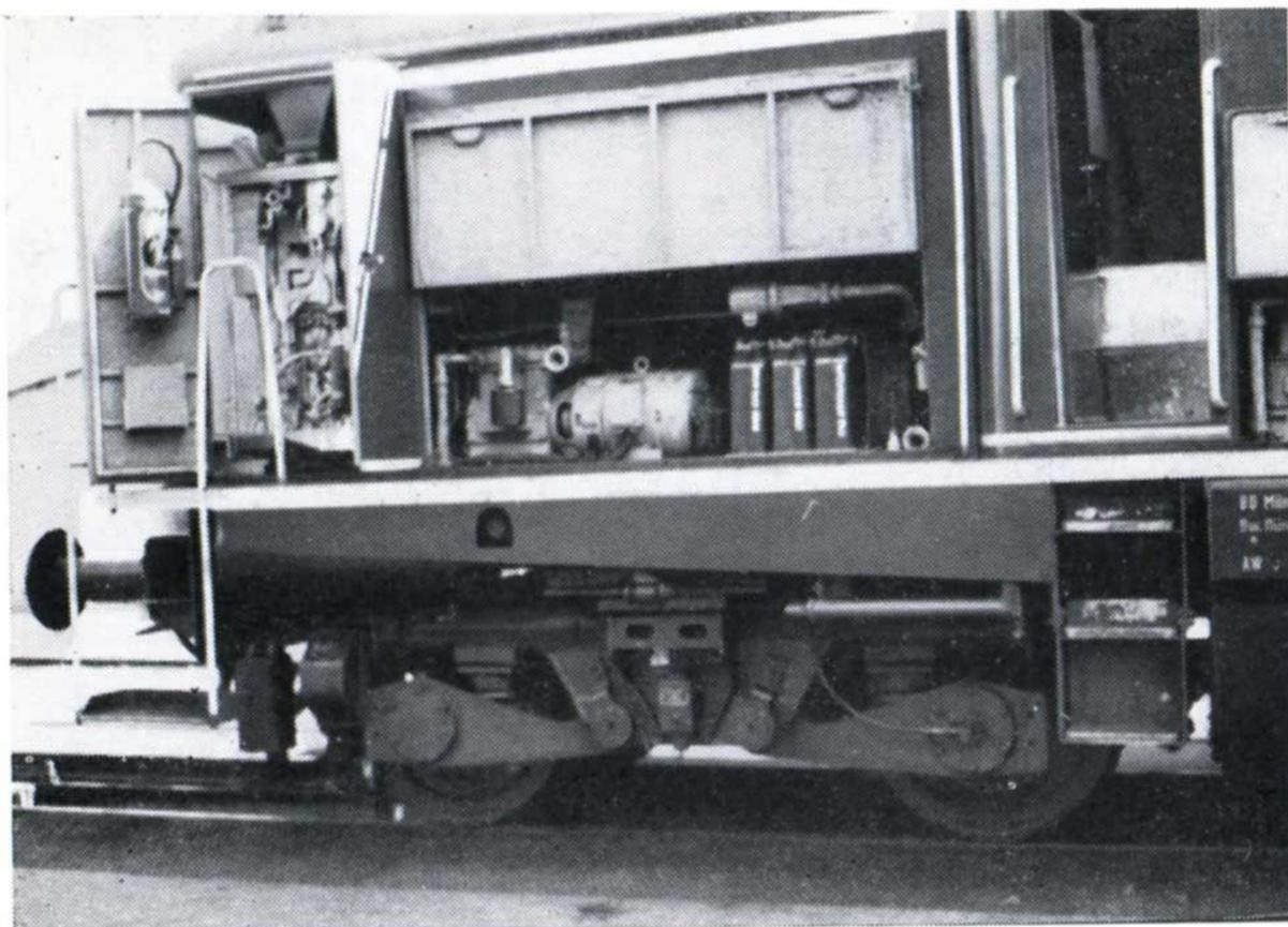
Détail de la locomotive V 100 montrant, de gauche à droite, la chaudière de chauffage du train et un groupe compresseur.
