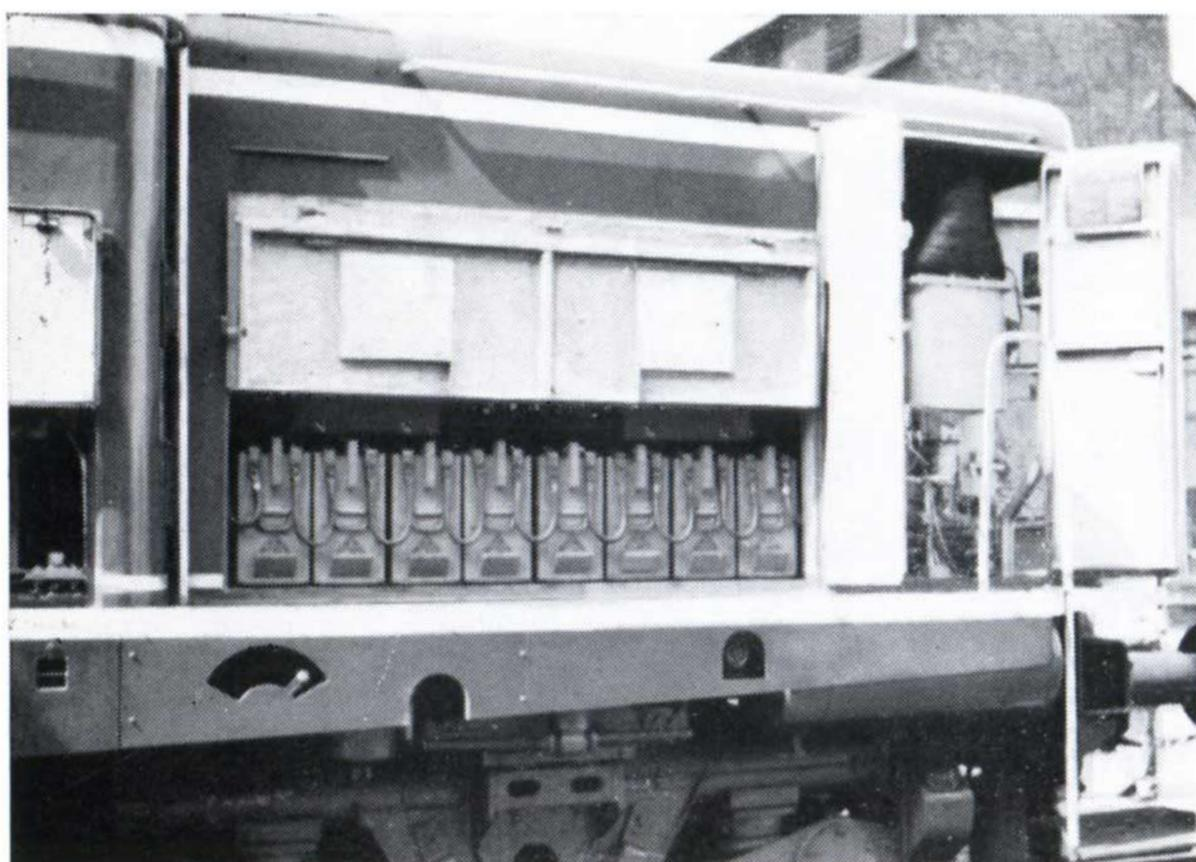
Autre détail de la locomotive V 100 avec la batterie d'accumulateurs.
