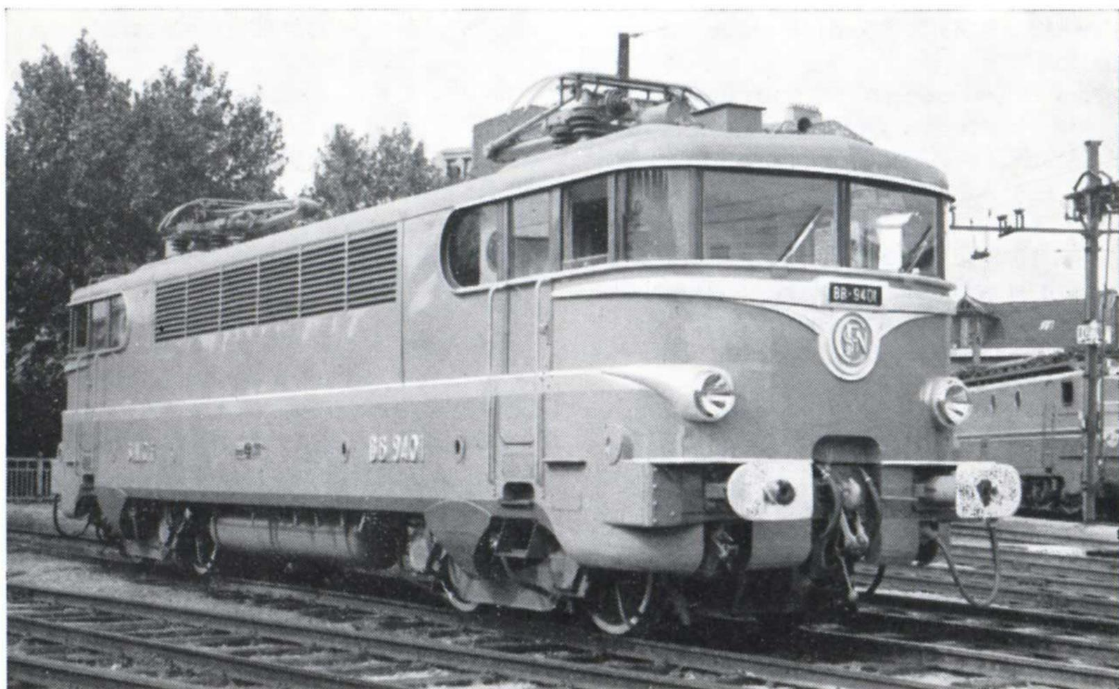
La nouvelle BB 9400 — On remarquera son air de famille avec la BB 16000 pour la caisse et la BB 16500 pour les bogies. (Photo S.N.C.F.)
