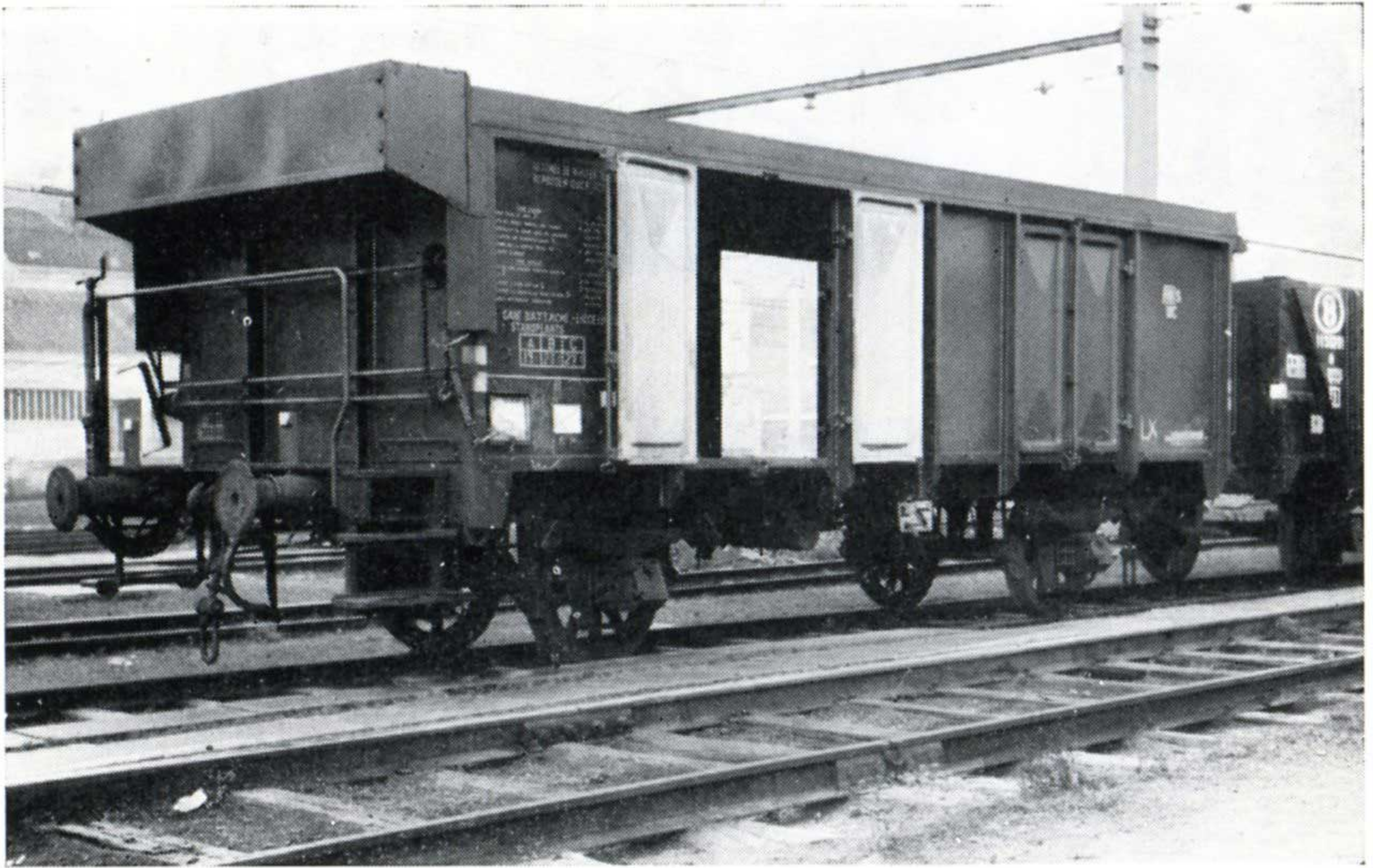
Le nouveau wagon à toiture enroulable.
