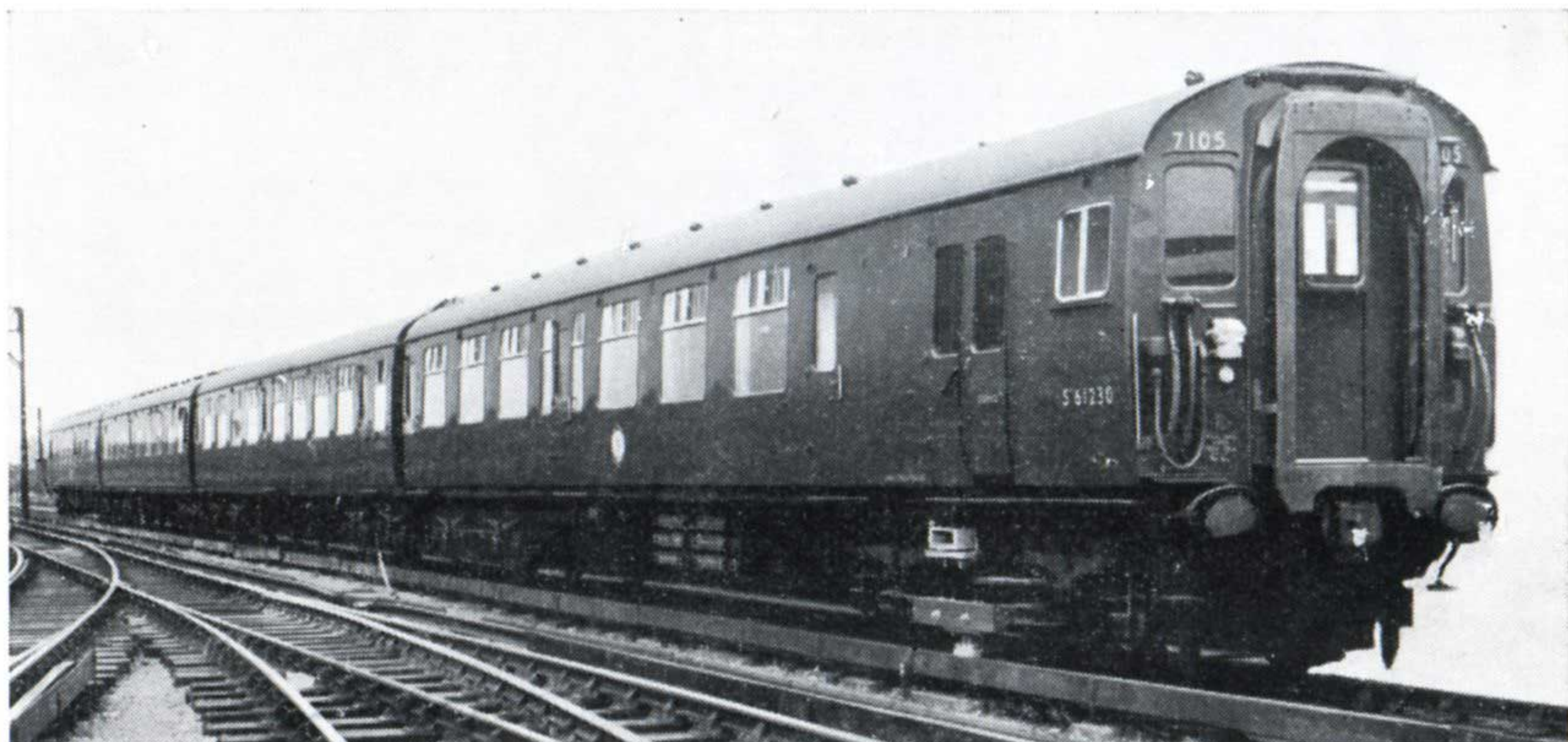
Electrification 750 V de la Southern Region — l'une des 53 rames quadruples (n° 7105) pour services express sur la nouvelle ligne de la Côte du Kent — 224 voyageurs — 116 km/h (Photo British Railways S.R.)
