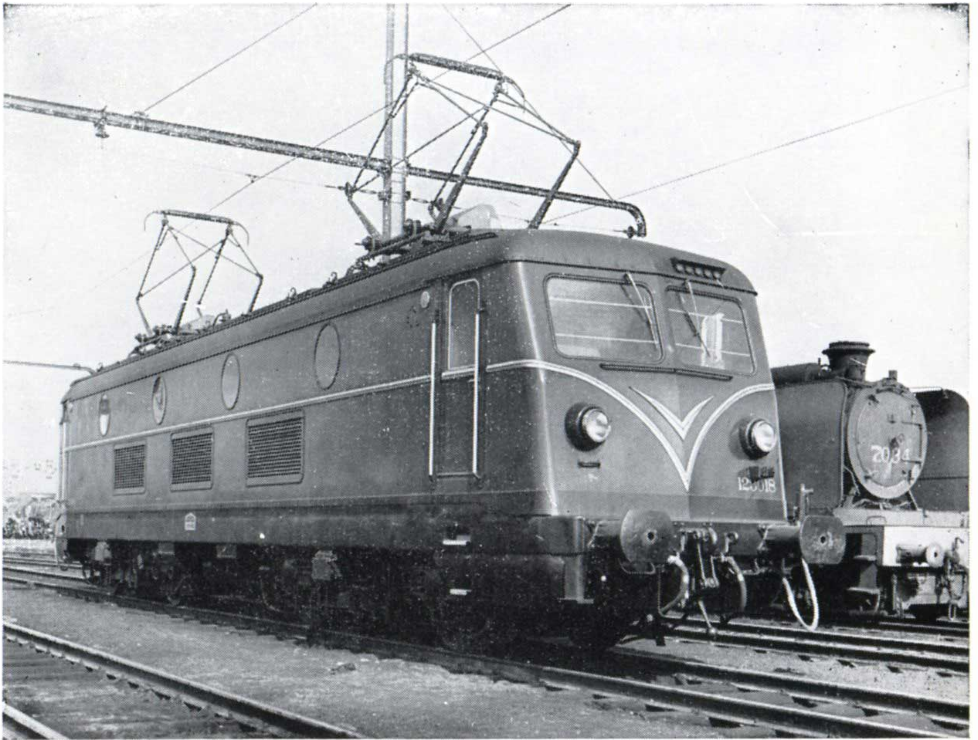
Sœur cadette de la BB 122, la BB 123 est plus lourde et est équipée de la récupération ; comme la BB 122, elle est aussi une réussite de l'industrie belge. (Cliché « Rail & Traction »)
