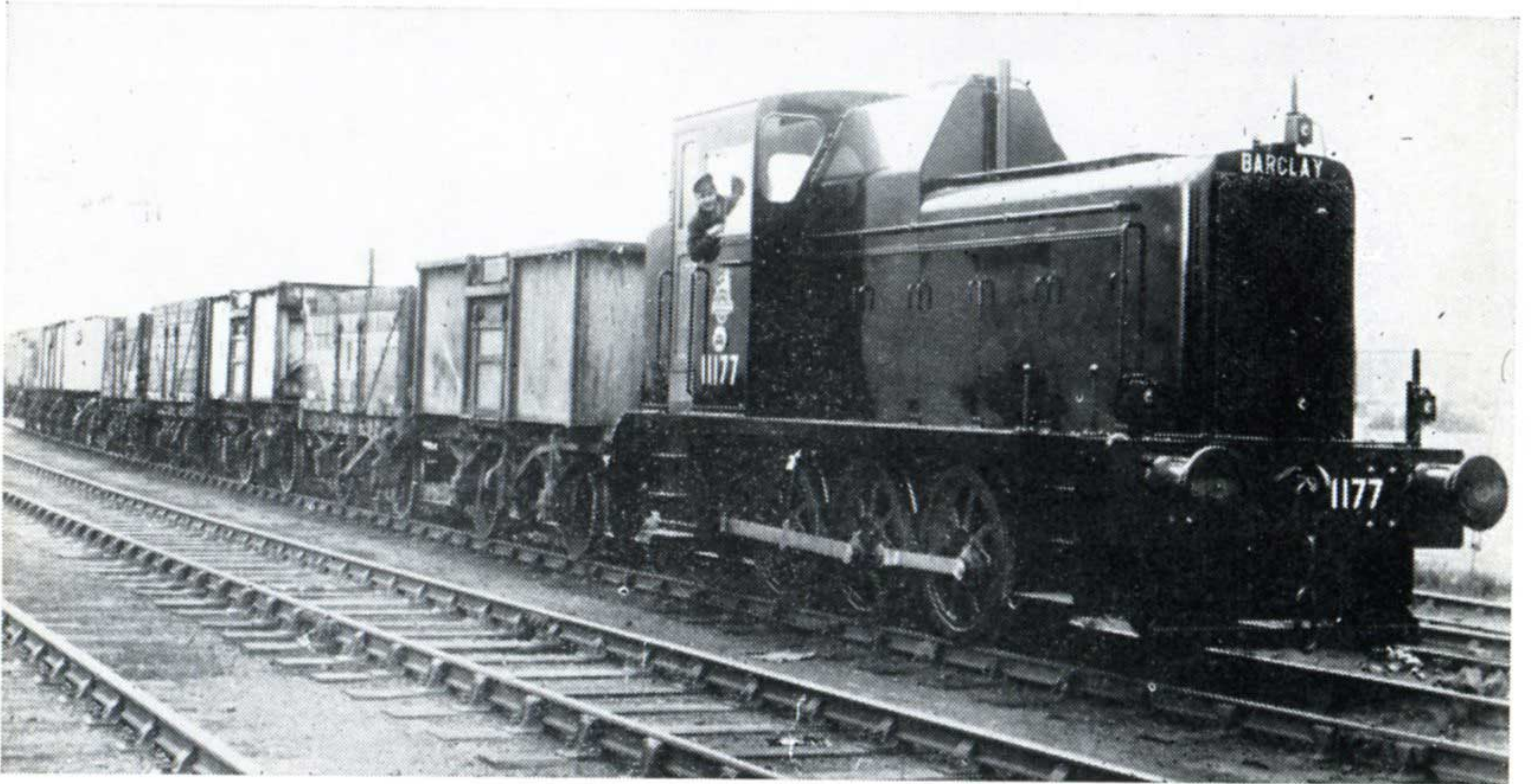
Locomotive Diesel-mécanique de manœuvre de 204 ch., construite par Andrew Barclay — n° 11177, actuellement D 2400 — 32 tonnes. (Photo Andrew Barclay)
