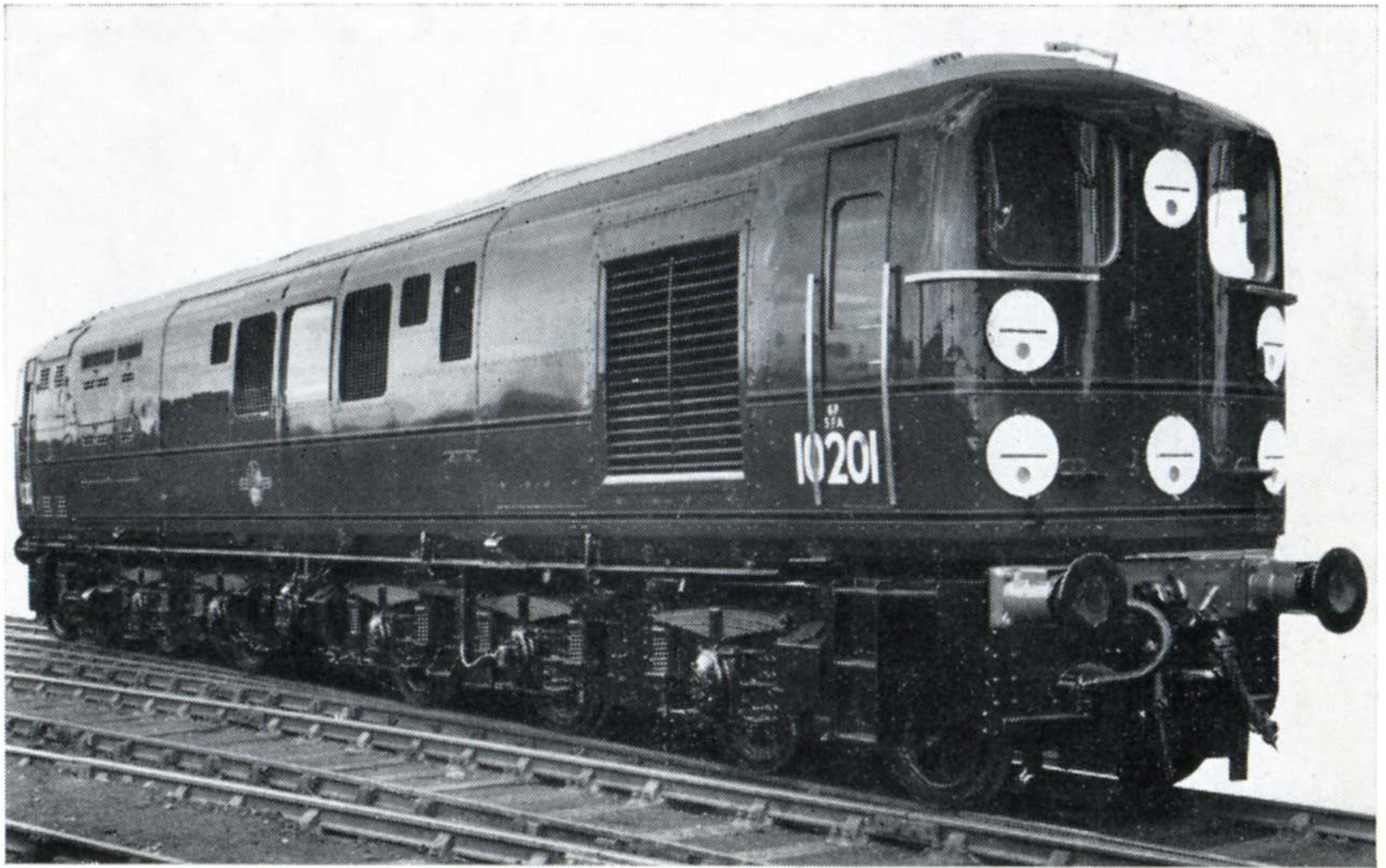
Construite aux Ateliers d'Ashford, la 10201 — et sa similaire, la 10202 — furent les premières 'Co'Co' des British Railways, avec une charge par essieu plus faible que les 'Co'Co' précédentes et de plus amples approvisionnements. (Photo British Railways, S.R.)
