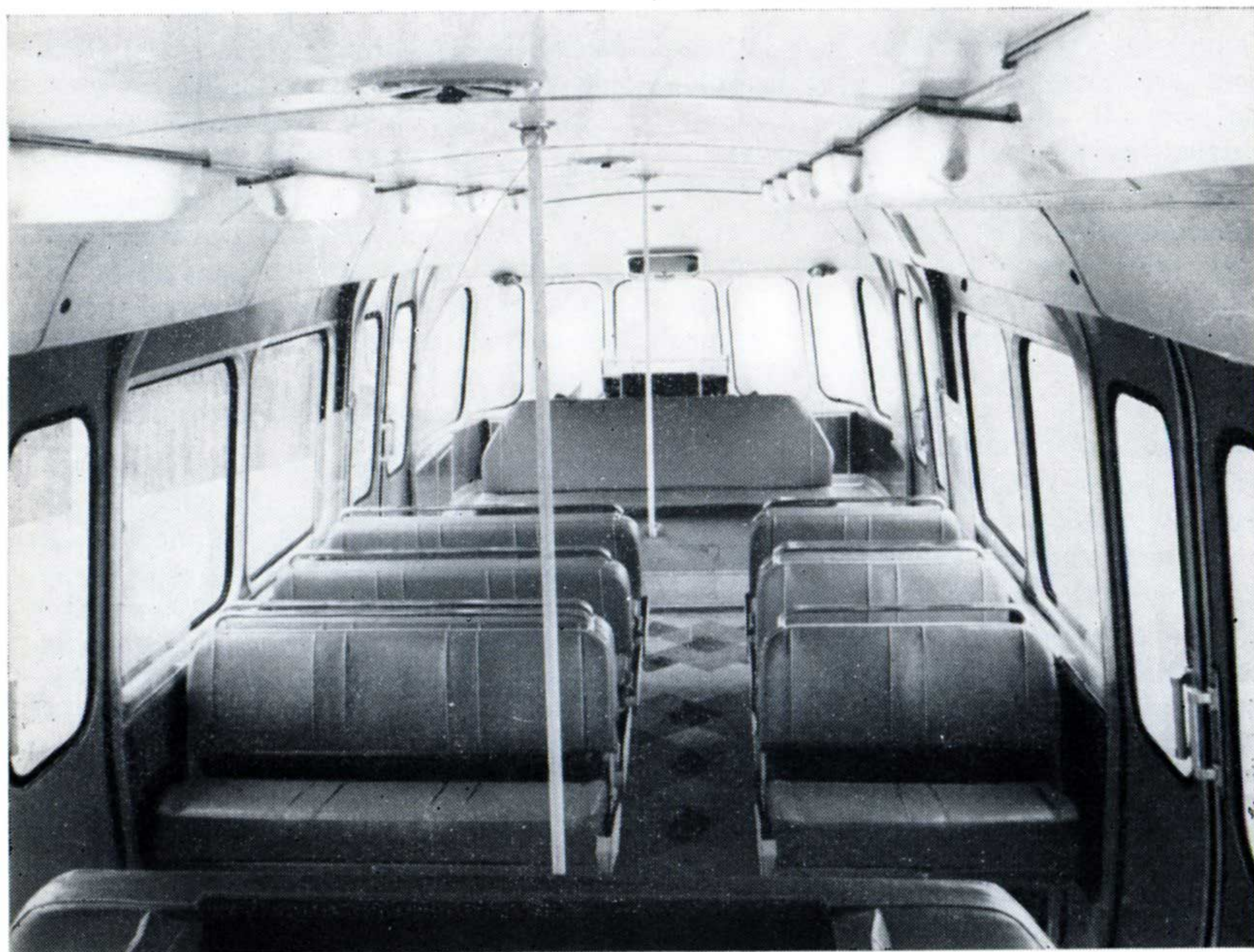
Vue intérieure d'une voiture Alweg ; on remarquera à l'extrême avant-plan, le groupe de sièges couvrant un bloc de roues, l'autre bloc, couvert de la même manière, est visible à l'arrière-plan. (Photo Alweg Corporation)
