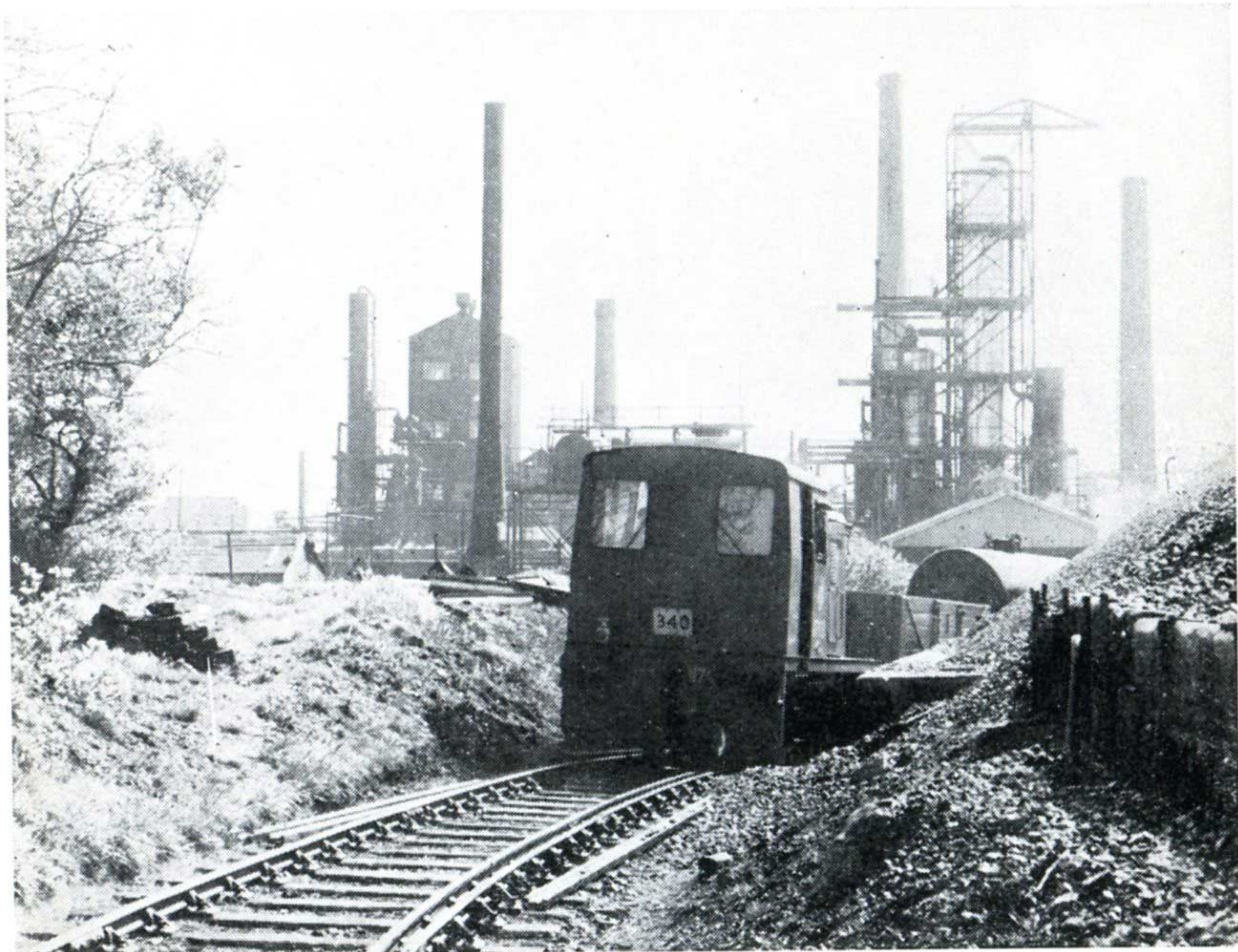
Dans un paysage industriel, voici la locomotive de manœuvre n° 2703 assurant sa tâche quotidienne à Falkirk — 200 ch : 32 tonnes — moteur Paxman — transmission NBL/Voith — partie mécanique NBL (Photo Paxman)
