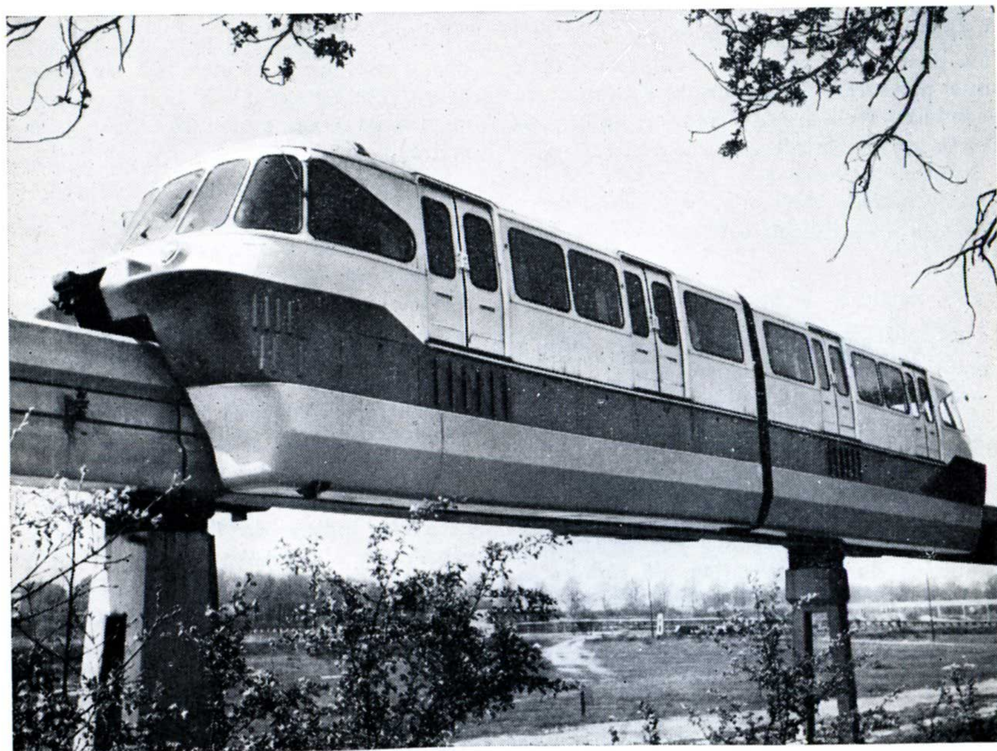
Un train de deux voitures Alweg sur la piste d'essai de Fuehlingen. (Photos Alweg Corporation)
