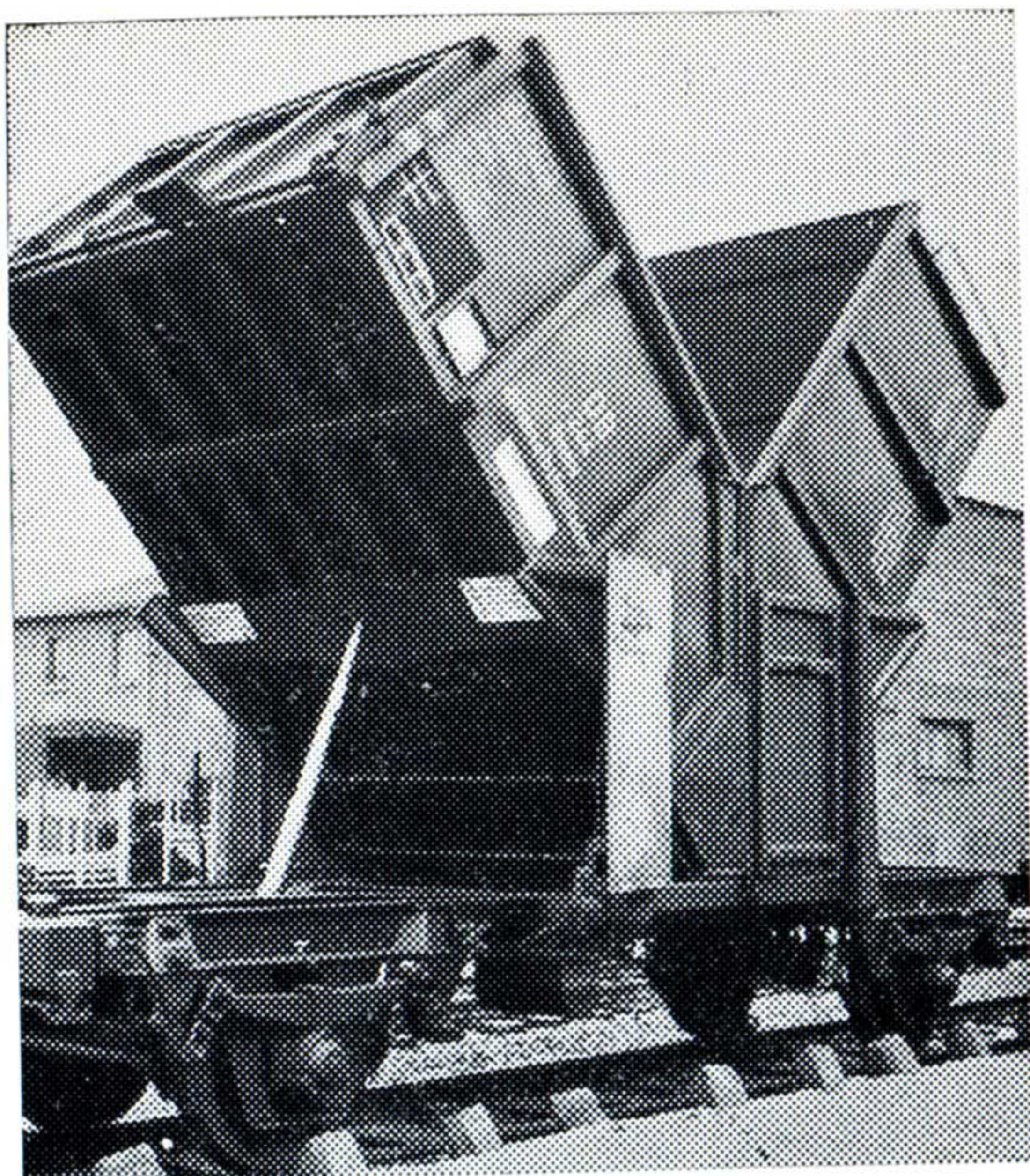
Fig. 8 — Wagon à déchargement central automatique (Photo D.B.)
