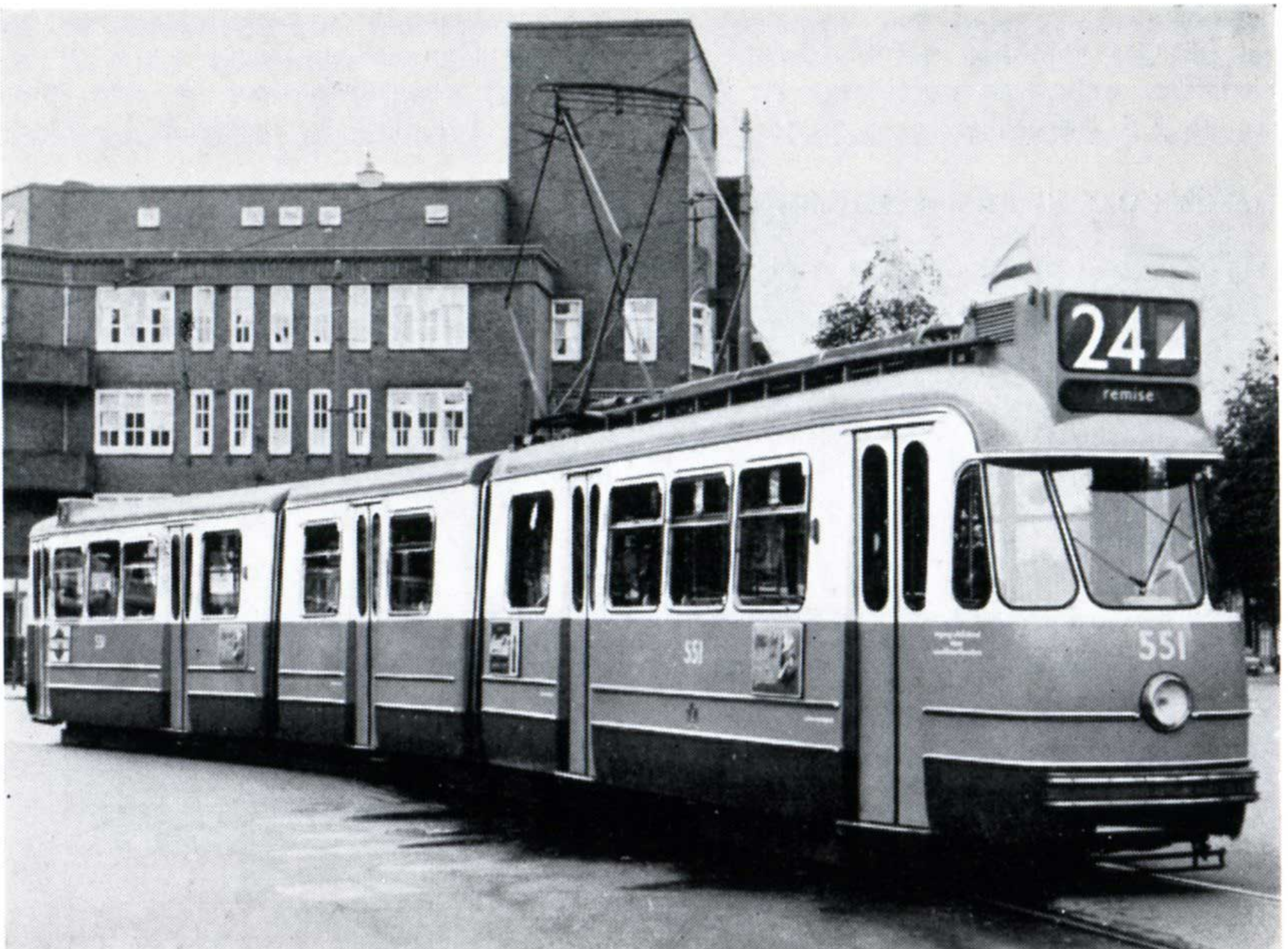
Rame articulée sur 4 bogies d'Amsterdam — 1958-59 — 34 unités (Photo Gemeente-Vervoerbedrijf Amsterdam)
