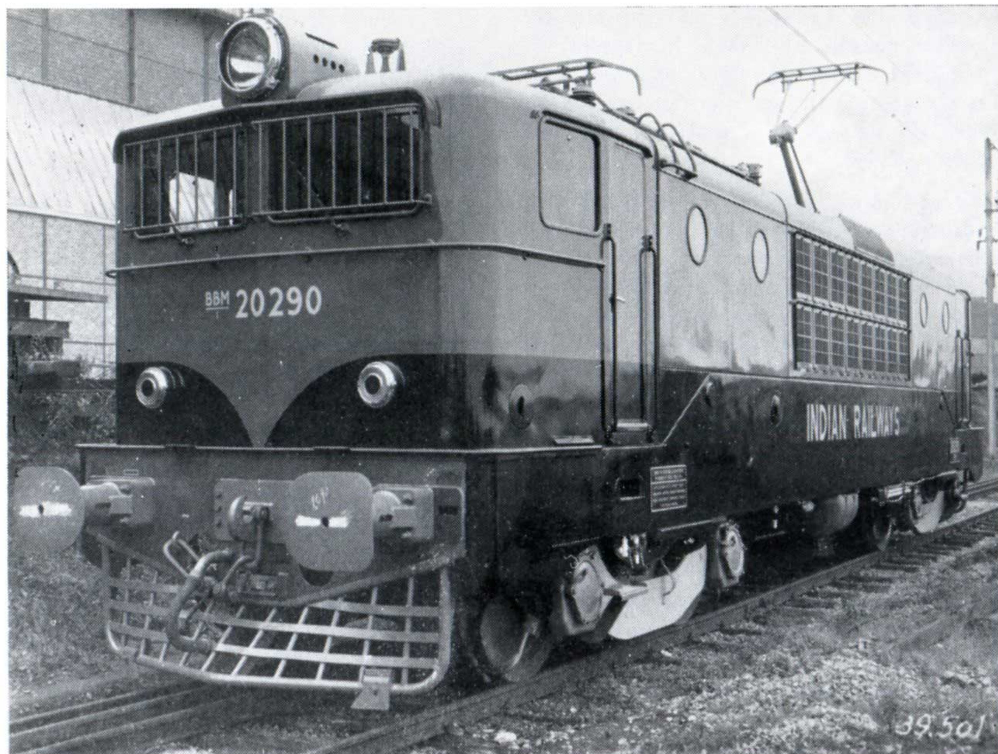
Locomotive électrique BB 25.000 V. 50 Hz fournie par l'industrie belge
