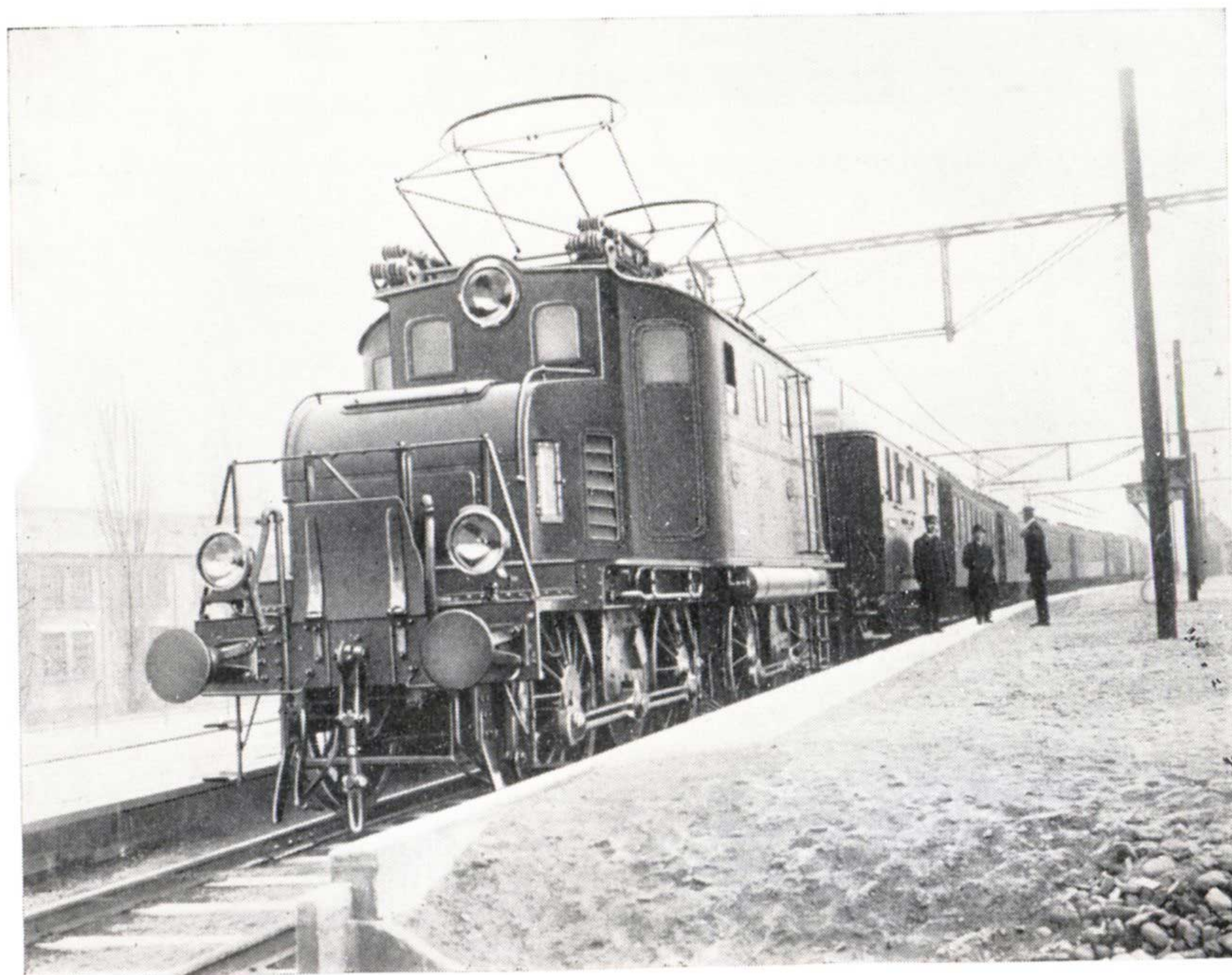
La ligne de Drammen vient d'être électrifiée : une El. 1, la 2004, en tête de son train — on remarquera la passerelle d'intercirculation, le frein à vide et les phares imposants. (Photo ASEA)
