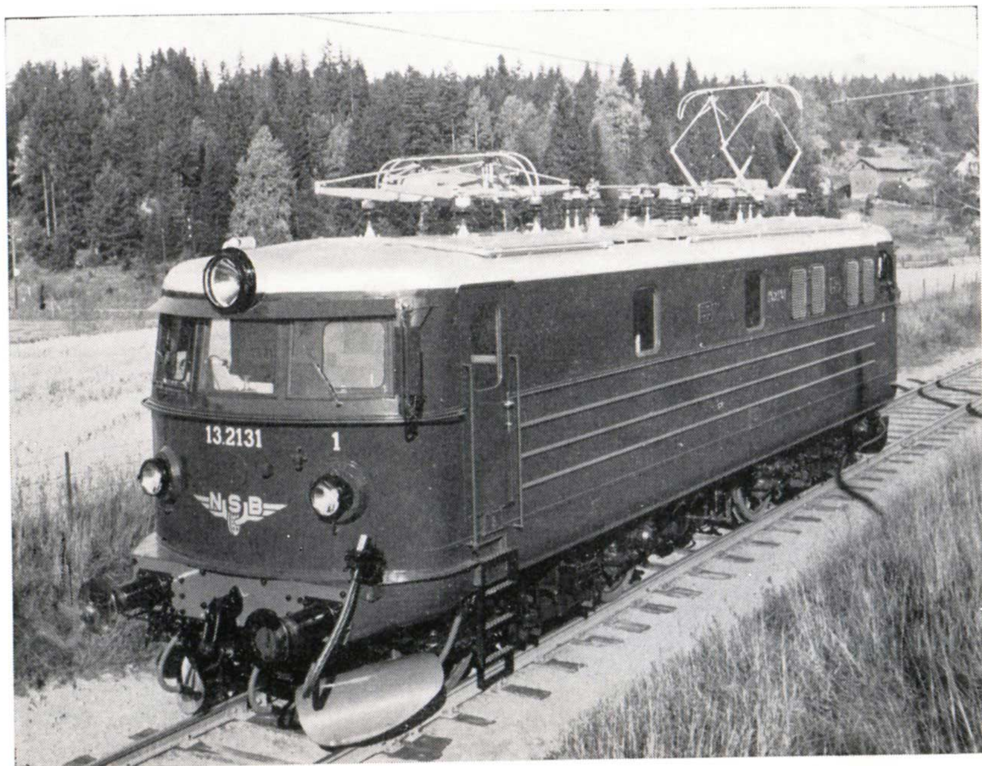
La plus puissante, la plus élégante et la plus récente : Bo'Bo' type El. 13 — livrée vert-olive, toiture argentée, motifs en crème — une nouveauté : la gaine transparente du câblot de chauffage. (Photo NEBB)
