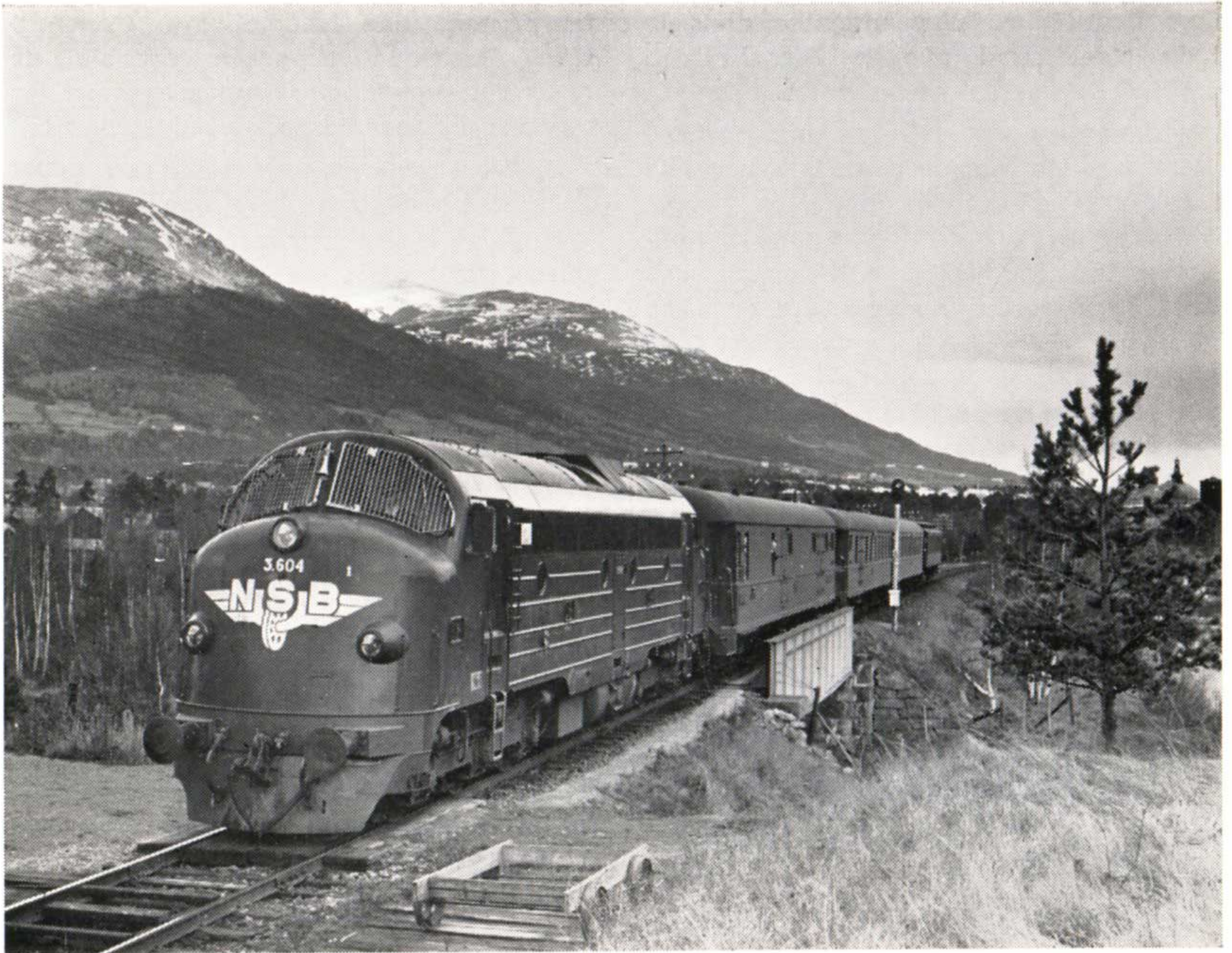
Essai de la Di. 3 n. 604 sur la ligne de Trondheim remarquez les grilles de protection. (Photo Schroder)
