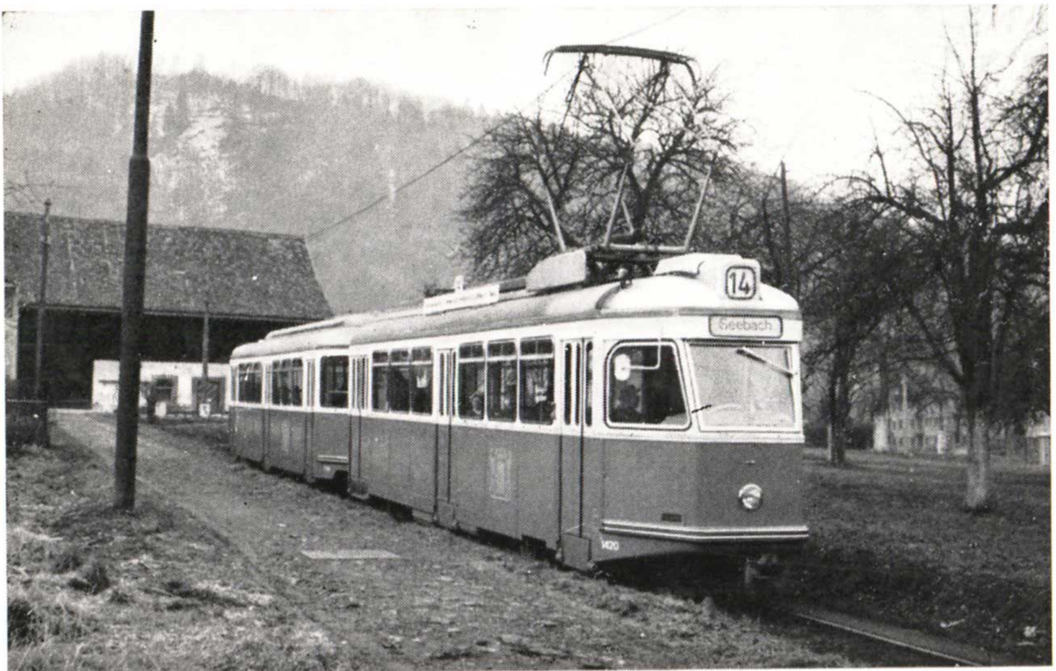
Tramways de Zürich motrices 1416-1430 et remorques 771-786, version 1959-1960 du type standard mi-lourd. (Photo de l'auteur)
