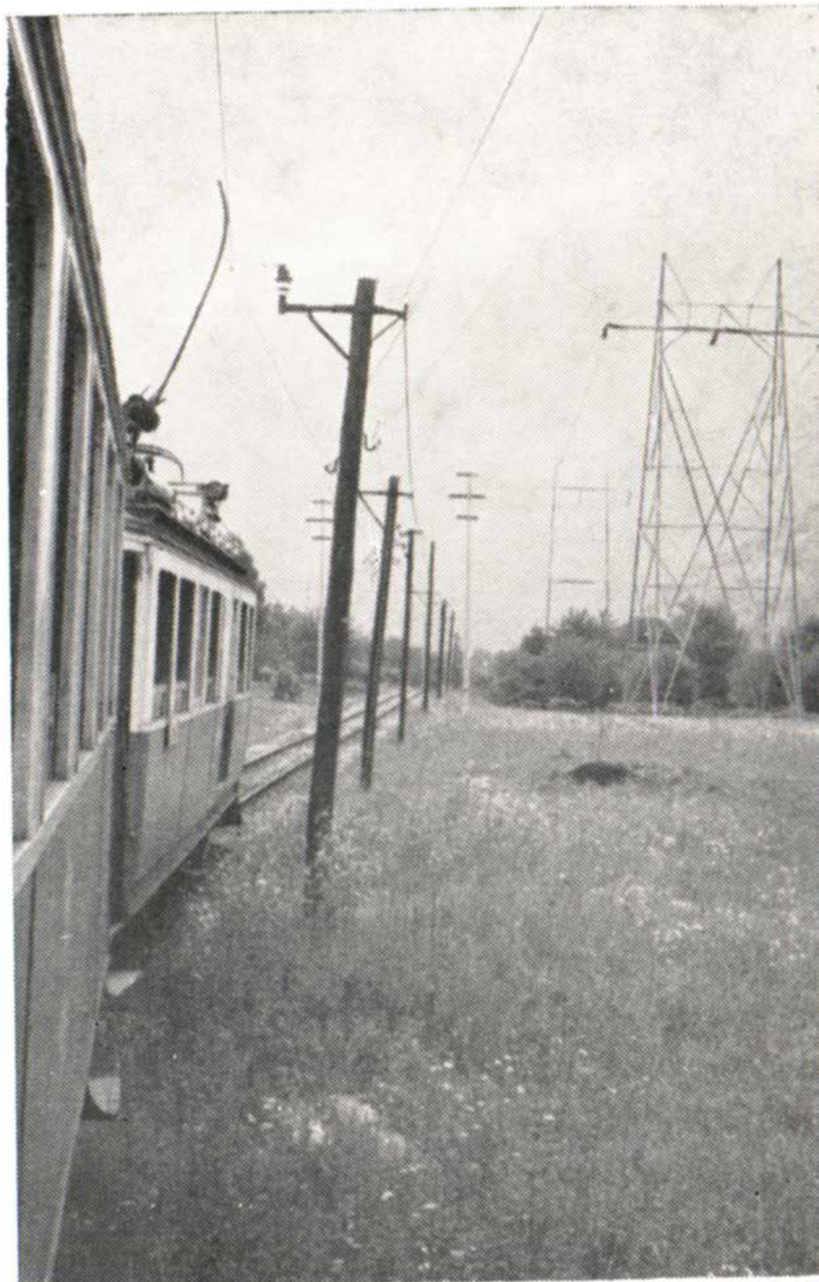
Sur la ligne de la vallée Maggia entre Ponte-Brolla et Bignasco, marche avec prise de courant latérale.
