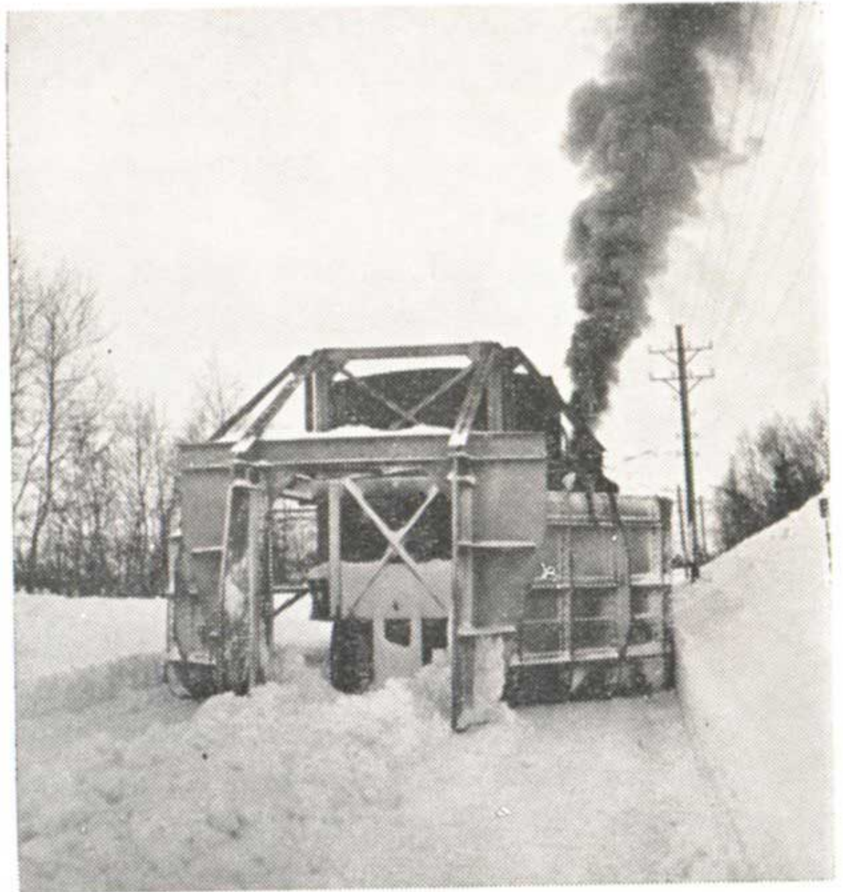
Le chasse-neige a fait sa trouée ; on dégage le gabarit à l'aide du gratteur, puis le chasse-neige repassera et ainsi de suite jusqu'au printemps. (Photo NSB)
