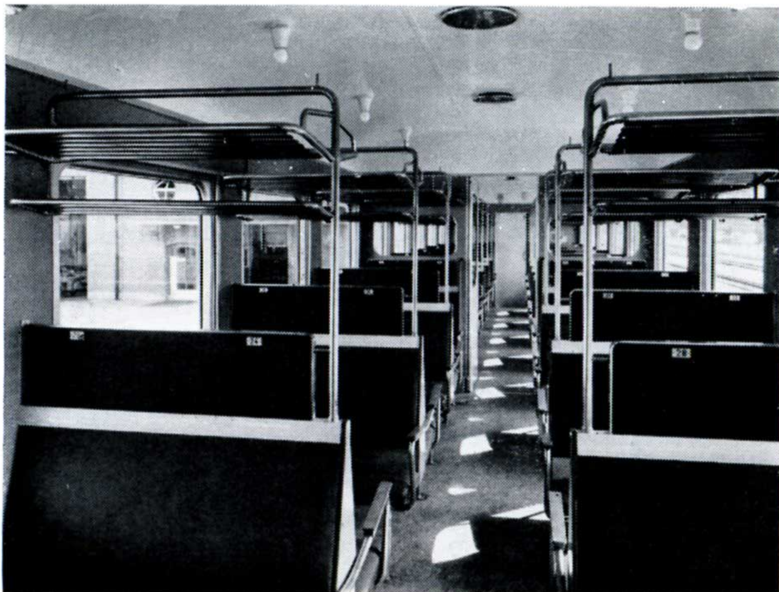
Fig. 10. Intérieur des voitures de 2ème classe du type « unifié ». La paroi vitrée qui sépare les 2 compartiments donne une bonne visibilité.
