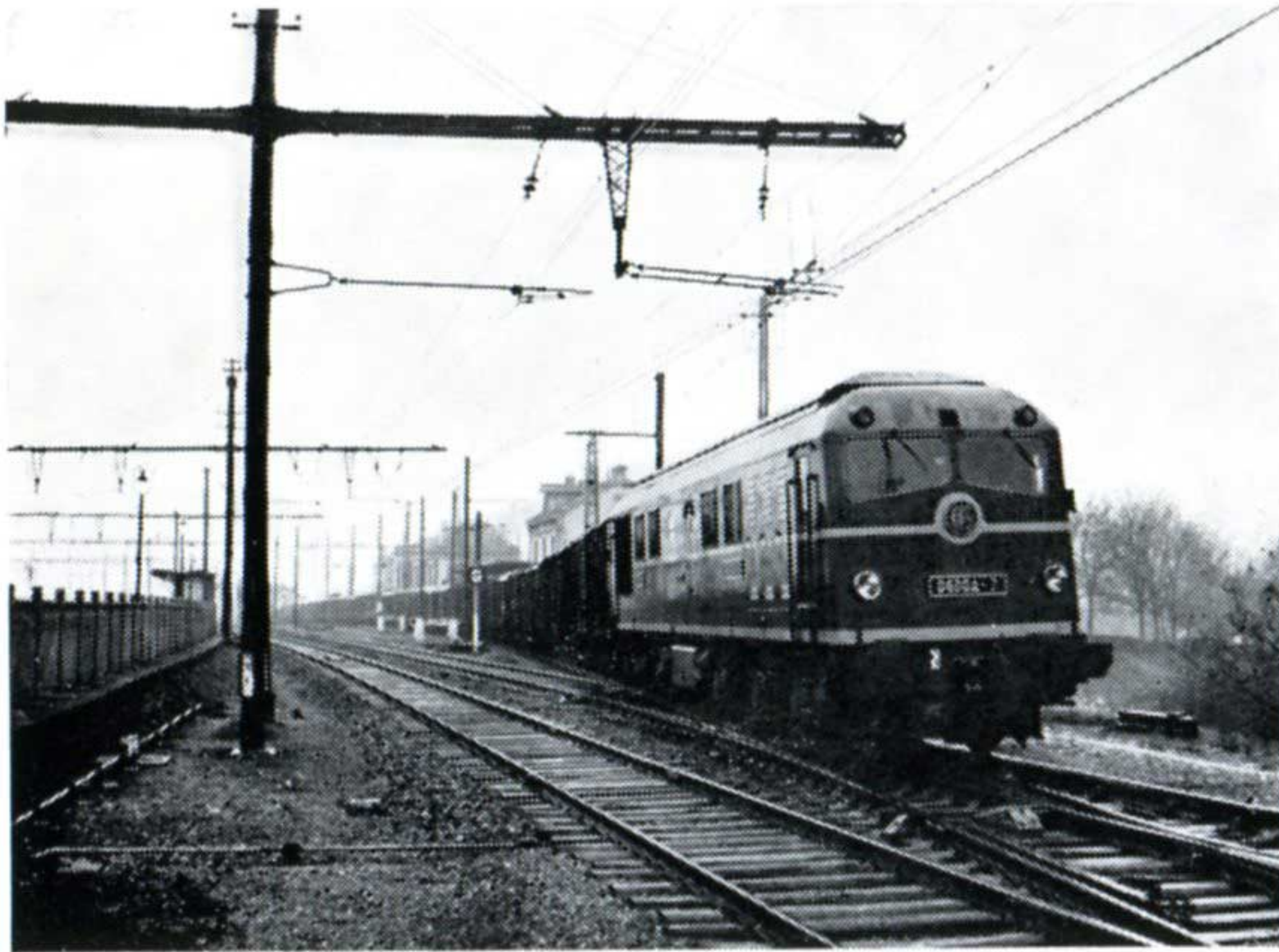
Locomotive Diesel-électrique 060 DA de la S.N.C.F. en tête d'un train de marchandises
