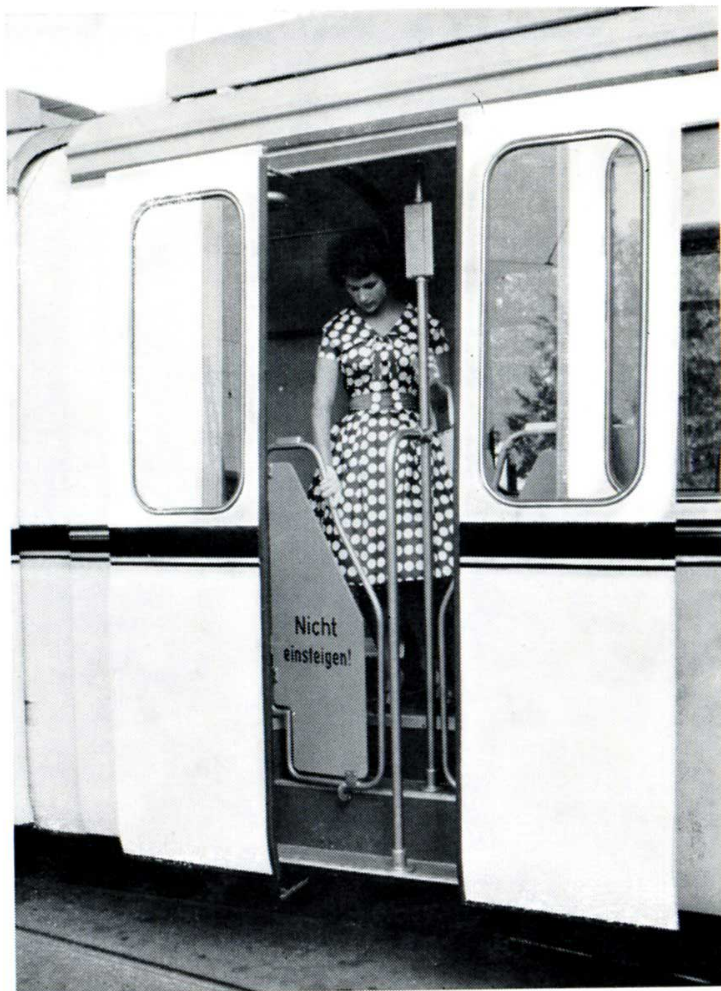
Fig. 7 — Détail de la porte de sortie des GT4 — on remarquera les deux \frac{1}{2} vantaux de fermeture et le portillon de sécurité unidirectionnel
