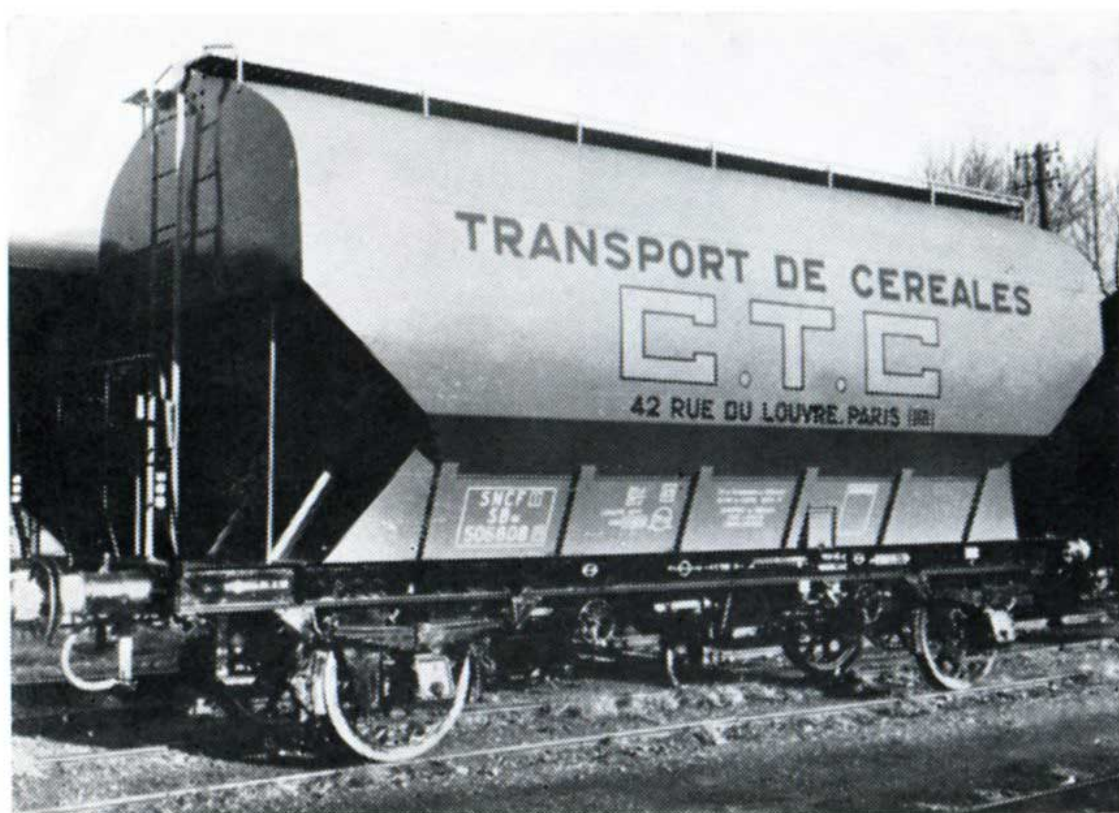
Wagon à deux essieux pour transport de céréales.
