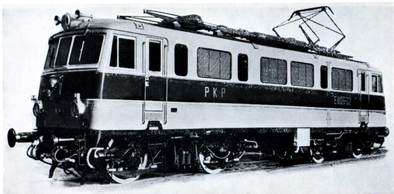
continu) par un des deux pantographes (ou par les deux à la fois); ceux-ci sont manœuvrés pneumatiquement et équipés d'une seule raquette chacun. Le courant ainsi capté est amené aux circuits de puissance par l'intermédiaire d'un disjoncteur ultra-rapide.
