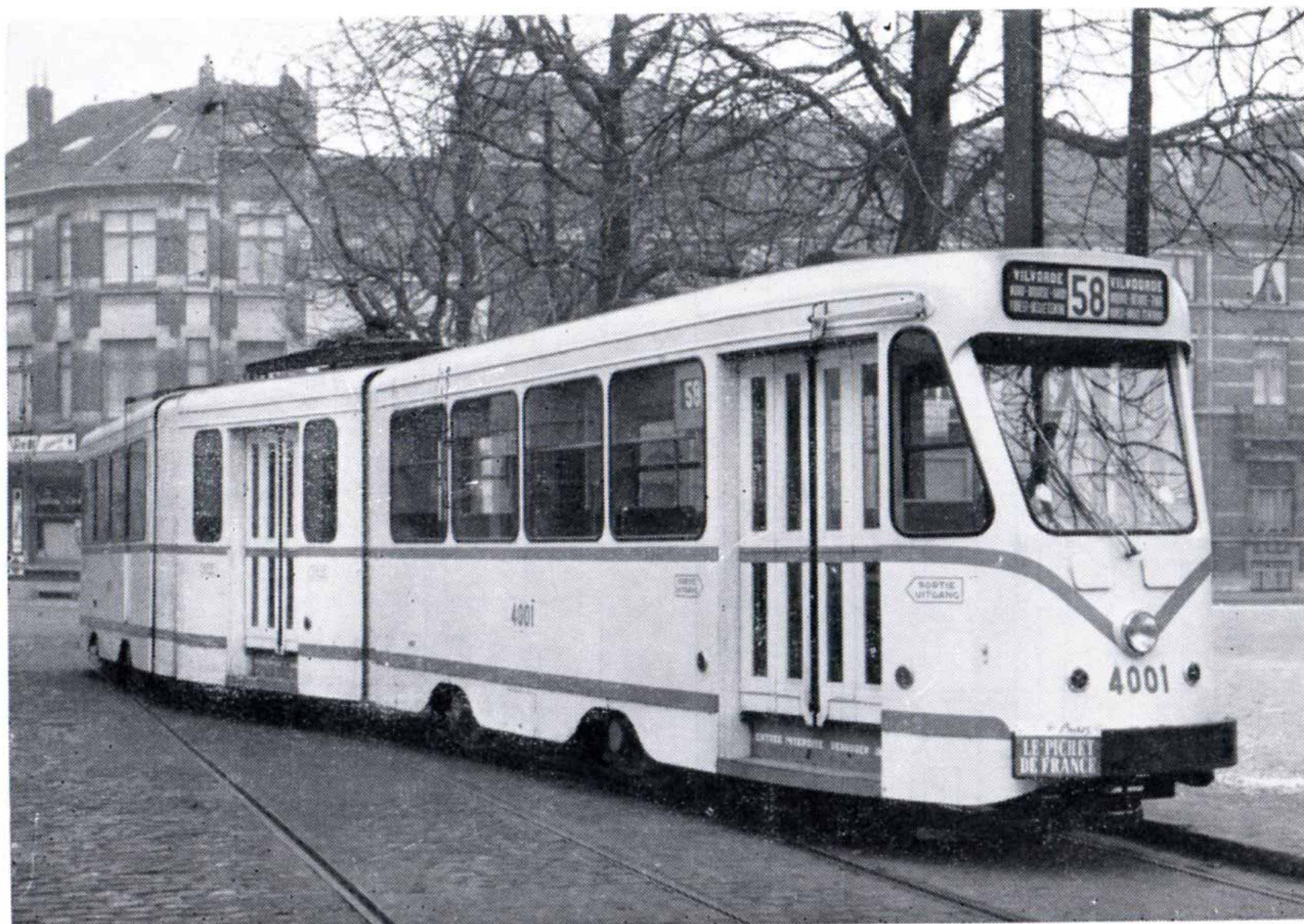
Fig. 14. — Vue extérieure de la voiture articulée au passage d'une courbe en S.
