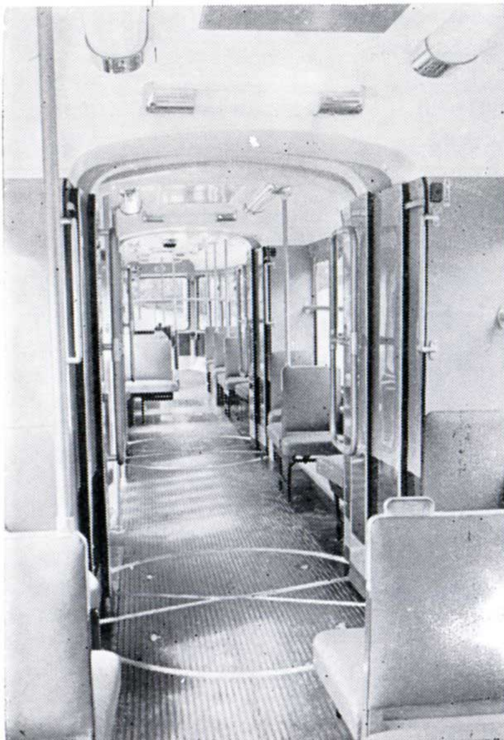
Fig. 9. — Ci-dessous, vue de l'élément central avec les deux articulations. (Photo S.T.I.B.)
