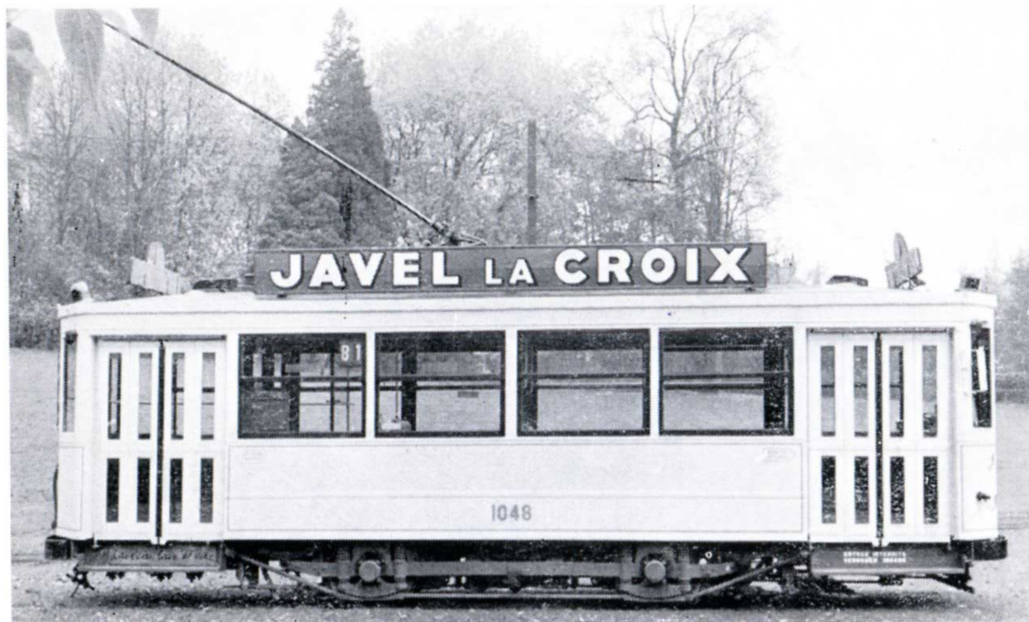
Fig. 4. — Vue extérieure de la motrice à 2 essieux type standard.
