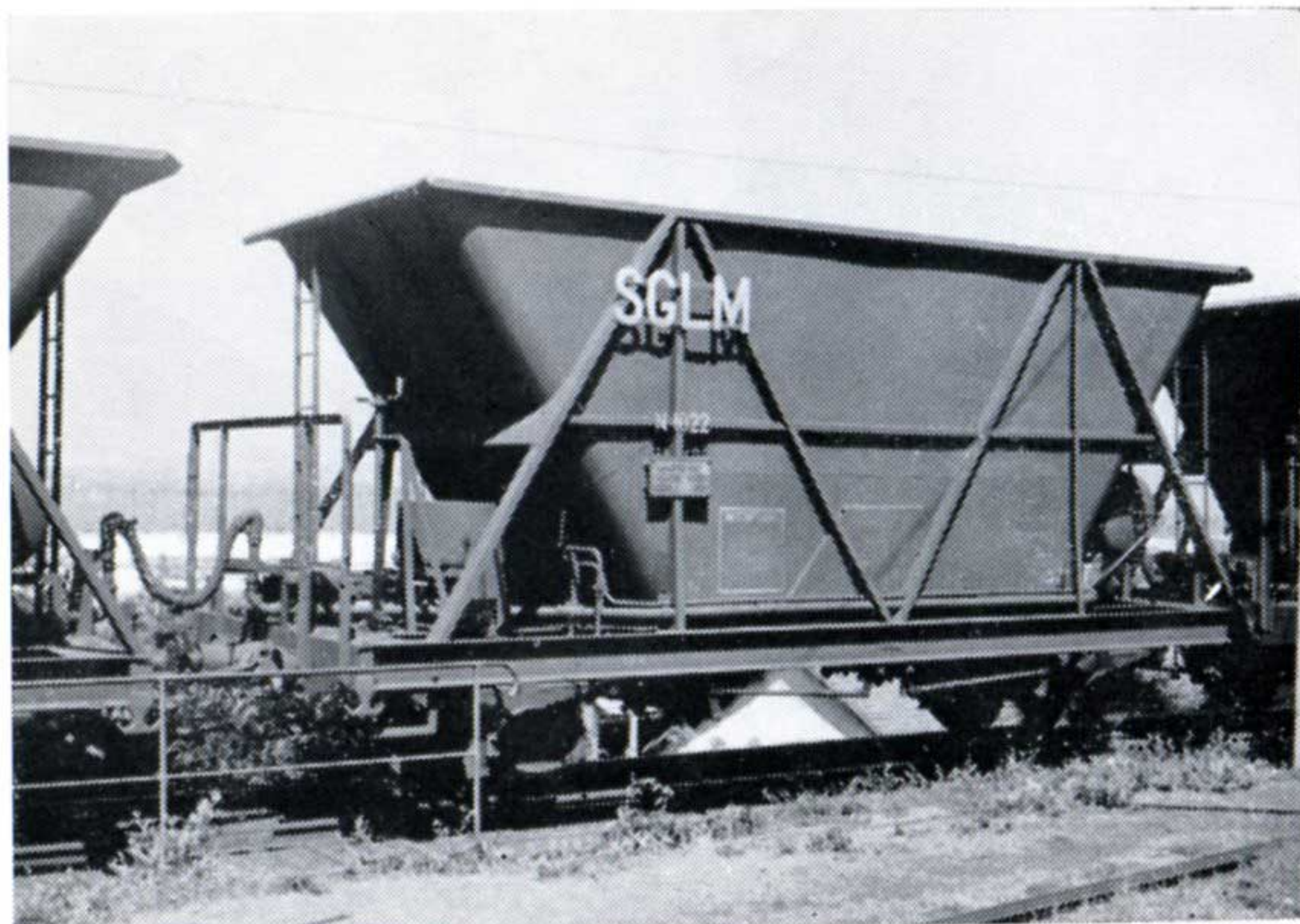
Nouveau wagon-trémie à charbon du SGLM.
