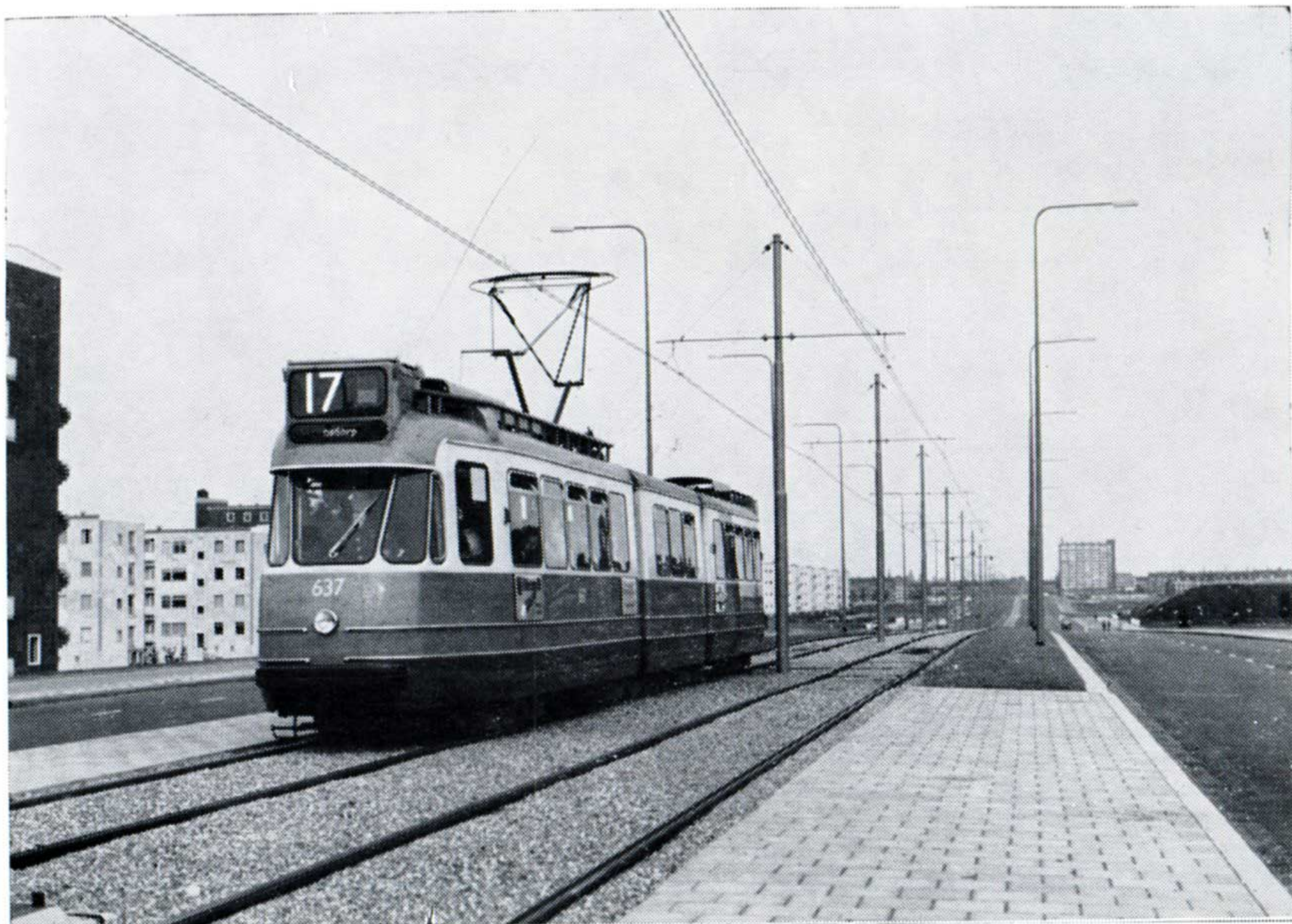
Autoroute suburbaine à Amsterdam (Lelylaan) avec au centre, sur site propre, motrice triple articulée. (Photo Frits Van Dam)
