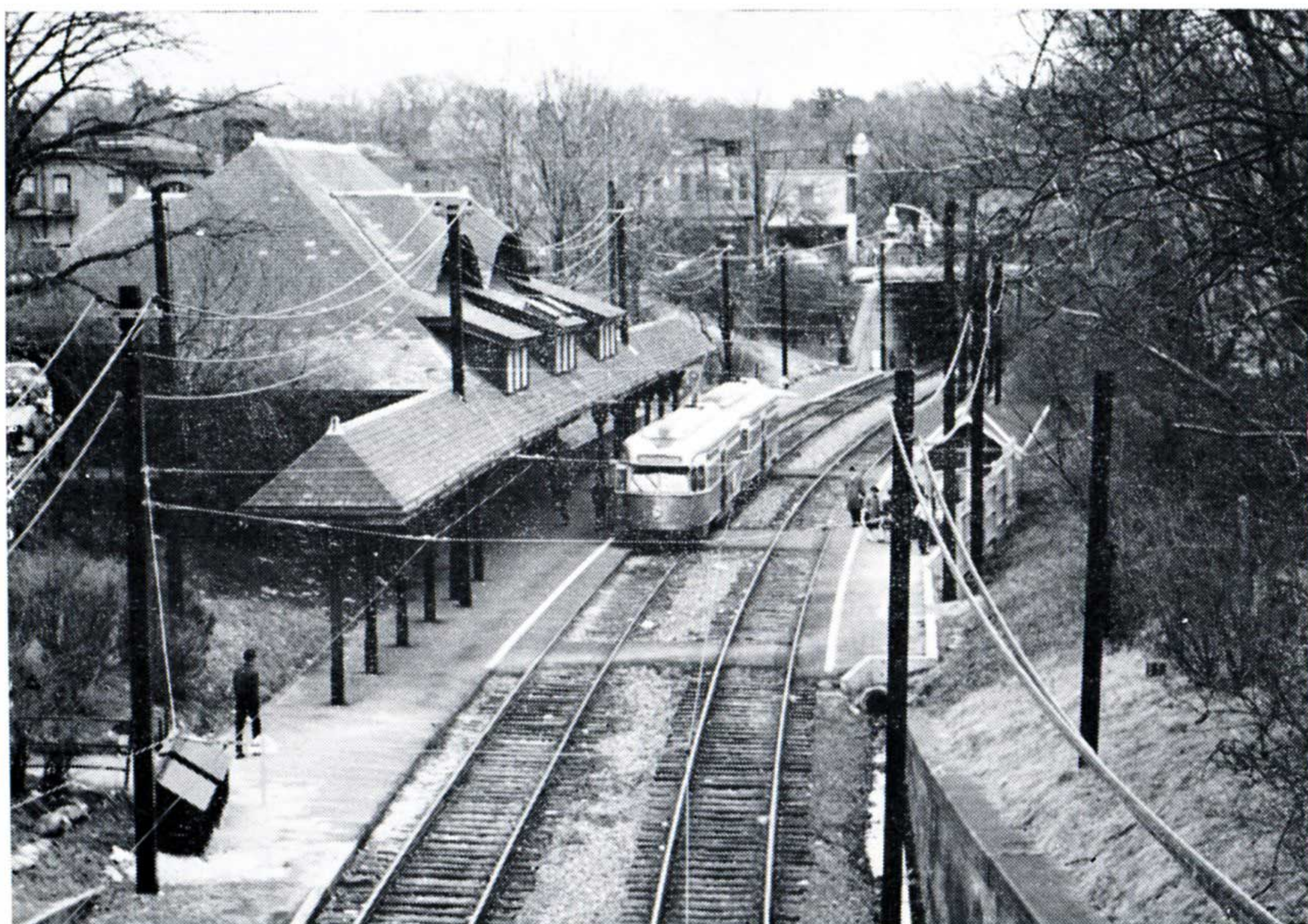
2 motrices P.C.C. en « unités multiples » à l'arrêt sur une ligne en site propre gardé vers Riverside (Boston-U.S.A.) (Photo Ara Mesrobian)
