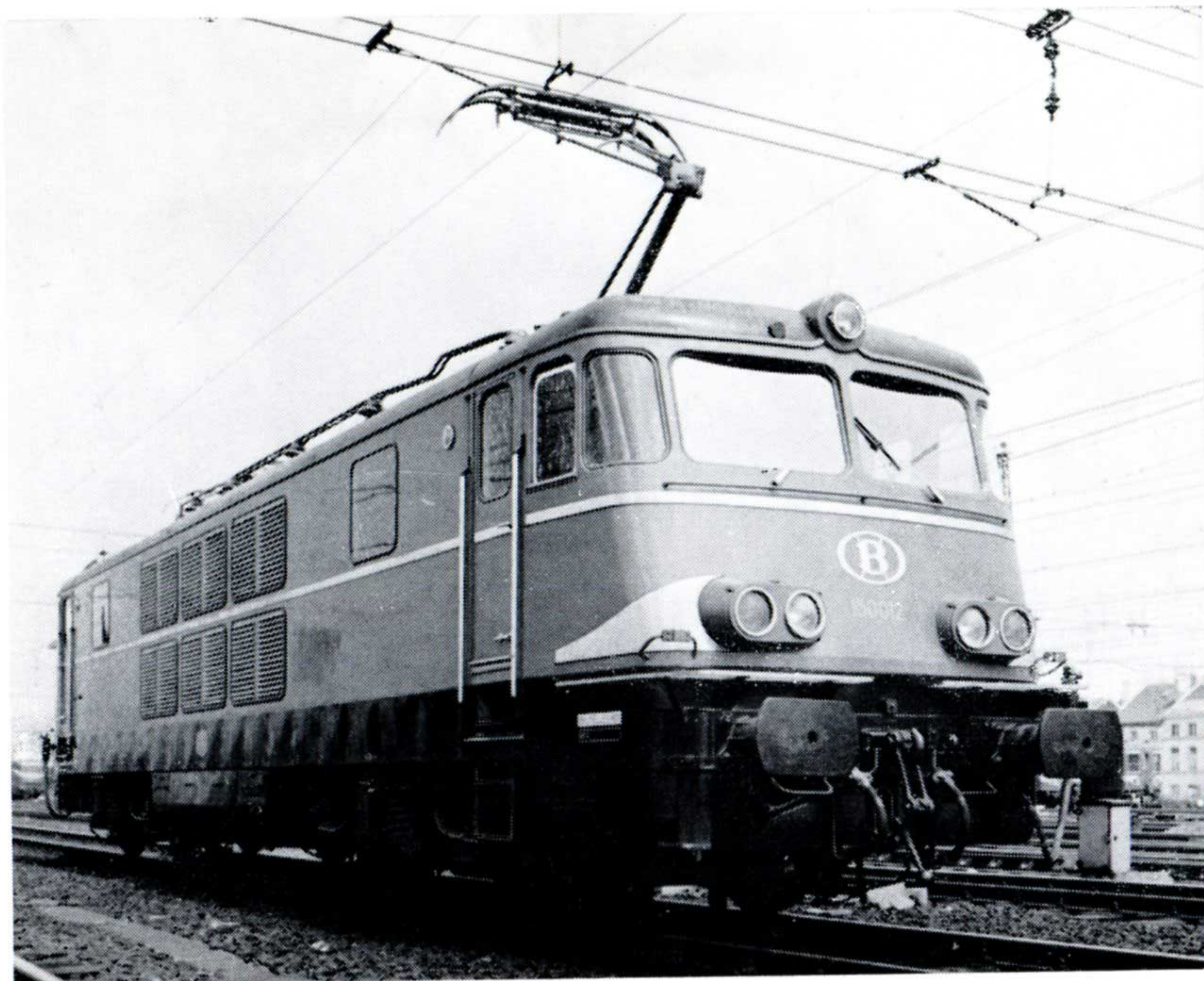
Locomotive BB tricourant type 150 de la S.N.C.B.
