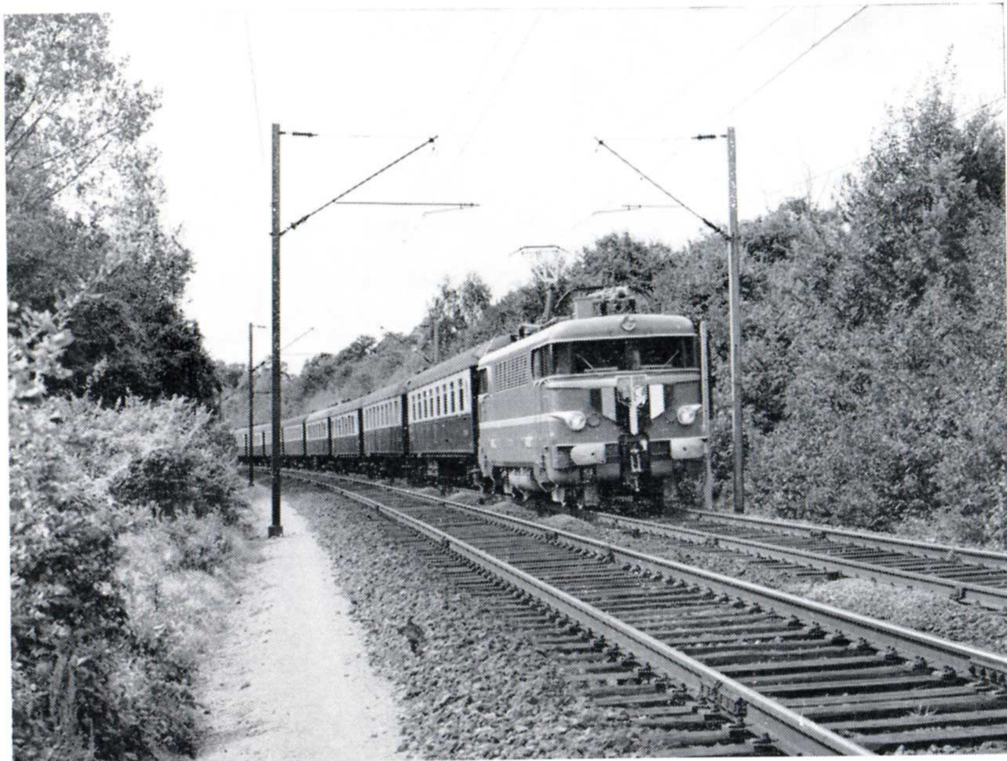
Le train inaugural : rame de voitures Pullmann et locomotive BB tri-courant série 30.000 de la S.N.C.F. (Photo S.N.C.F.)
