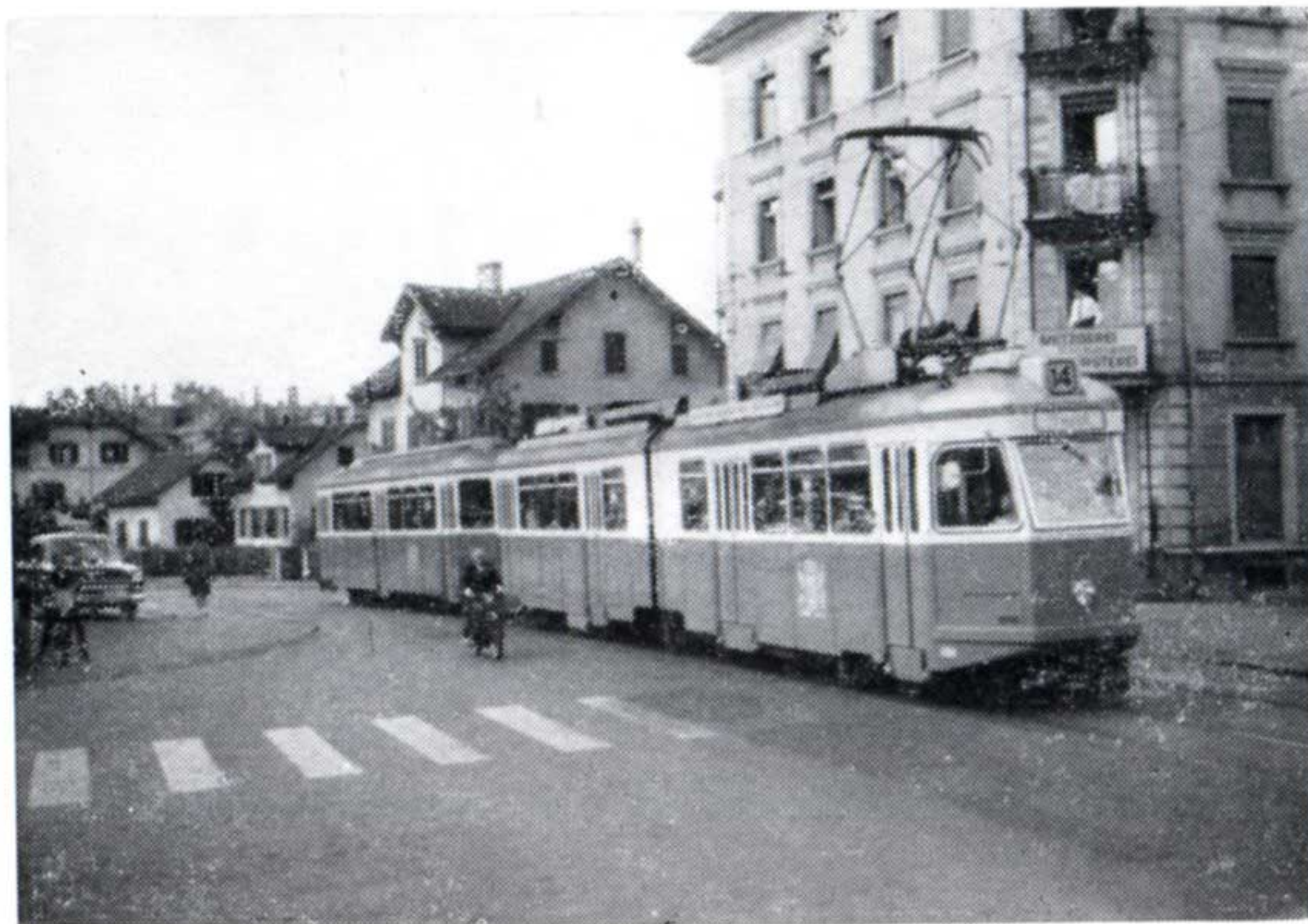
Zurich — 270 personnes sont transportées rapidement et confortablement sur voie étroite par ce couplage motrice articulée 1701 plus remorque standard.
