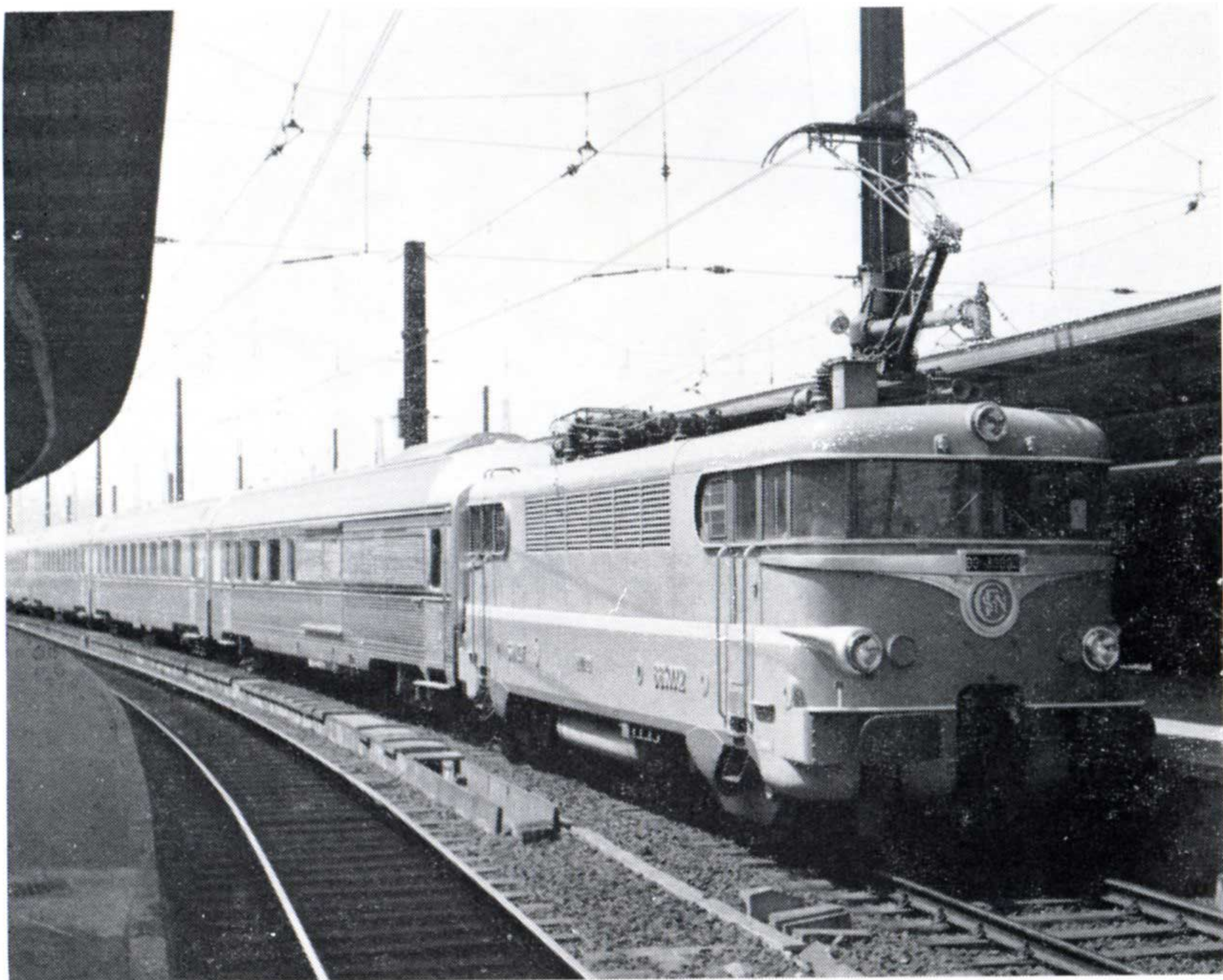
Locomotive BB tricourant série 30.000 de la S.N.C.F. en tête d'un Trans-Europ-Express Bruxelles-Paris — Ci-dessous, locomotive CC quadricourant série 40.100 de la S.N.C.F. sous caténaire 3.000 volts à Bruxelles-Midi. (Photos B. Dedoncker)
