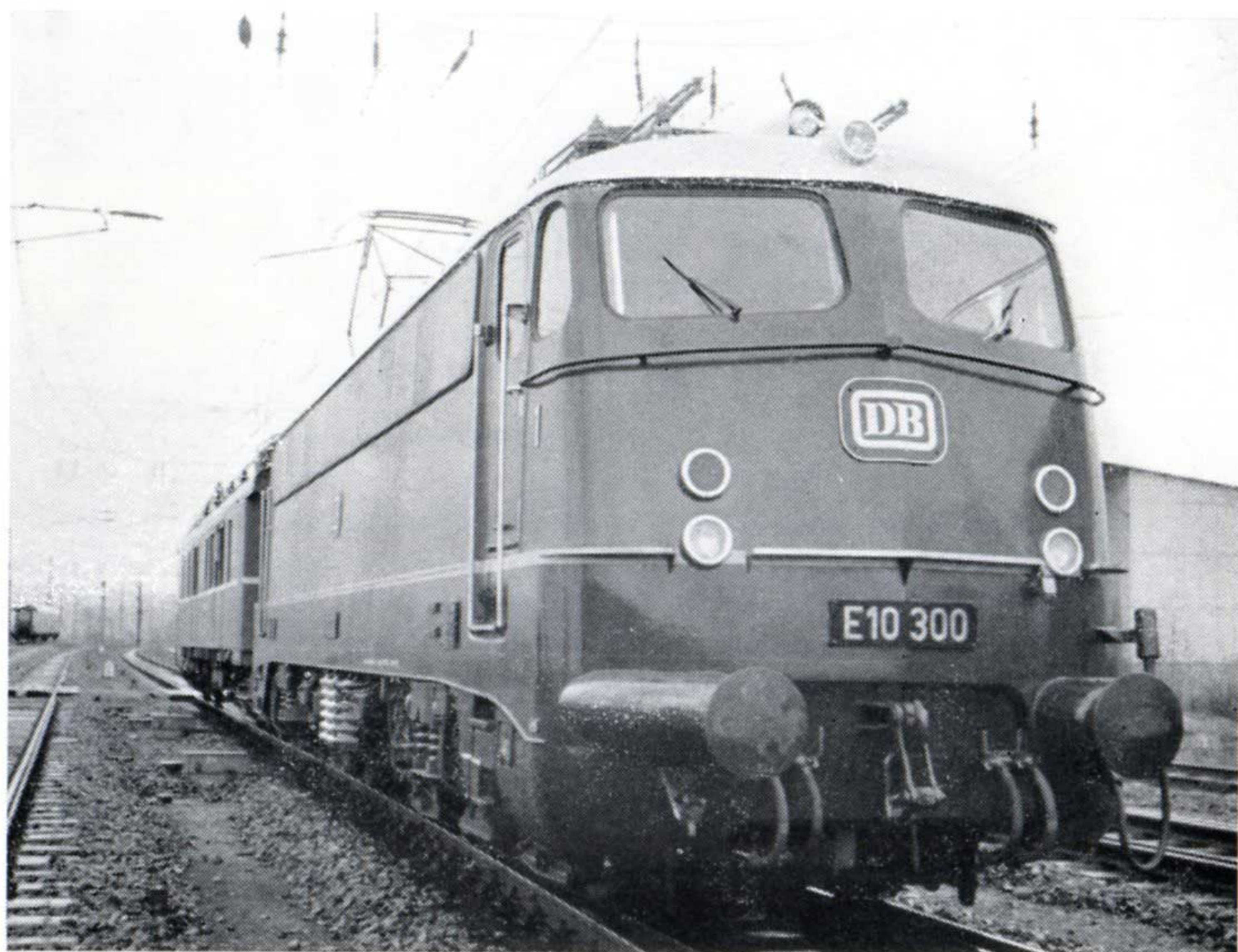
Locomotive E 10 en essais — on remarquera, immédiatement derrière, la voiture-laboratoire.
