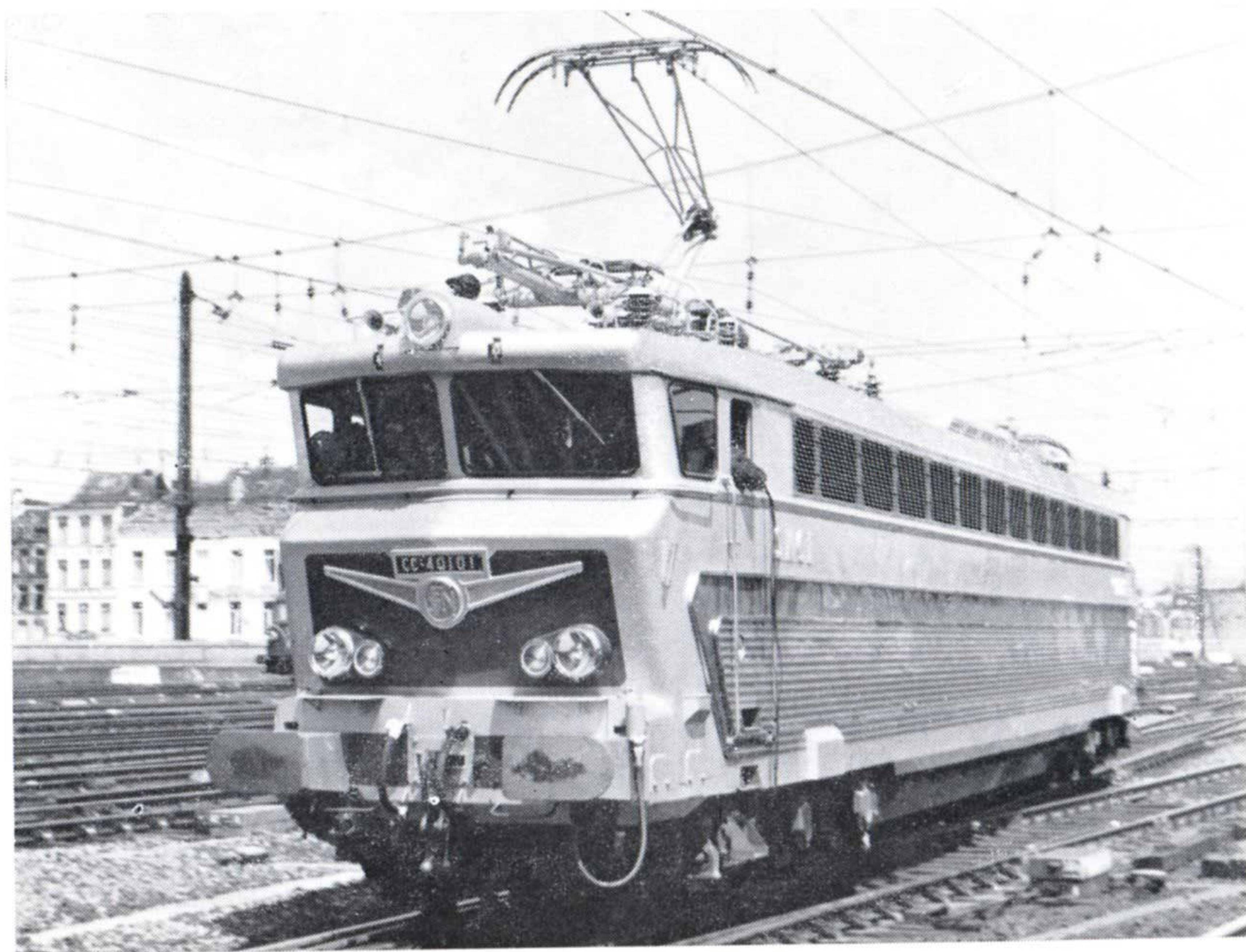
Locomotive BB tricourant série 30.000 de la S.N.C.F. en tête d'un Trans-Europ-Express Bruxelles-Paris — Ci-dessous, locomotive CC quadricourant série 40.100 de la S.N.C.F. sous caténaire 3.000 volts à Bruxelles-Midi. (Photos B. Dedoncker)
