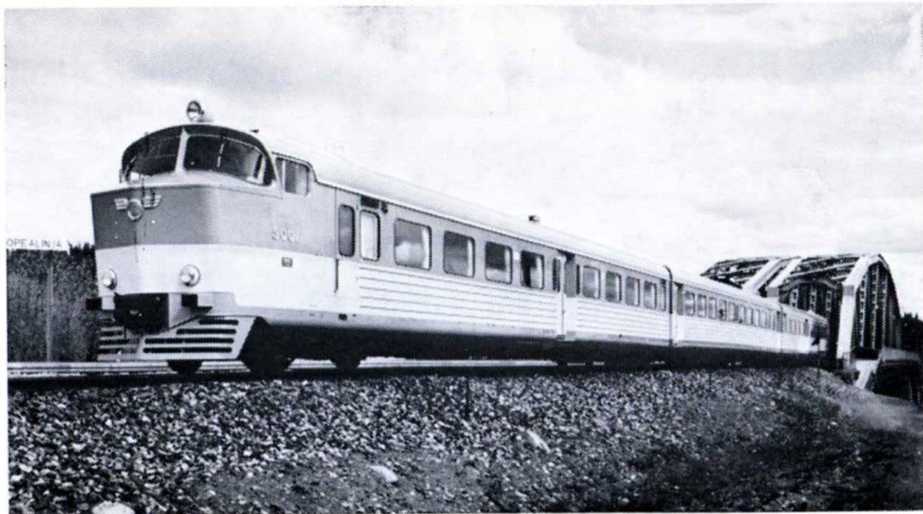
Le nouveau train se compose de deux automotrices et d'une voiture intermédiaire. Trois rames accouplées peuvent former un train de neuf voitures si c'est nécessaire. L'aménagement intérieur est très moderne et les sièges sont recouverts d'une matière aux couleurs gaies. Le train, dont les deux moteurs développent une puissance de 1000 CV, peut atteindre la vitesse de 140 km/h.
