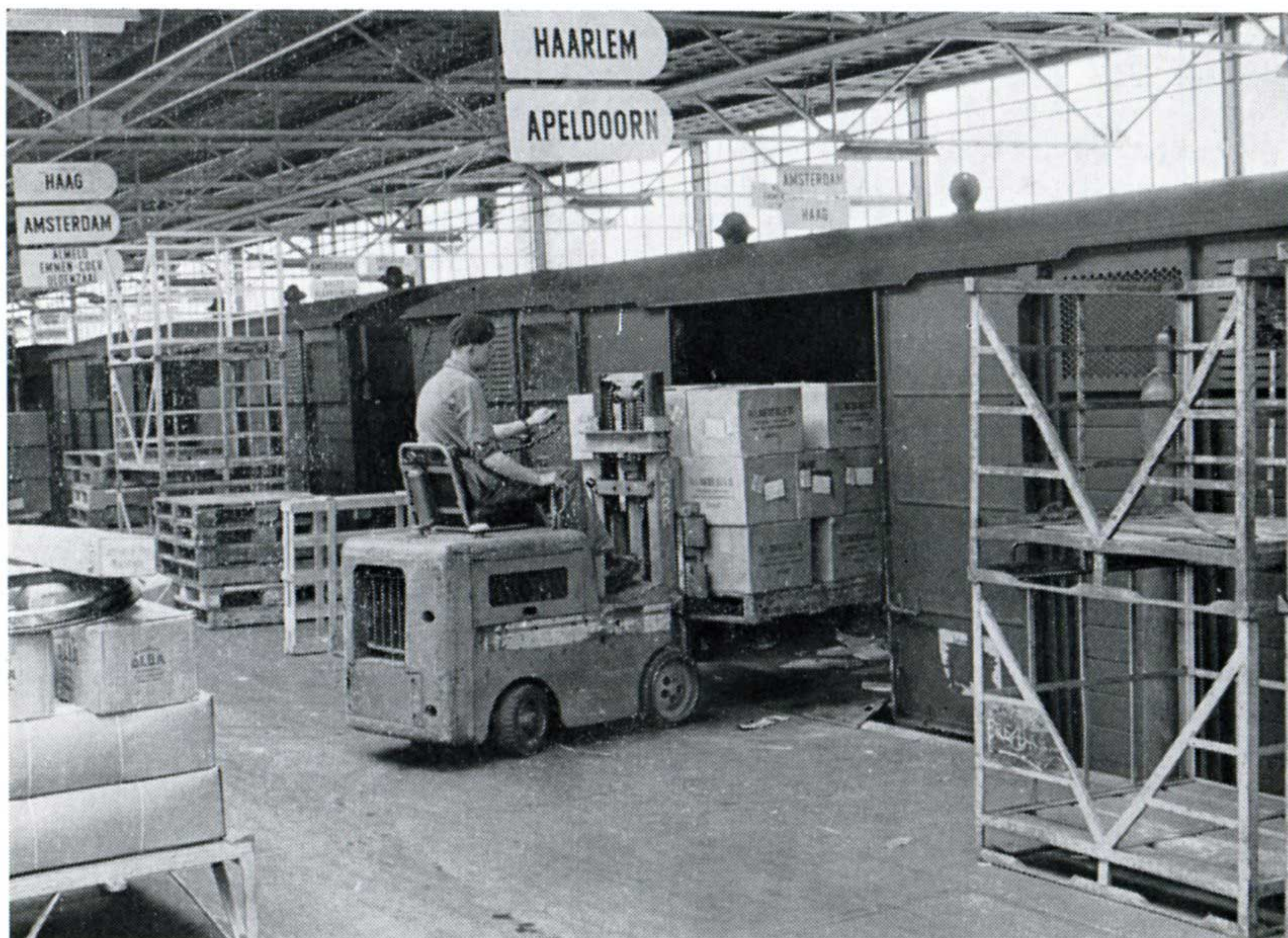
Mécanisation de la manutention des charges incomplètes dans un hangar spécialisé. (Photo N.S.)
