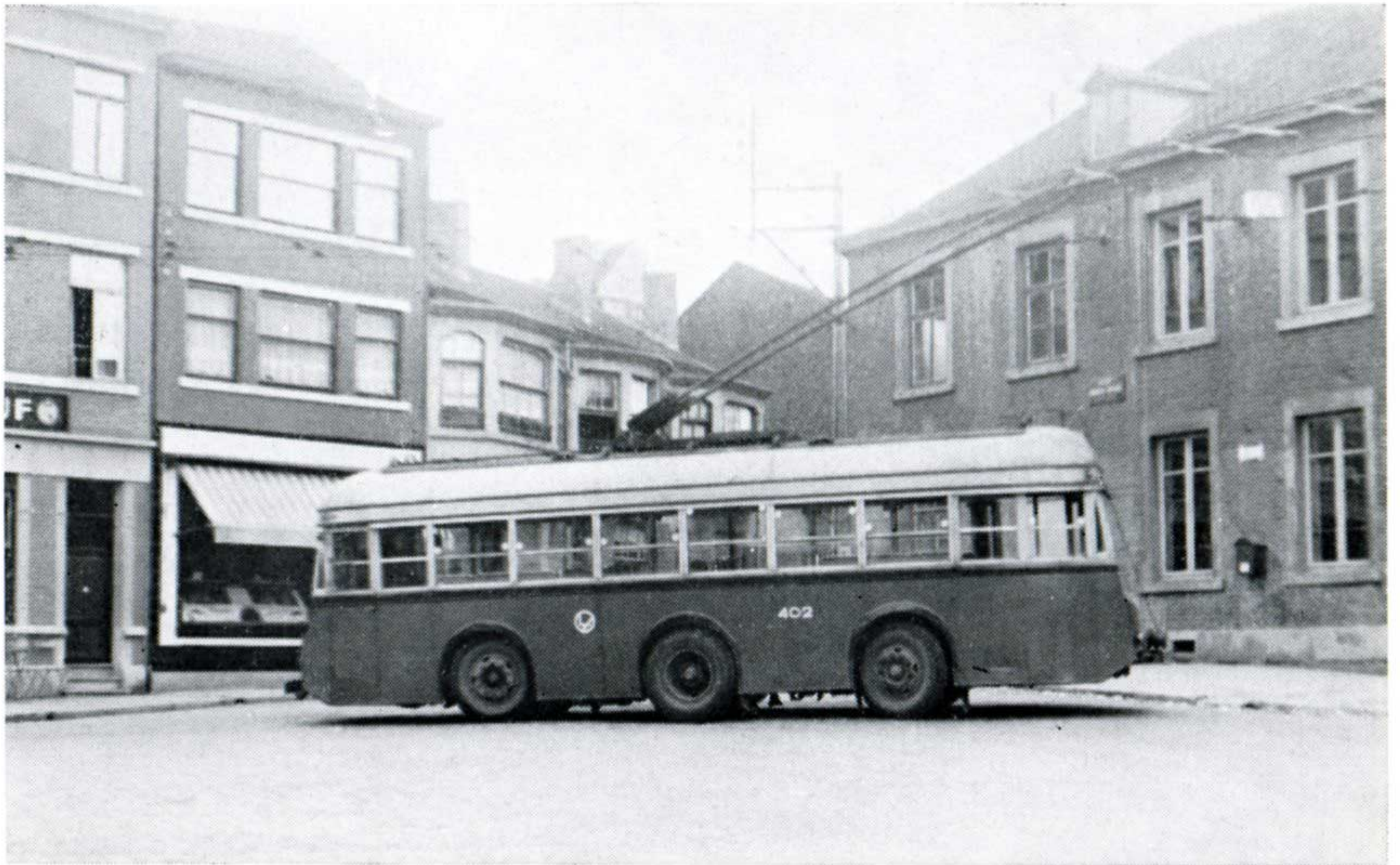
Trolleybus n° 402 à trois essieux, deux postes de conduite et double jeu de perches.
