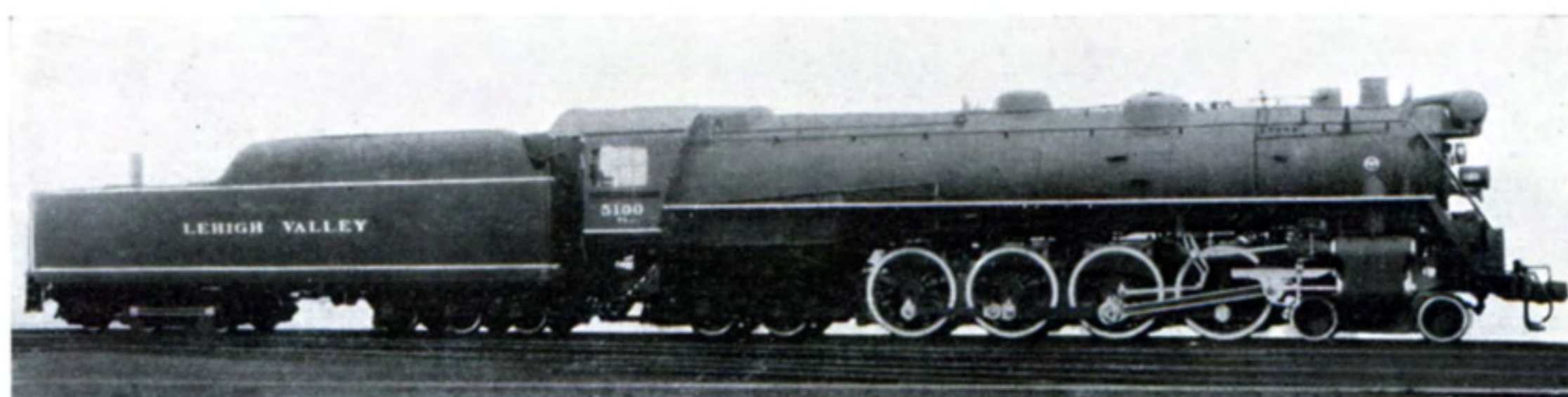
Fig. 184 LEHIGH VALLEY RAILROAD, ETATS-UNIS. Bogie directeur : 1 roulement 22334 spécial par boîte d'essieu. Charge maximum par boîte 6,8 tonnes. — Booster : 1 roulement 22340 par boîte d'essieu. Charge maximum par boîte 12,5 tonnes.
