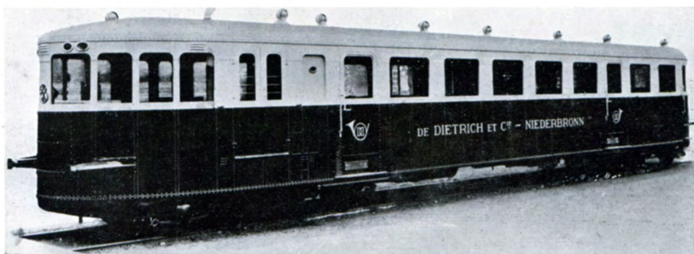
Fig. 164 CHEMINS DE FER FRANÇAIS. Autorail Diesel construit par De Diétrich et Cie, à Niederbronn. — 8 boîtes d'essieux par véhicule, comportant chacune 1 roulement 22320 K (fig. 10). Charge maximum par boîte 3,4 tonnes. Vitesse maximum 110 kilomètres à l'heure. — Bogie suivant fig. 68
