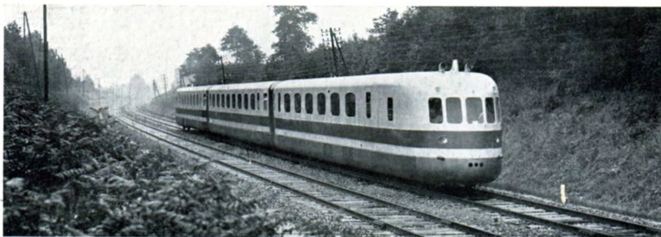
Fig. 130 CHEMIN DE FER DU NORD, FRANCE. Rame Diesel-électrique, 410 CV., construite par la Société Franco-Belge de Matériel de Chemins de Fer, composée de 3 voitures. — 24 boîtes d'essieux par rame, comportant chacune 2 roulements I-37906 (fig. 3). Charge maximum par boîte 6 tonnes. Vitesse maximum 150 kilomètres à l'heure. — Bogie suivant fig. 46.
