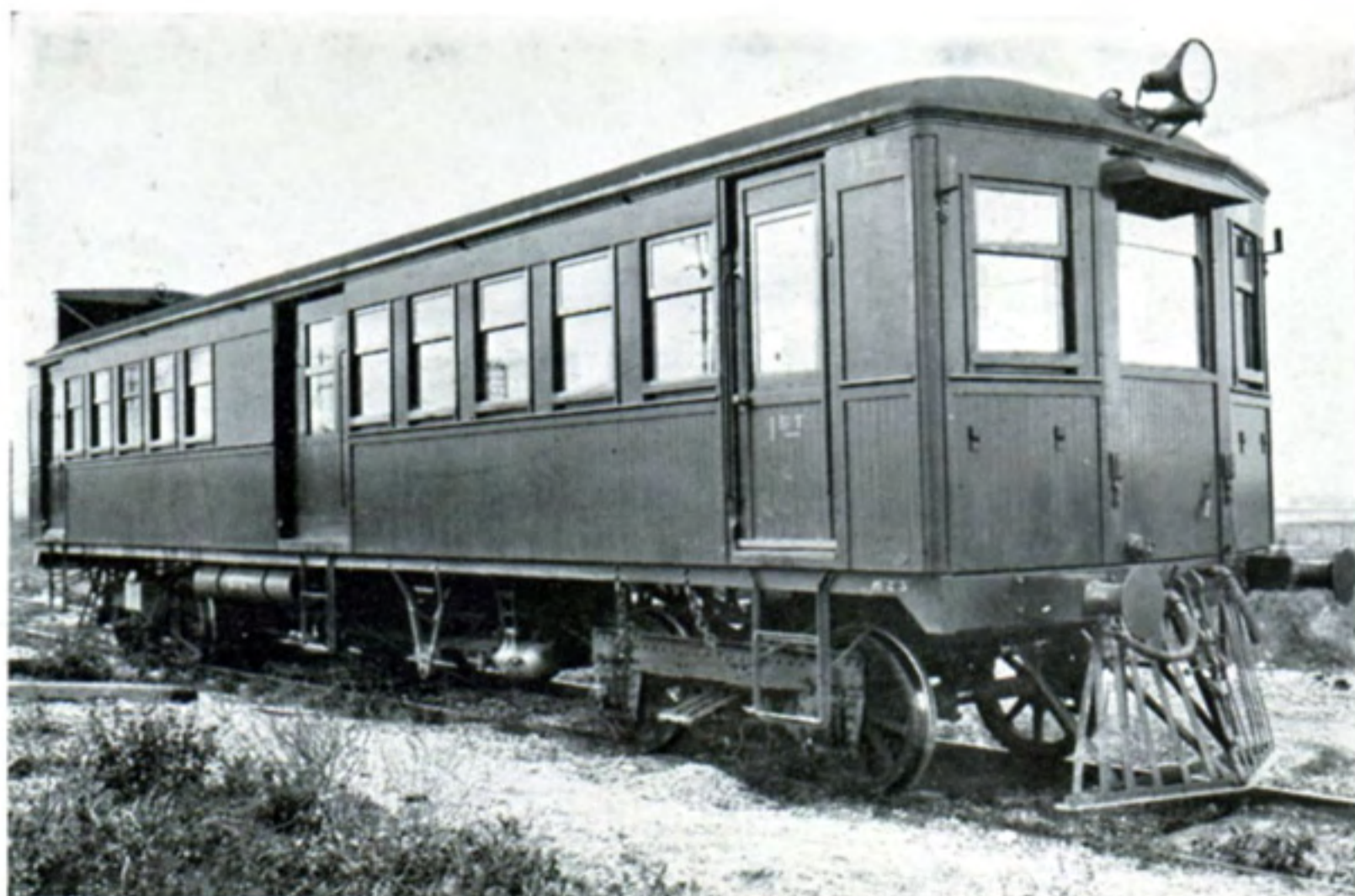
Fig. 155 NEW SOUTH WALES GOVERNMENT RAIL- WAYS, AUSTRALIE. Au- torail à moteur à essence, 100 CV. — 8 boîtes d'es- sieux par véhicule, com- portant chacune 2 roule- ments 22316 K. Charge maximum par boîte 2,9 tonnes.
