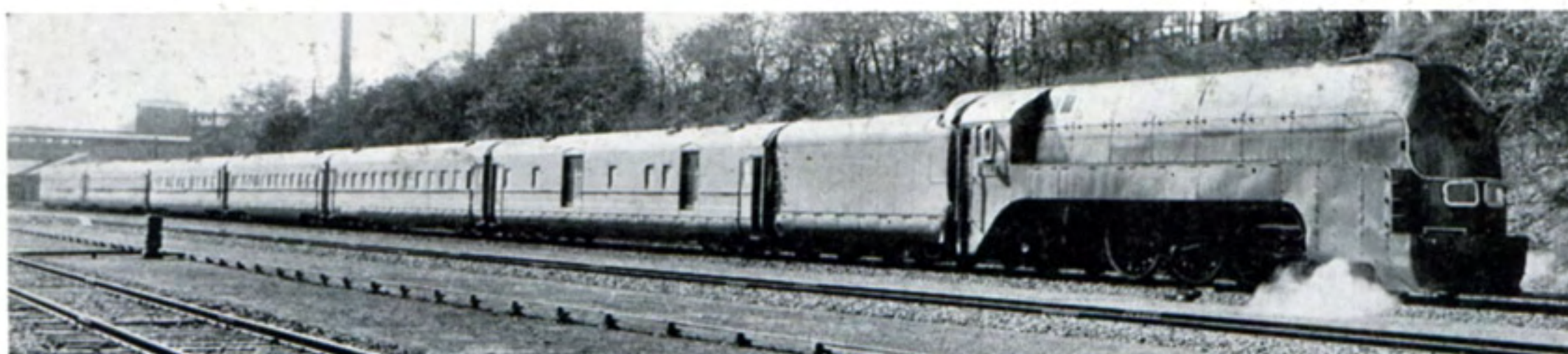
Fig. 108 SOUTH MANCHURIA RAILWAY Co., MANDCHOUKOUO. Voitures à voyageurs. — 8 boîtes d'essieux par voiture, comportant chacune 2 roulements I-37906 (fig. 6). Charge maximum par boîte 7 tonnes. Vitesse maximum 120 kilomètres à l'heure.
