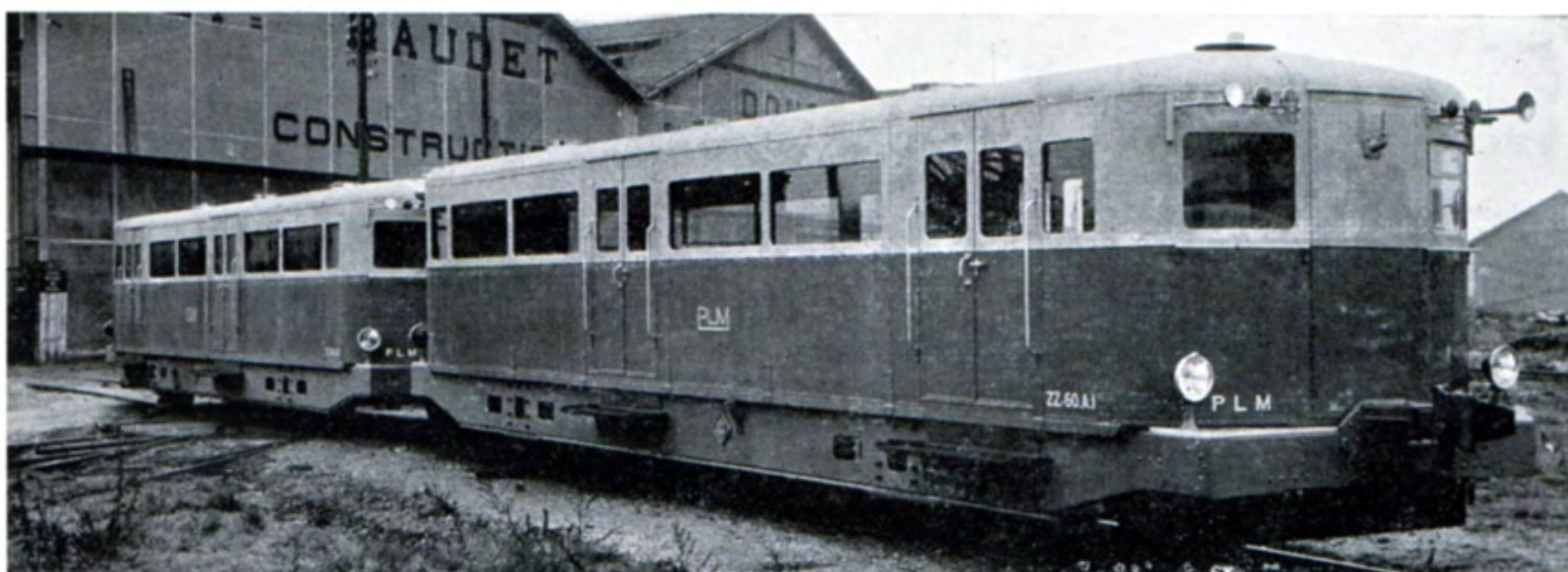
Fig. 162 CHEMINS DE FER DU P.-L.-M., FRANCE. Autorail construit par Baudet-Donon-Roussel. — 4 boîtes d'essieux par véhicule, comportant chacune 1 roulement 22320 K (fig. 4). Charge maximum par boîte 3,5 tonnes.
