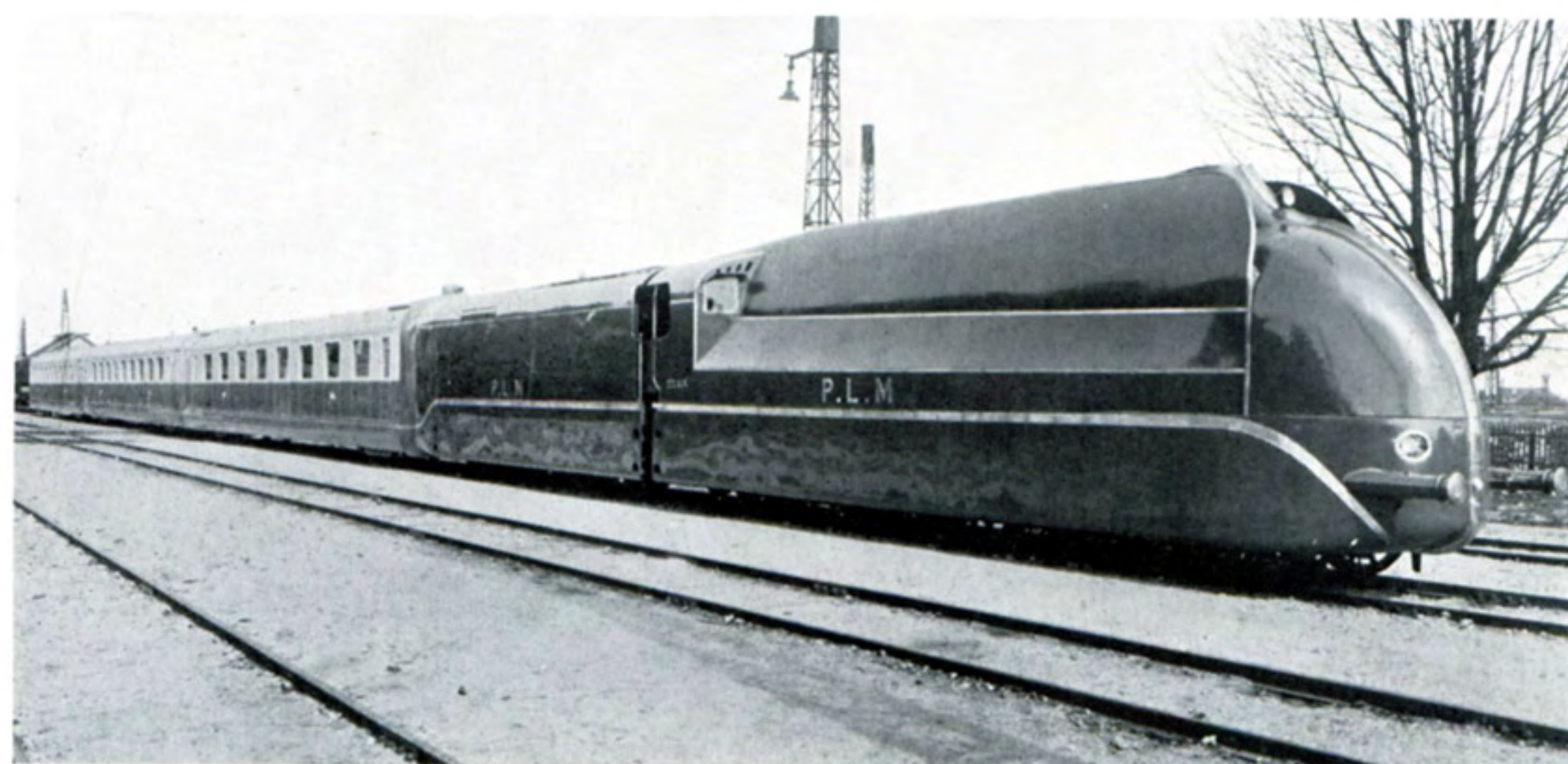
Fig. 113 CHEMINS DE FER DU P.-L.-M., FRANCE Train aérodynamique. Voitures à voyageurs. — 8 boîtes d'essieux par voiture, comportant chacune 2 roulements I-37906. Charge maximum par boîte 6 tonnes. Vitesse : 140 kilomètres à l'heure.
