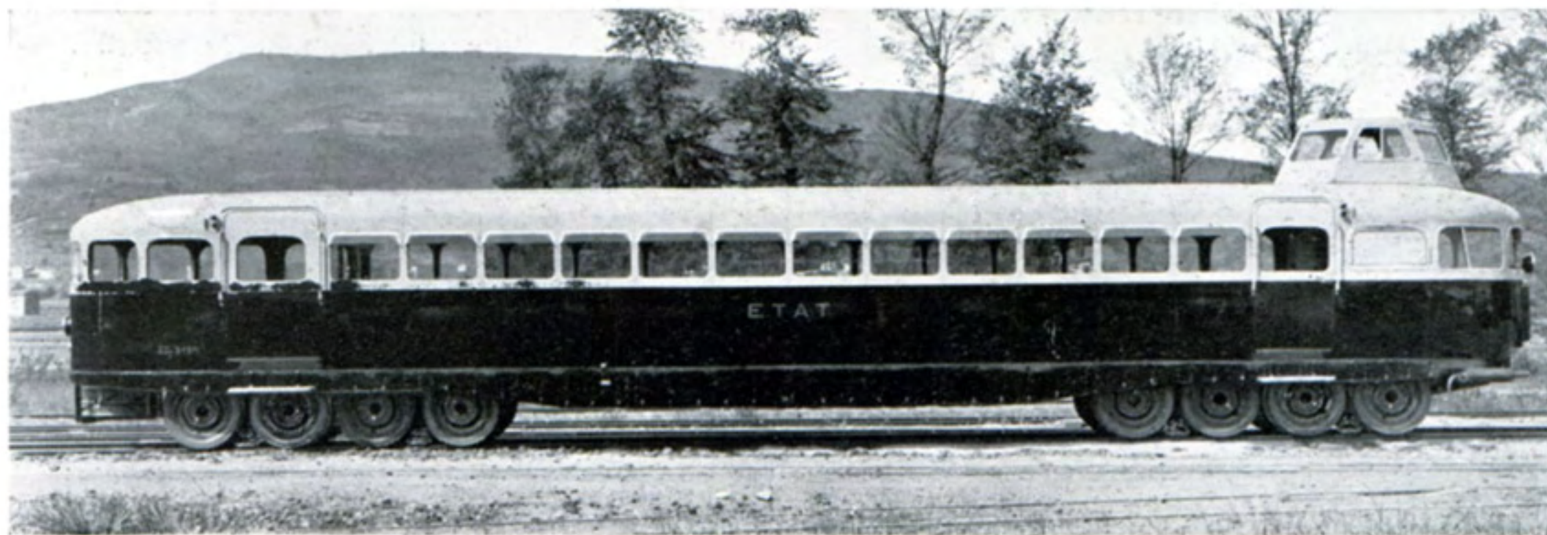
Fig. 169 CHEMINS DE FER FRANÇAIS. Autorail Michelin 56 places. 110 kilomètres à l'heure. Roues montées sur roulements à rouleaux SKF 32215. — Voir fig. 87.
