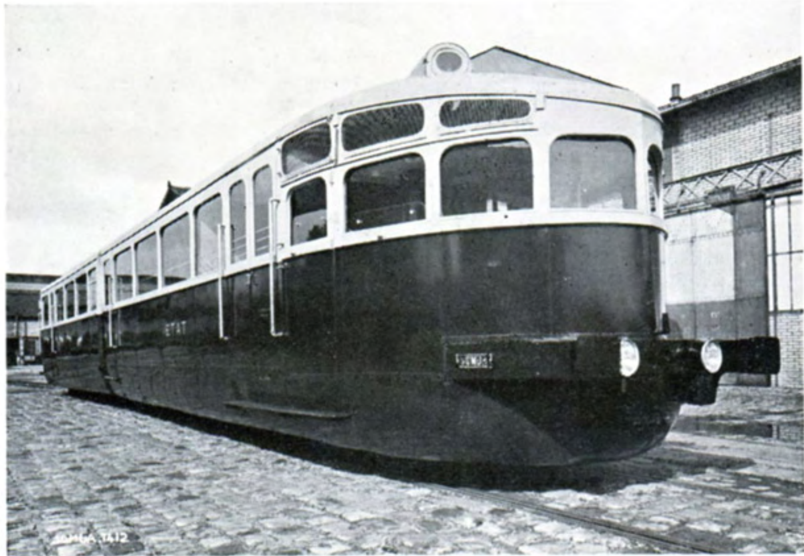
Fig. 172 CHEMINS DE FER DE L'ETAT, FRANCE. Autorail articulé Diesel 210 CV., construit par S.O.M. U.A. — Roues montées chacune sur 1 roulement 22222 et 1 roulement à rouleaux cylindriques. Vitesse maximum 100 kilomètres à l'heure.
