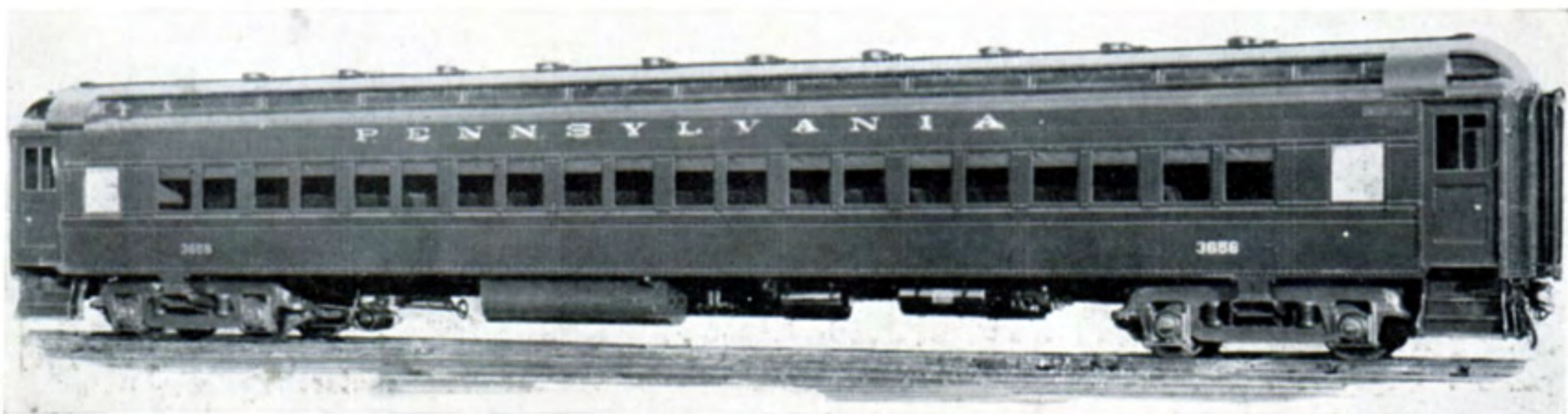
Fig. 106 PENNSYLVANIA RAILROAD, ETATS-UNIS. Voiture à voyageurs. — 8 boîtes d'essieux par voiture, comportant chacune 1 roulement I-31069 (fig. 9). Charge maximum par boîte 7,5 tonnes.
