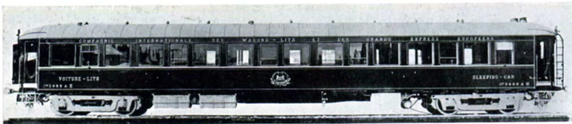
Fig. 99 COMPAGNIE INTERNATIONALE DES WAGONS-LITS. CHEMINS DE FER DU P.-L.-M., FRANCE. Wagon-lit du Train bleu. — 8 boîtes d'essieux par voiture, comportant chacune 2 roulements I-37906 (fig. 6). Charge maximum par boîte 6 tonnes.
