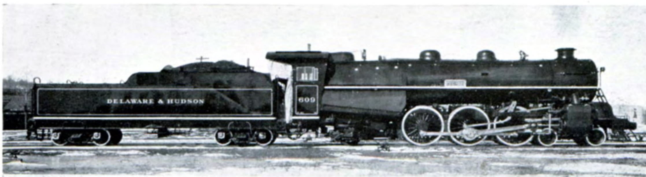
Fig. 177 DELAWARE & HUDSON RAILROAD, ETATS-UNIS. Essieux moteurs : 1 roulement I-26315 spécial par boîte. Charge statique par boîte 14,5 tonnes. — Têtes de bielles motrices montées sur 1 roulement I-37611 spécial. — Bielles d'accouplement montées sur 1 roulement I-26311 spécial à chaque maneton. — Voir fig. 83 et 84.
