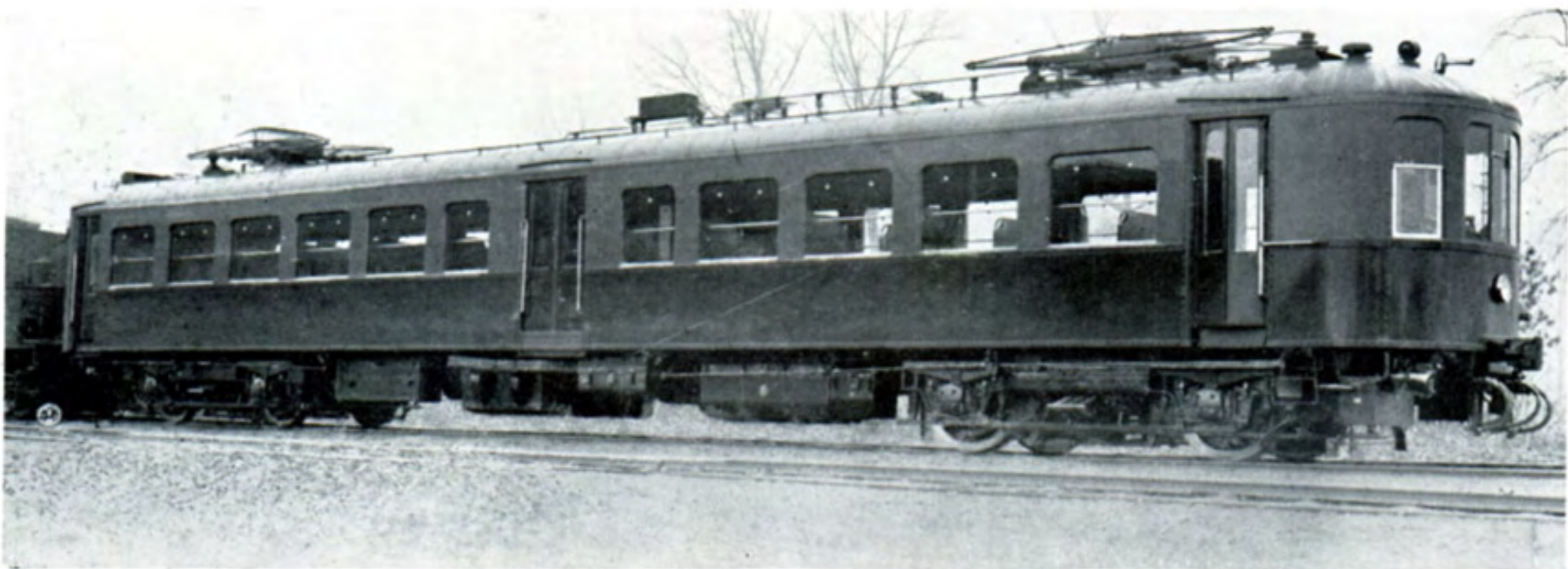
Fig. 137 SOCIÉTÉ NATIONALE DES CHEMINS DE FER BELGES. Automotrices électriques construites par Les Ateliers Métallurgiques à Nivelles et Les Ateliers de la Dyle à Louvain. — 8 boîtes d'essieux par véhicule, comportant chacune 2 roulements 1-61190 (fig. 3). Charge maximum par boîte 8,75 tonnes. Vitesse maximum 130 kilomètres à l'heure.
