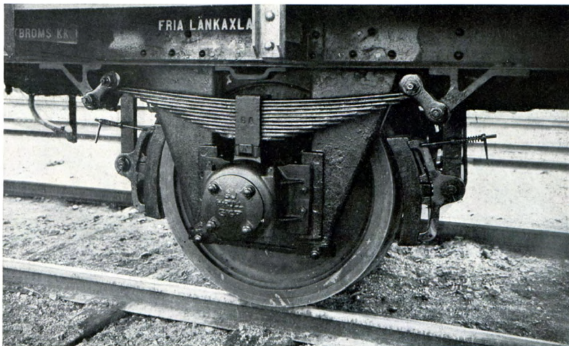
Fig. 51 CHEMINS DE FER DE L'ETAT SUEDOIS. Essieu pour wagon à marchandises. — 4 boîtes d'essieux par wagon, comportant chacune 2 roulements I-35156 (fig. 3). Charge maximum par boîte 6,4 tonnes. — Voir fig. 115.
