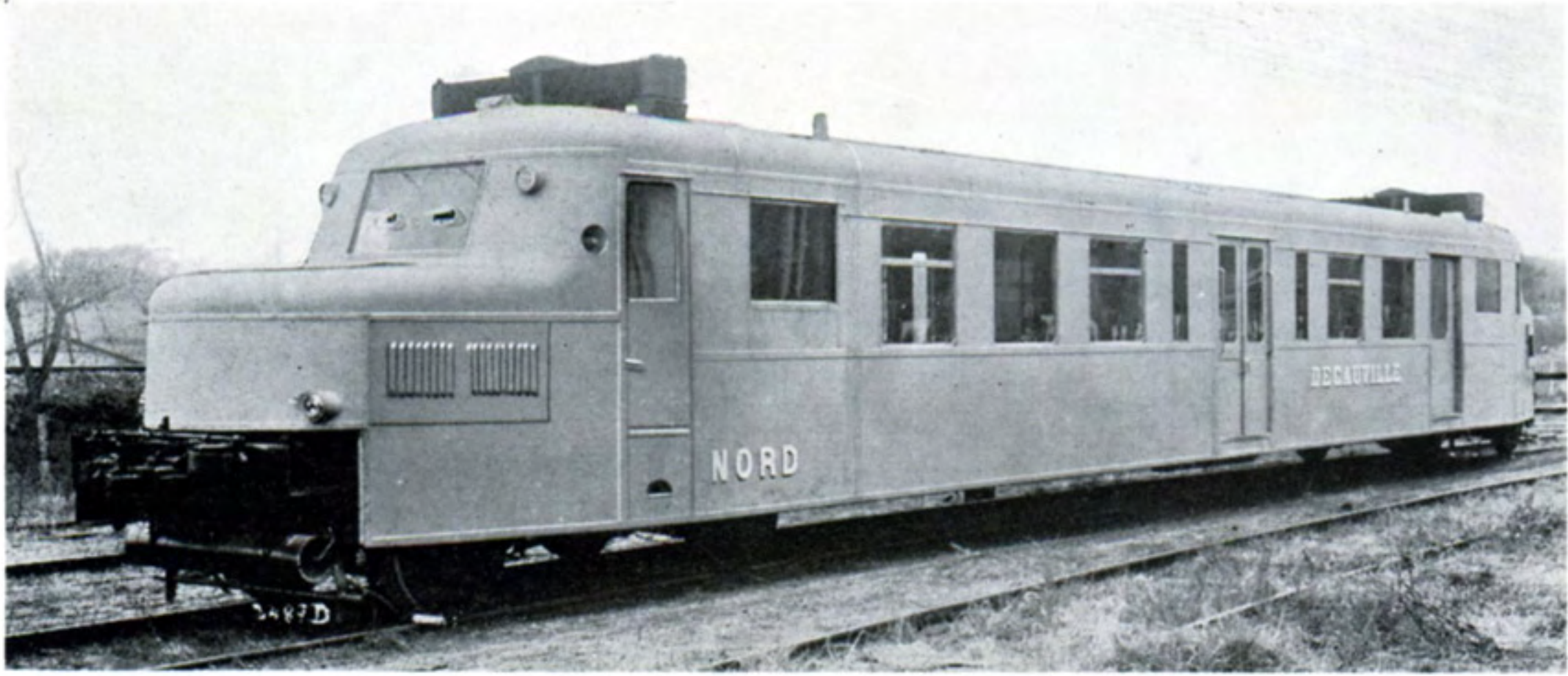
Fig. 171 CHEMIN DE FER DU NORD, FRANCE. Autorail Diesel 260 CV., construit par la Société Nouvelle des Etablissements Decauville Aîné. Essieux porteurs : roues folles montées sur roulements à rouleaux SKF. Essieux moteurs montés sur 2 roulements à rotule sur double rangée de rouleaux SKF. Vitesse 100 kilomètres à l'heure.
