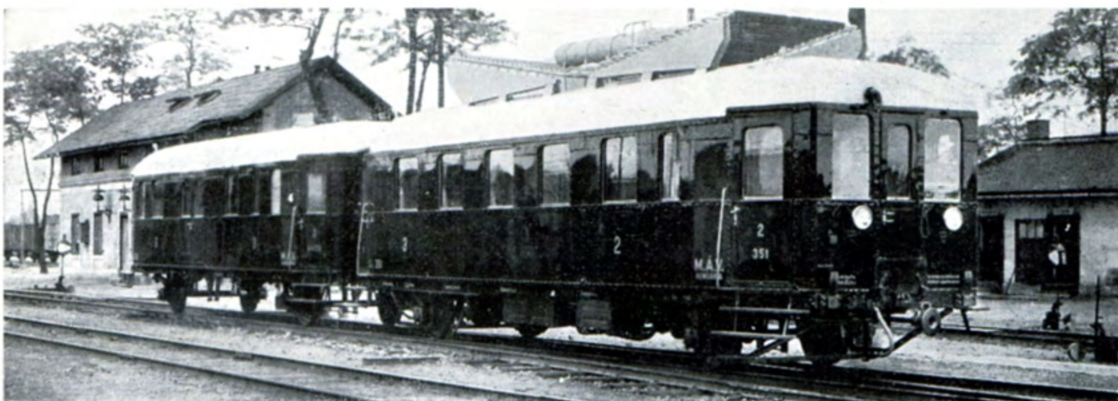
Fig. 150 CHEMINS DE FER DE L'ETAT HONGROIS. Autorail à moteur à essence, 50 CV., avec remorque. — 4 boîtes d'essieux par véhicule, comportant chacune 2 roulements 22314 K (fig. 3). Charge maximum par boîte 3 tonnes.
