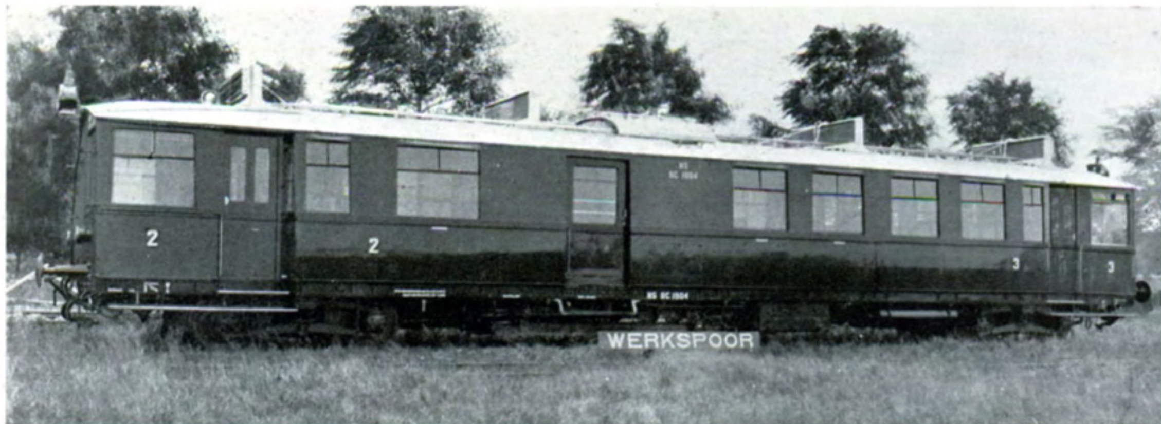
Fig. 153 CHEMINS DE FER DE L'ETAT HOLLANDAIS. Autorail Diesel — 8 boîtes d'essieux par véhicule, comportant chacune 2 roulements I-35156. Charge maximum par boîte 5 tonnes.
