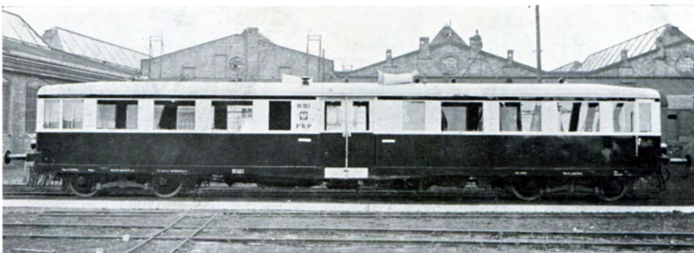
Fig. 152 CHEMINS DE FER DE L'ETAT POLONAIS. Autorail Diesel, 2 \times 100 CV. — 8 boîtes d'essieux par véhicule, comportant chacune 2 roulements 22322 K. Charge maximum par boîte 4,75 tonnes. — Bogie suivant fig. 52.
