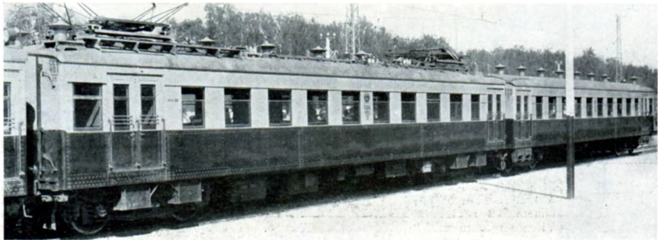
Fig. 136 CHEMIN DE FER DU NORD, U. R. S. S. Automotrice électrique avec remorque. — 8 boîtes d'essieux par véhicule, comportant chacune 2 roulements 22324 K (fig. 3). Charge maximum par boîte 6,4 tonnes. — Bogie suivant fig. 48.
